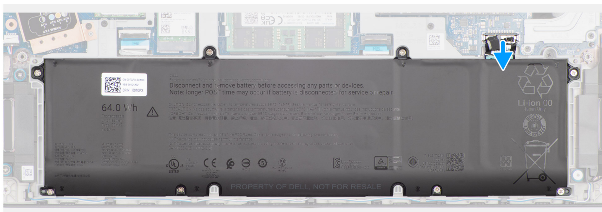
Figura 14. Rimozione del cavo della batteria
