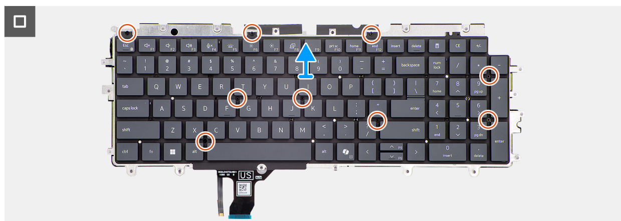
Figura 99. Rimozione della tastiera
