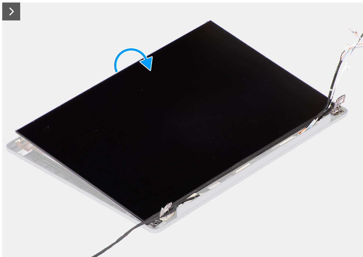
Figura 69. Rimozione del pannello del display
