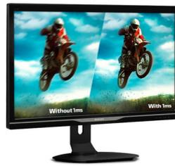
SmartResponse представляет собой эксклюзивную технологию ускорения от Philips, которая при включении автоматически настраивает время отклика в соответствии с определенными требованиями приложений, например игр и фильмов, для которых необходимо более быстрое время отклика для создания изображений без дрожания, запаздывания, а также без остаточного изображения
