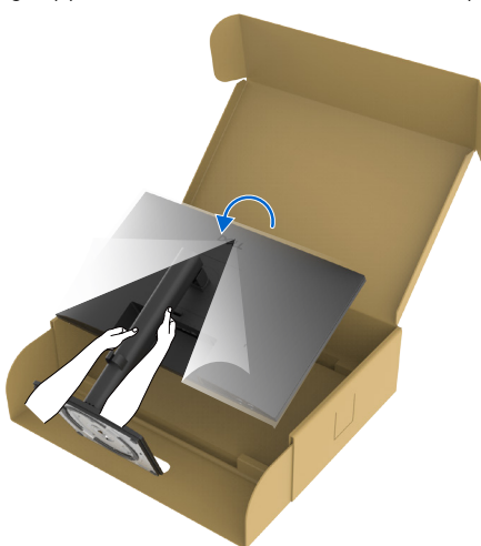
Figur 20. Håll i höjdledsjusteringen och lyft bildskärmen
