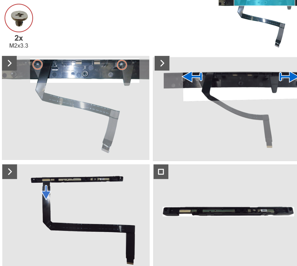
Figure 27. Retrait du module caméra
