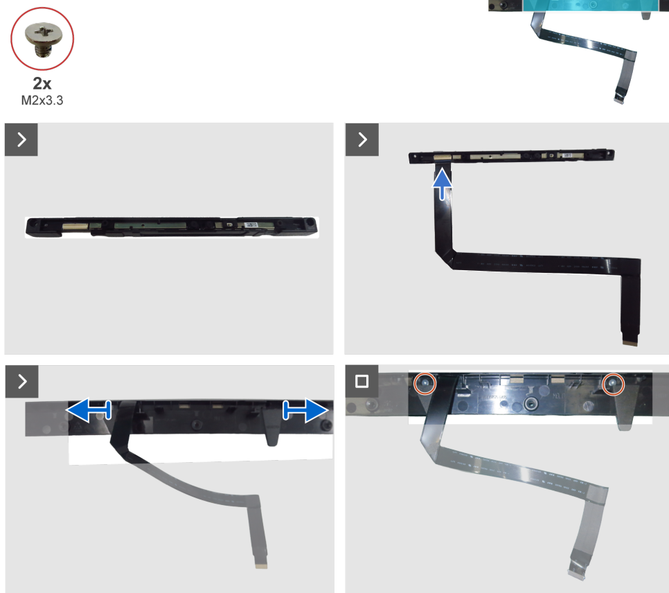
Figure 28. Installation du module caméra
