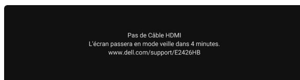
Figure 47. Message d'avertissement de câble HDMI débranché
