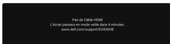
Figure 70. Message d'avertissement de câble HDMI débranché
