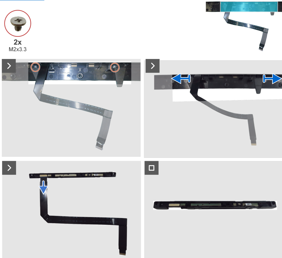
Figura 17. Desmontaje del módulo de la cámara
