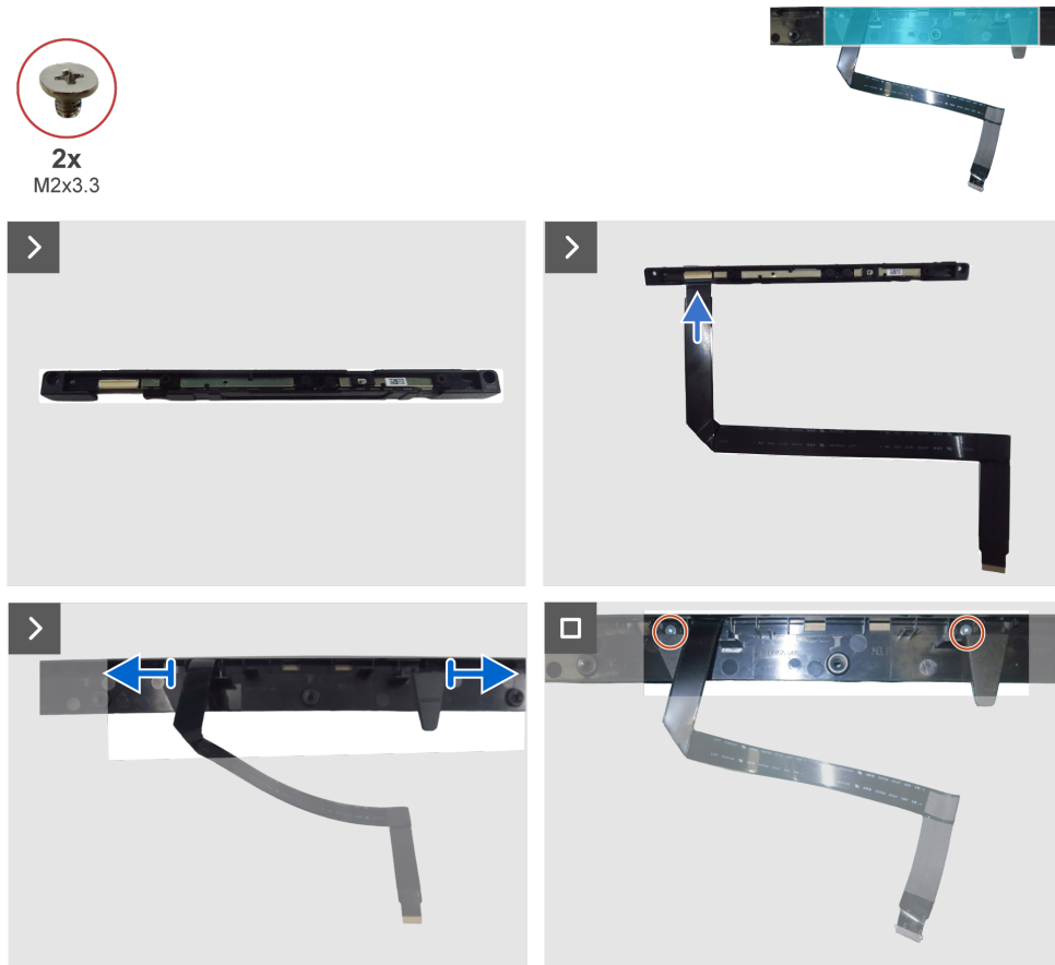
Figura 18. Instalación del módulo de cámara
