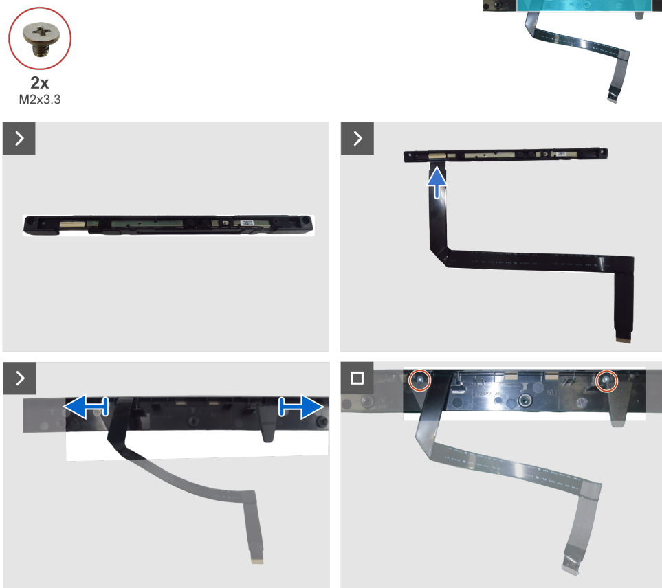
Figure 18. Installation du module caméra
