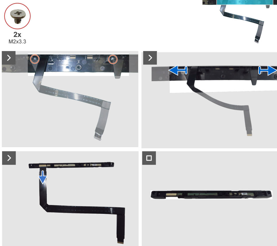
Figure 17. Retrait du module caméra
