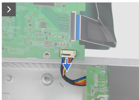
Figura 29. Desmontaje de la placa base
