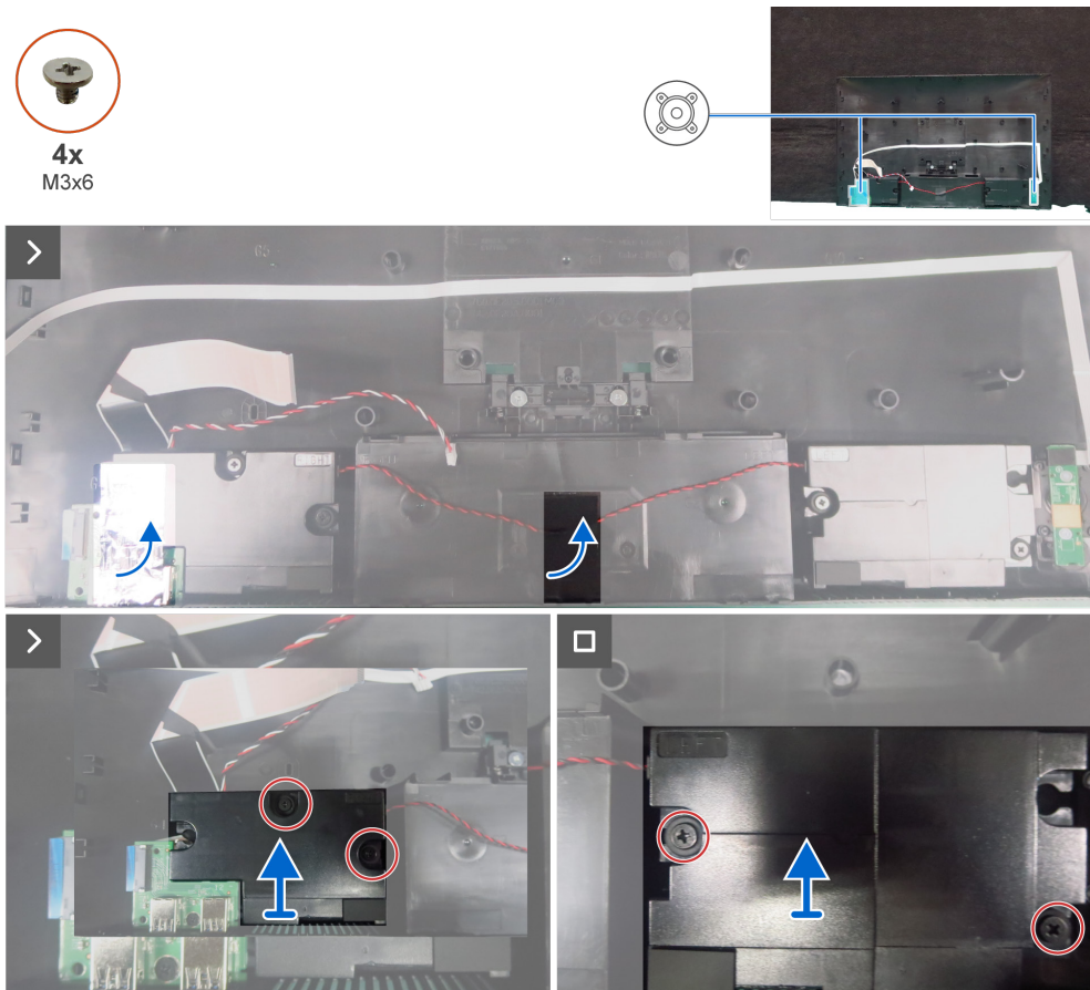
Figura 15. Desmontaje de los altavoces
