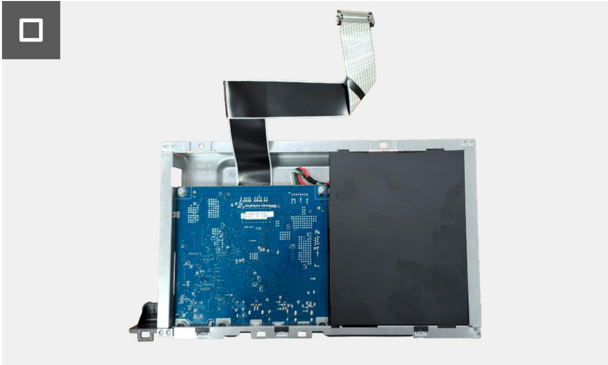
Figure 20. Retirer le blindage métallique
