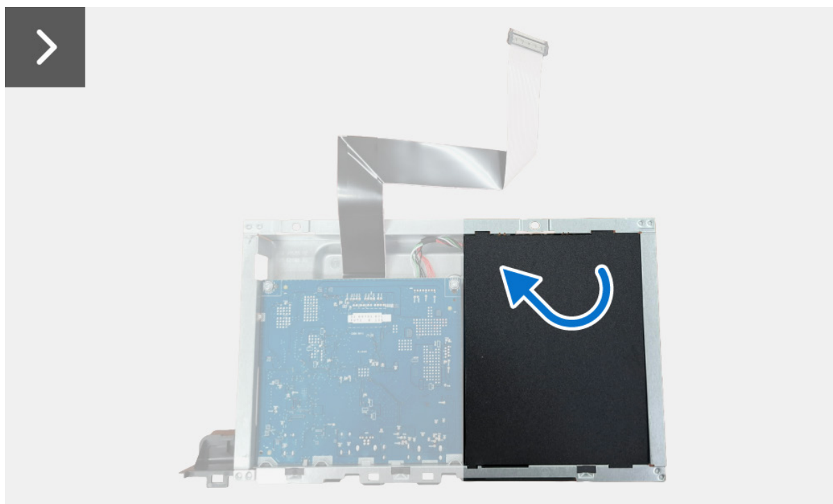
Figure 25. Retirer la carte d'alimentation
