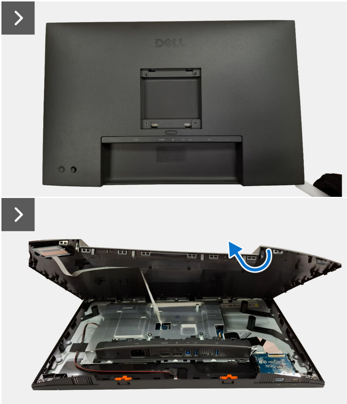
Figure 13. Retirer le couvercle arrière
