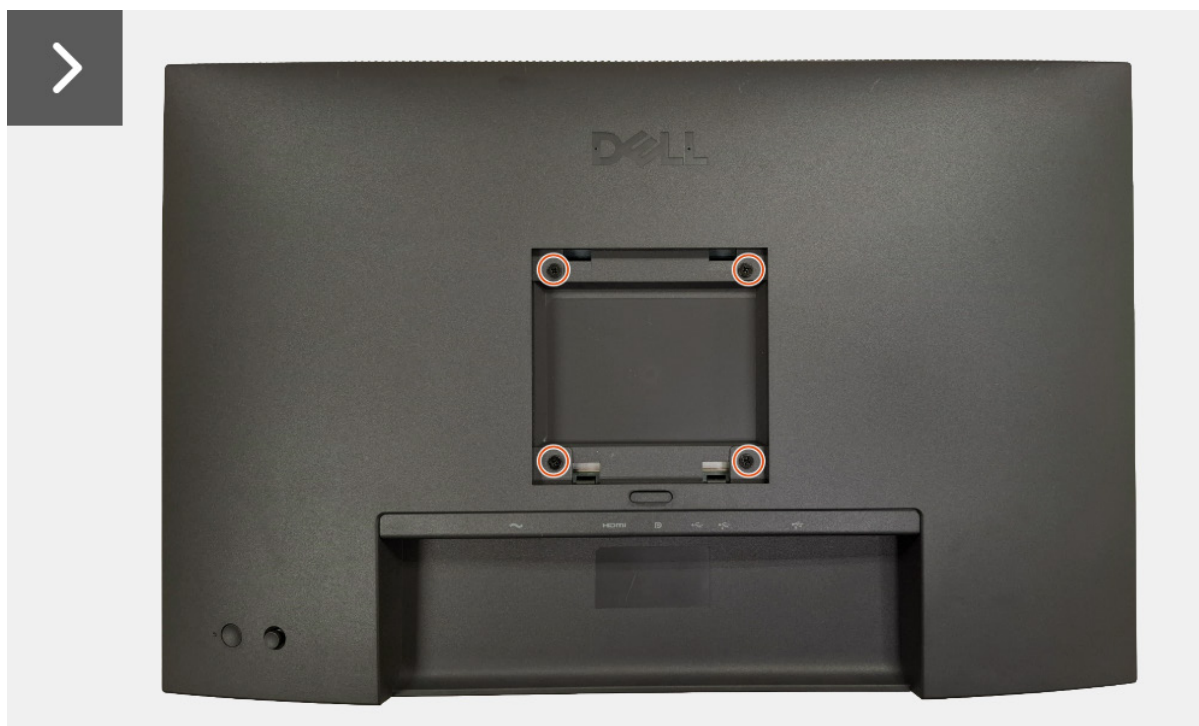
Figure 12. Retirer le couvercle arrière
