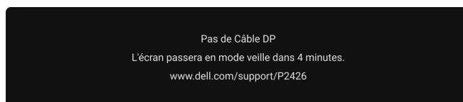
Figure 80. Message d'avertissement de câble de signal déconnecté
