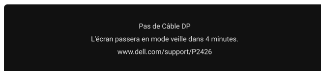
Figure 76. Message d'avertissement de câble de signal déconnecté
