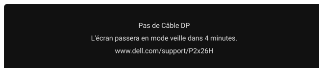
Figure 79. Message d'avertissement de câble de signal déconnecté
