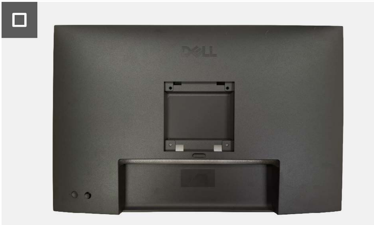
Figure 5. Retirer le couvercle arrière
