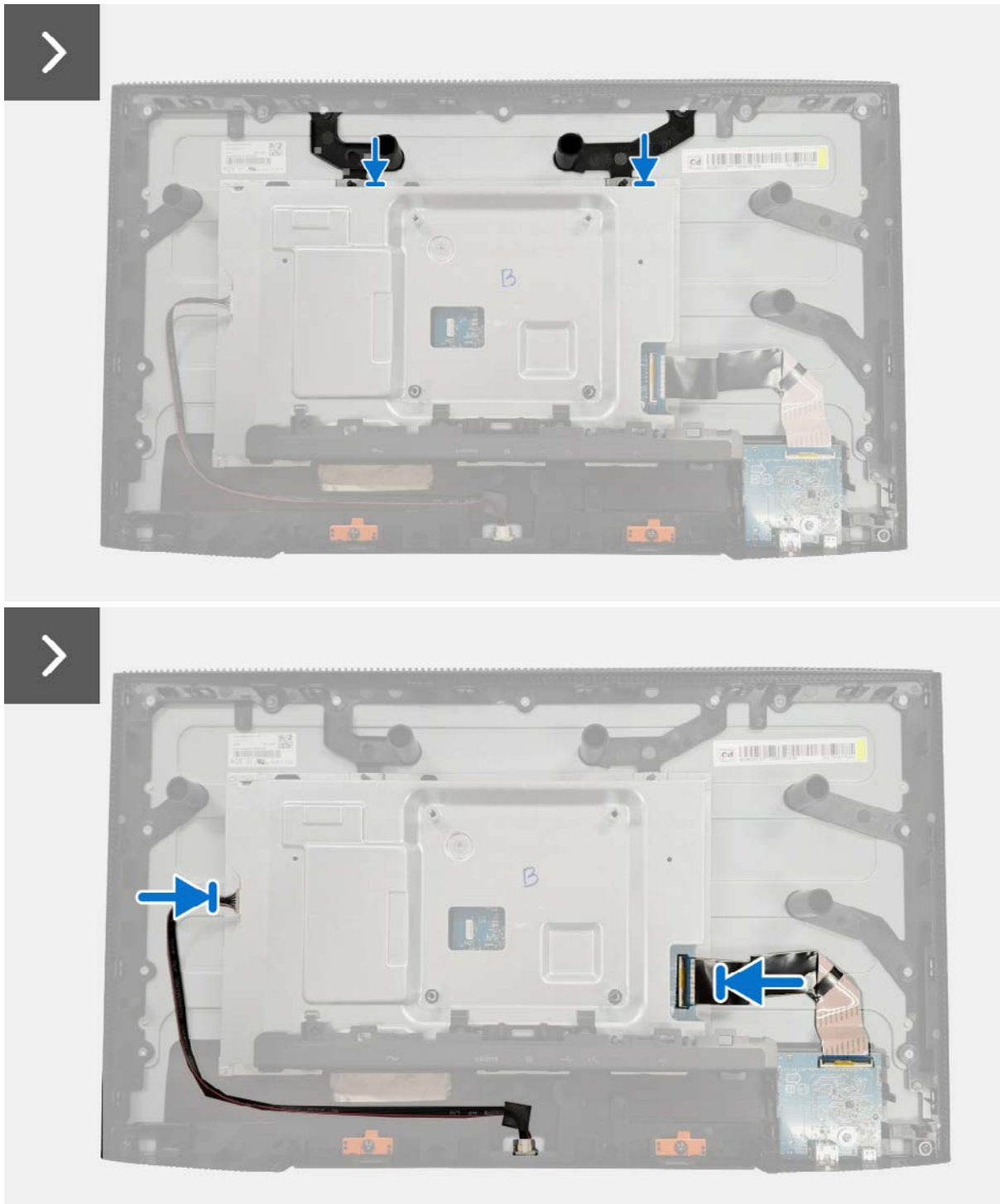
Figure 14. Installer le blindage métallique
