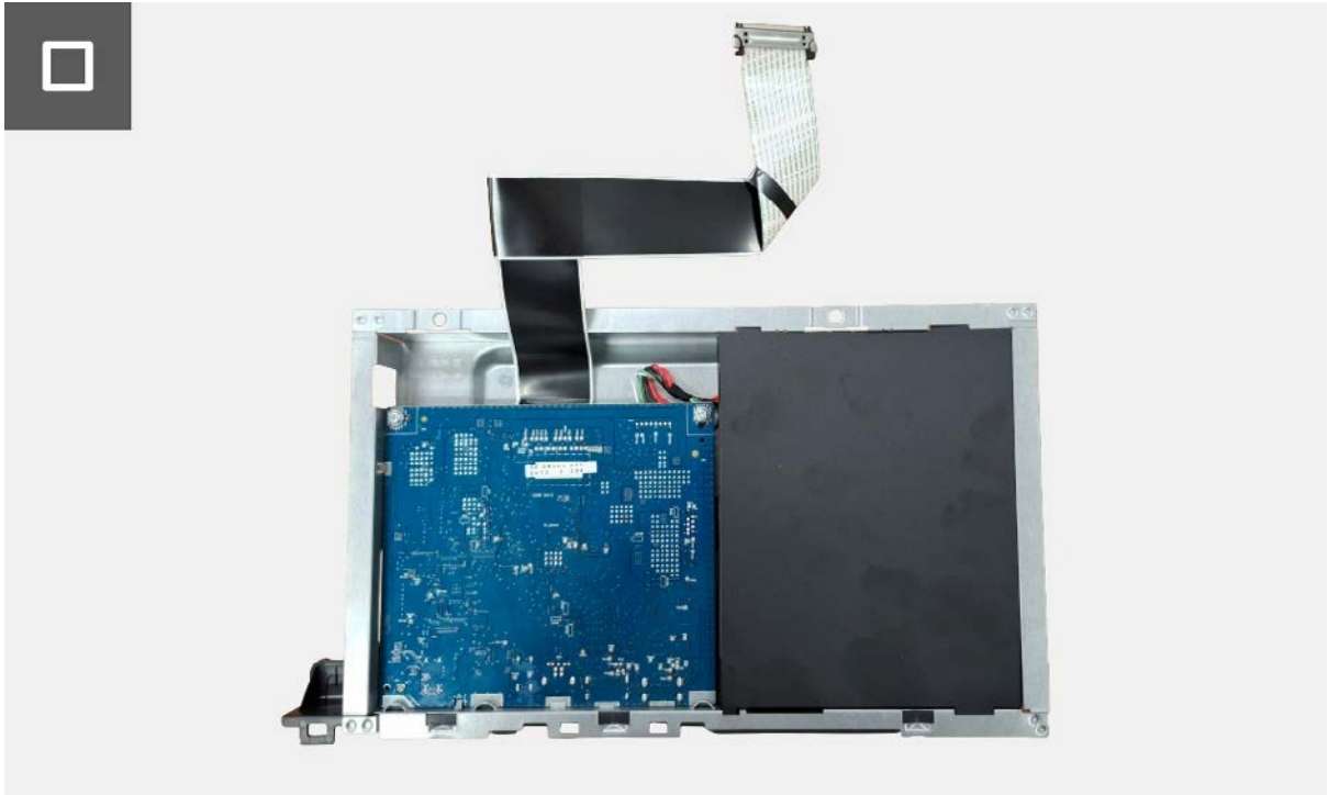
Figure 11. Retirer le blindage métallique
