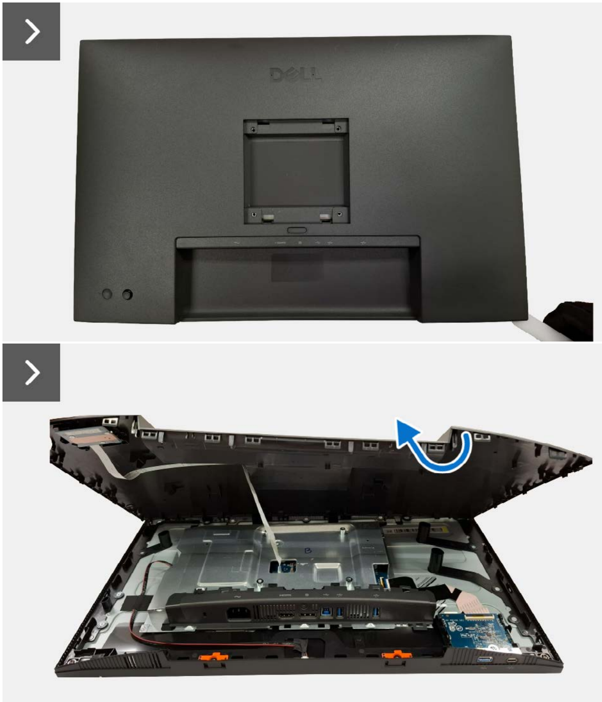
Figure 4. Retirer le couvercle arrière
