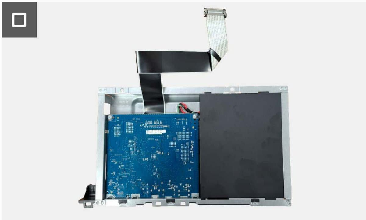
Rysunek 11. Demontaż metalowej osłony
