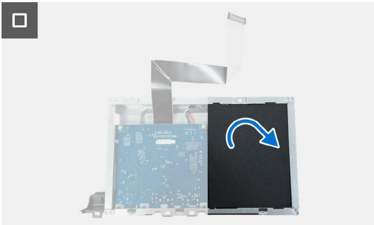
Rysunek 21. Montaż płytki zasilania
