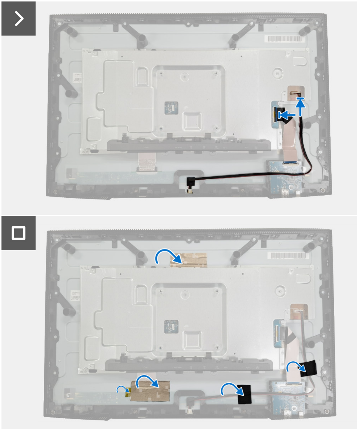
Figura 26. Instalar el protector metálico
