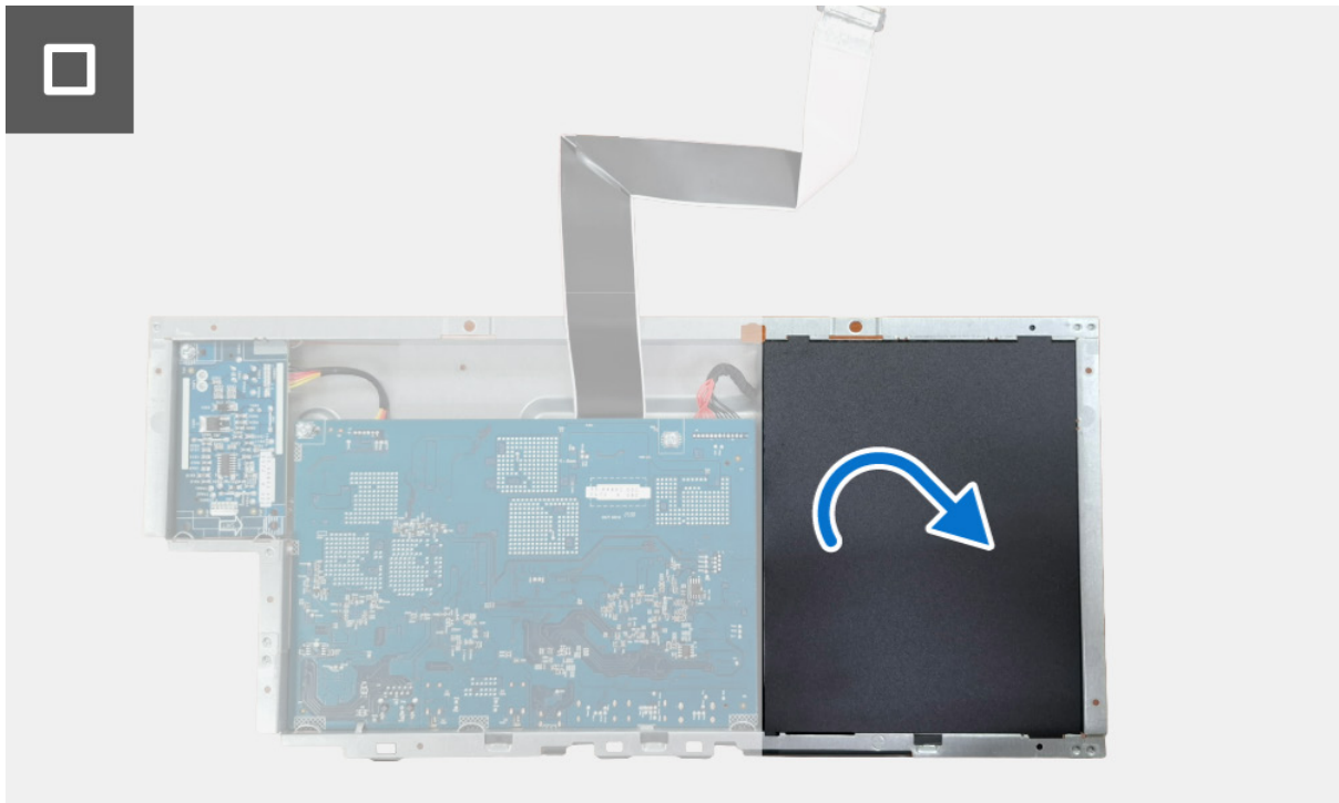
Figura 32. Instalar la placa de control LED
