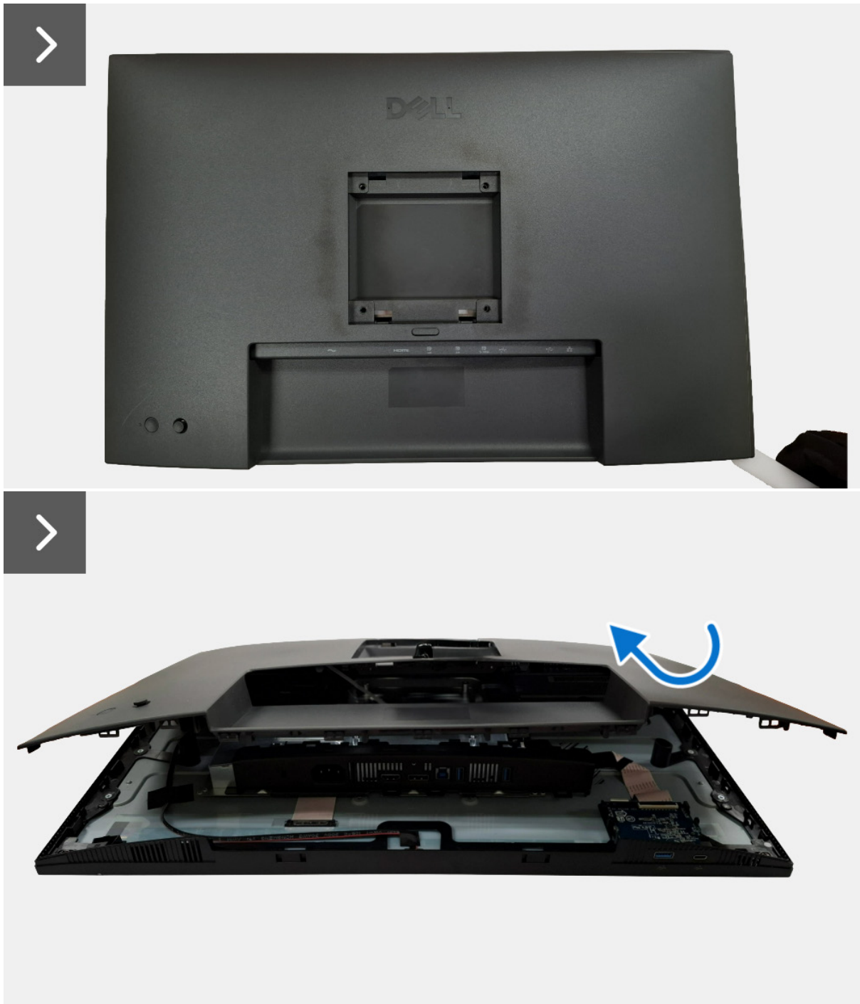
Figura 17. Retirar la cubierta posterior
