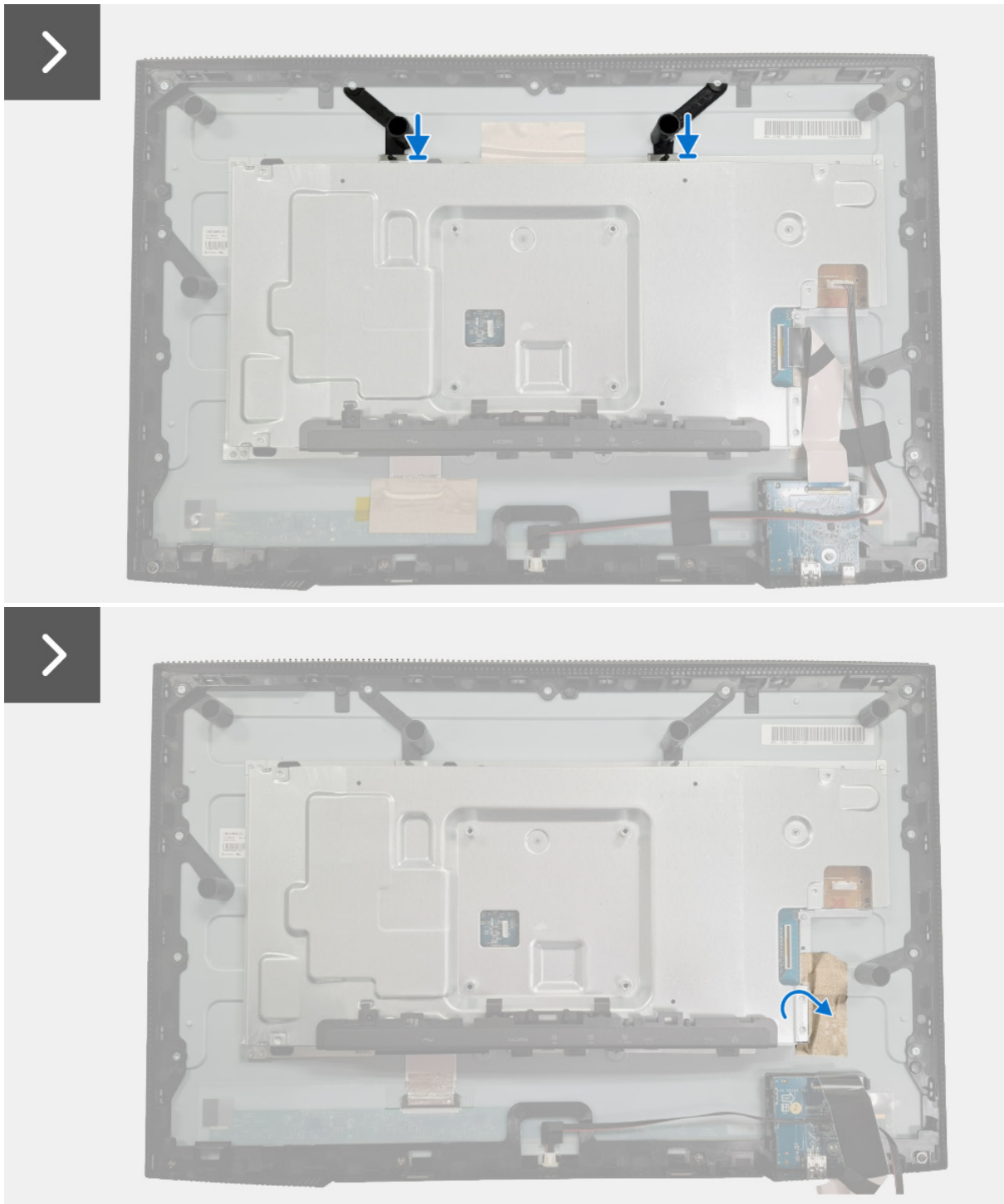
Figura 25. Instalar el protector metálico
