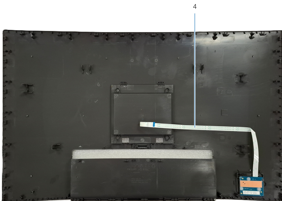
Figura 7. Conectividad de cables en la cubierta posterior de la pantalla
