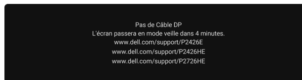
Figure 81. Message d'avertissement de câble DP débranché
