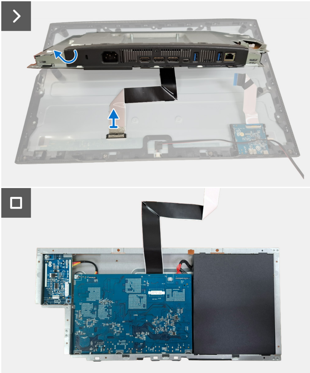
Figure 10. Retirer le blindage métallique
