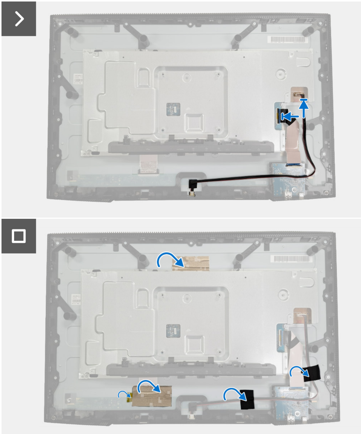
Figure 13. Installer le blindage métallique
