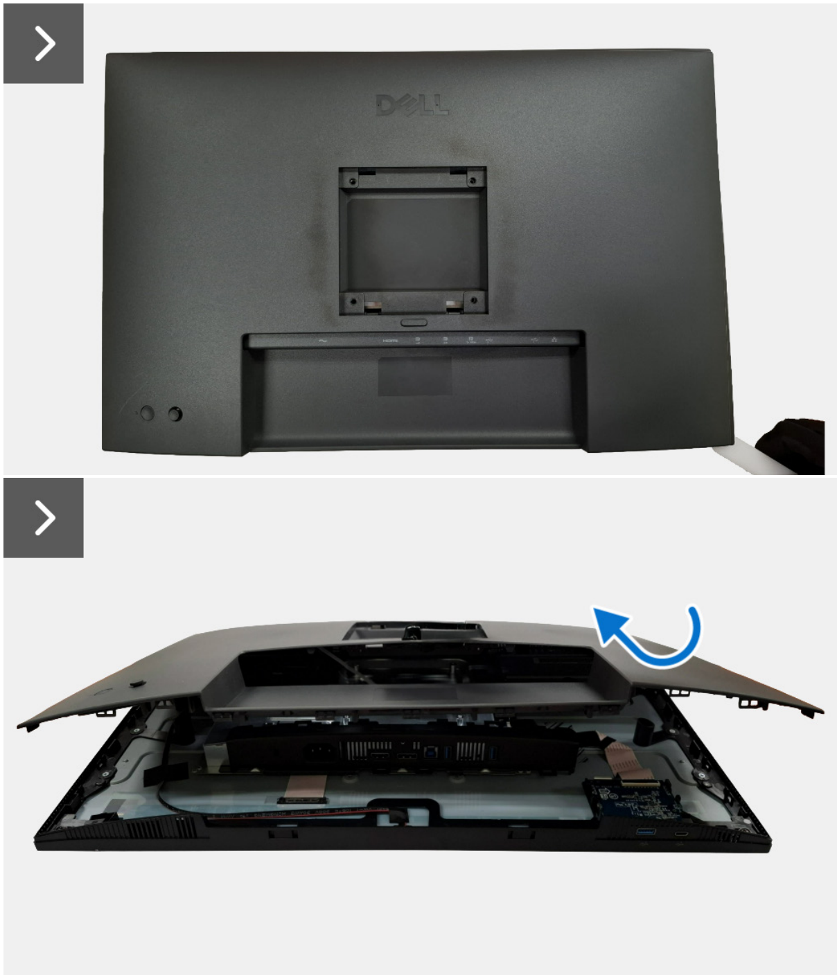
Figure 17. Retirer le couvercle arrière
