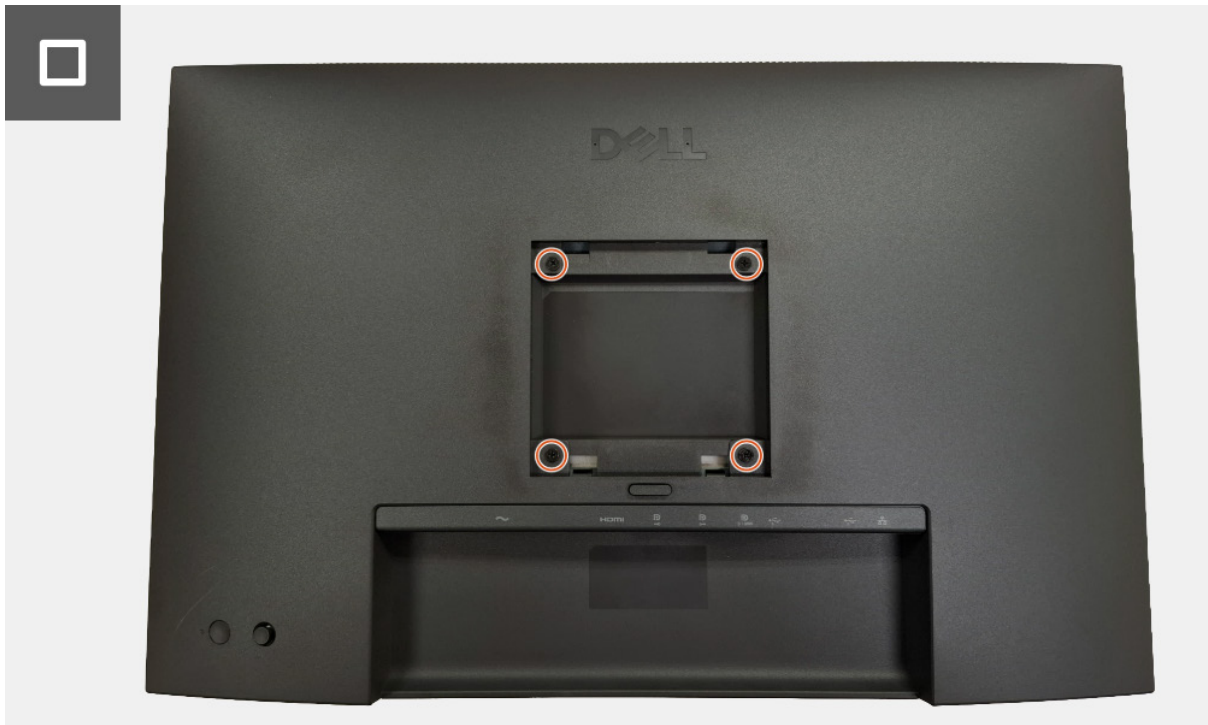
Figure 20. Installer le couvercle arrière supérieur
