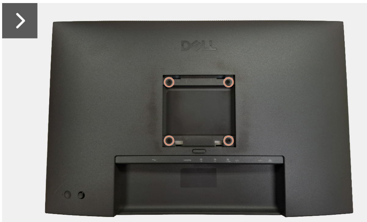
Rysunek 16. Demontaż tylnej pokrywy
