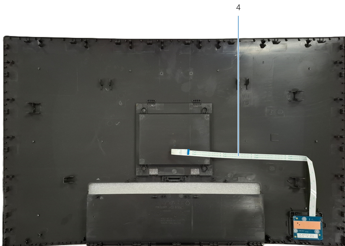
Rysunek 7. Połączenia kablowe na tylnej pokrywie wyświetlacza
