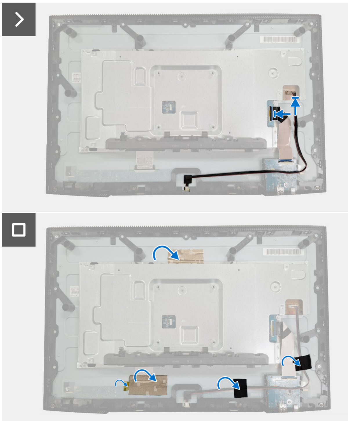
Rysunek 26. Montaż metalowej osłony
