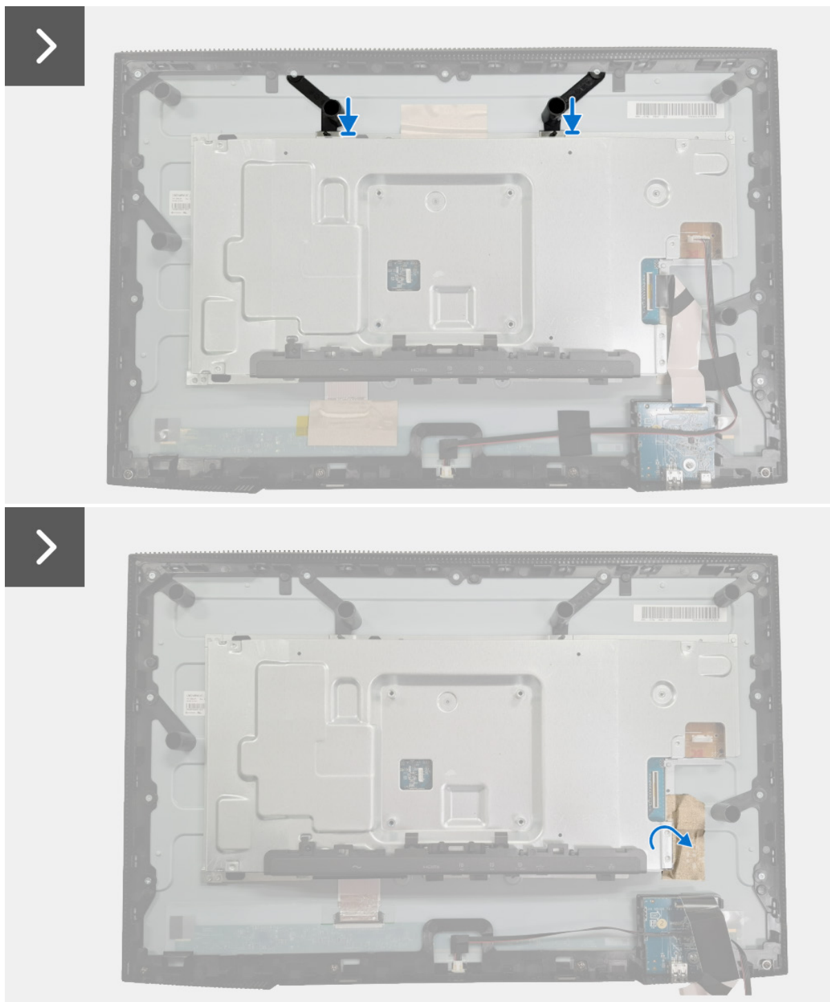
Rysunek 25. Montaż metalowej osłony
