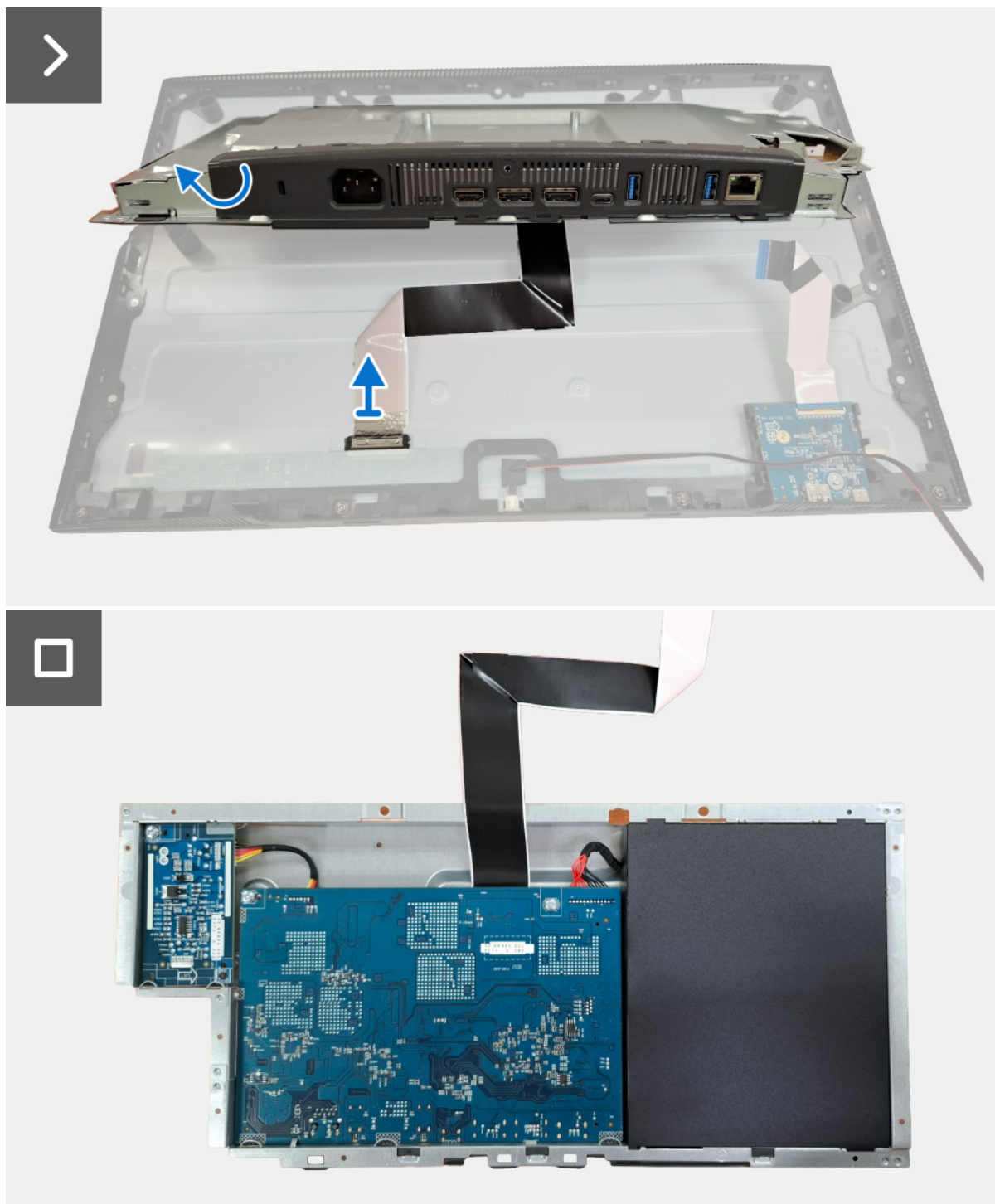
Rysunek 23. Demontaż metalowej osłony
