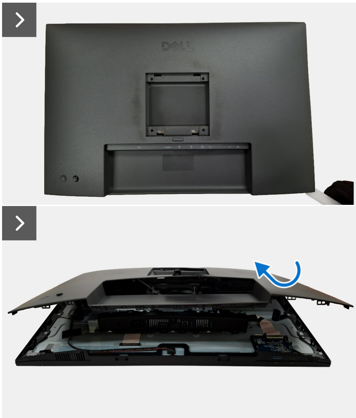
Rysunek 17. Demontaż tylnej pokrywy
