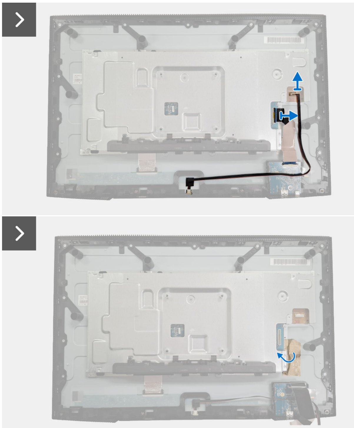
Rysunek 22. Demontaż metalowej osłony
