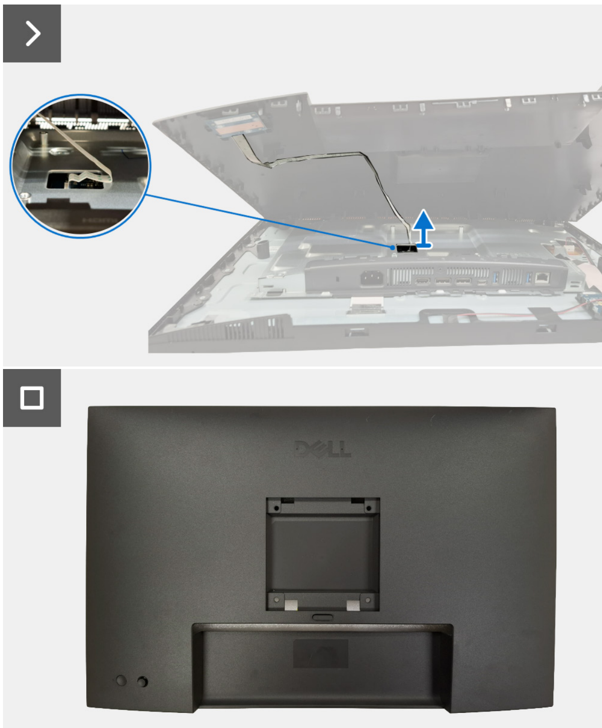
Rysunek 18. Demontaż tylnej pokrywy
