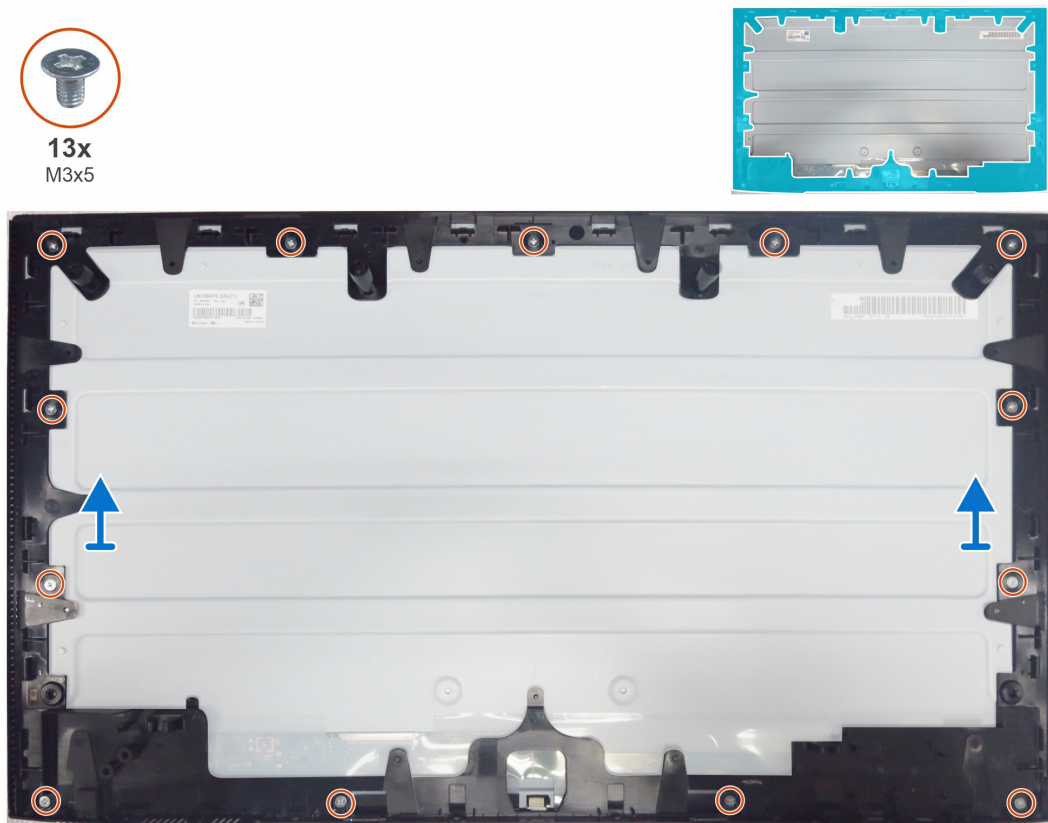
Figure 24. Retrait du cadre intermédiaire
