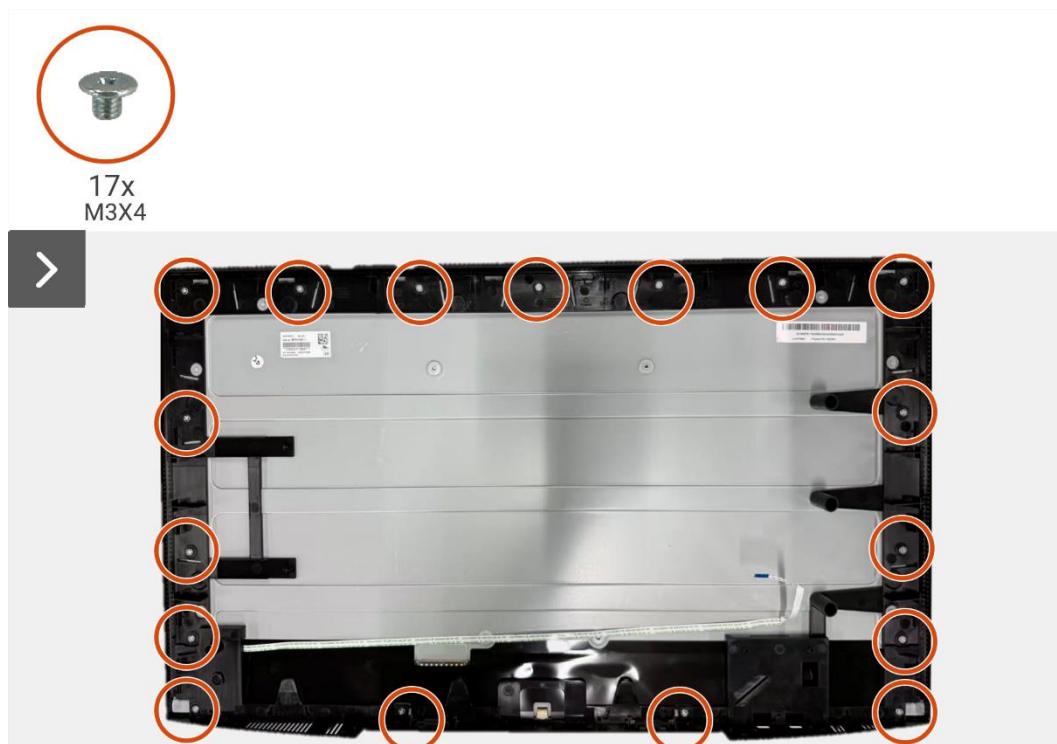
Figura 27. Desmontaje la placa LED
