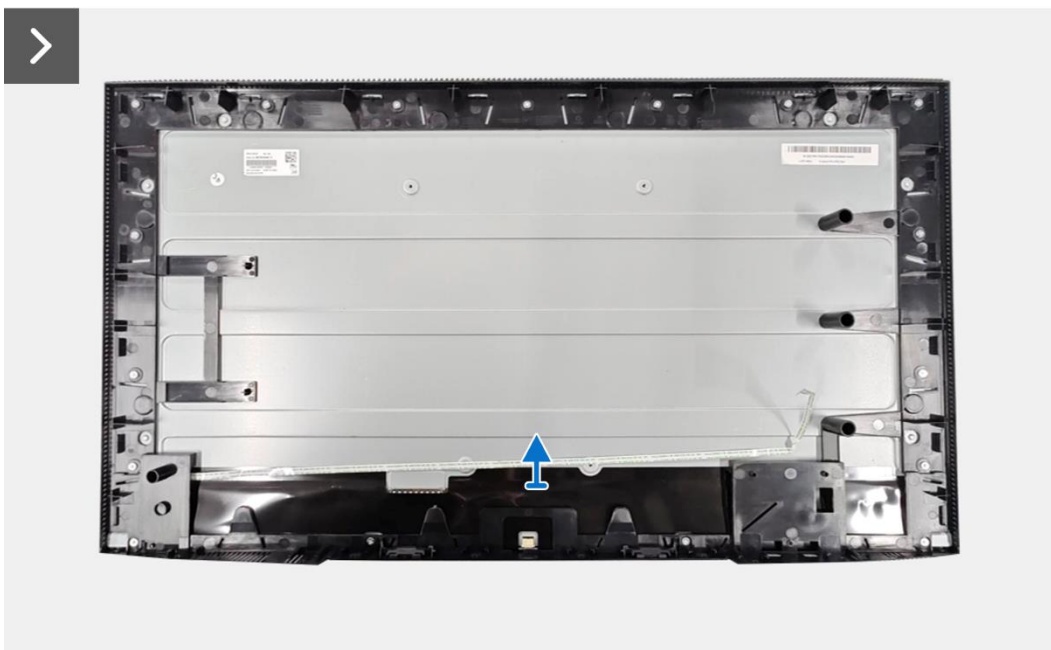
Figura 28. Desmontaje la placa LED
