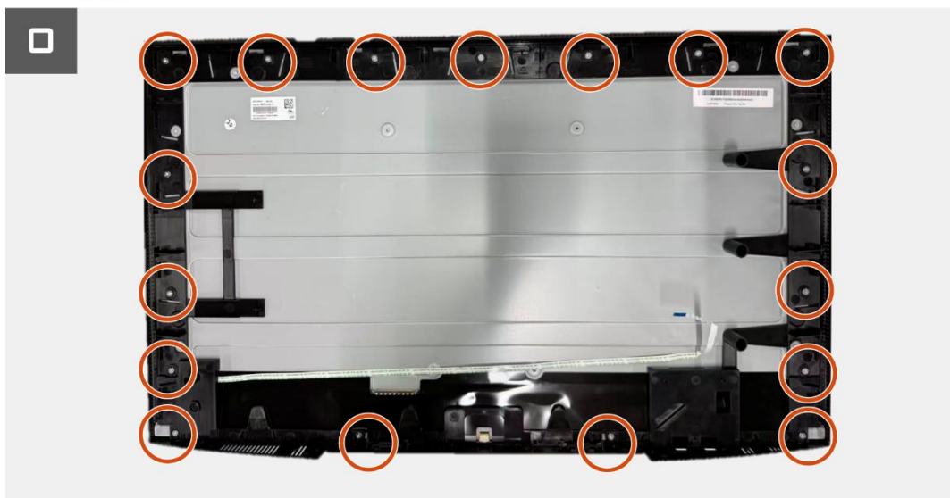
Figura 31. Instalación de la placa LED
