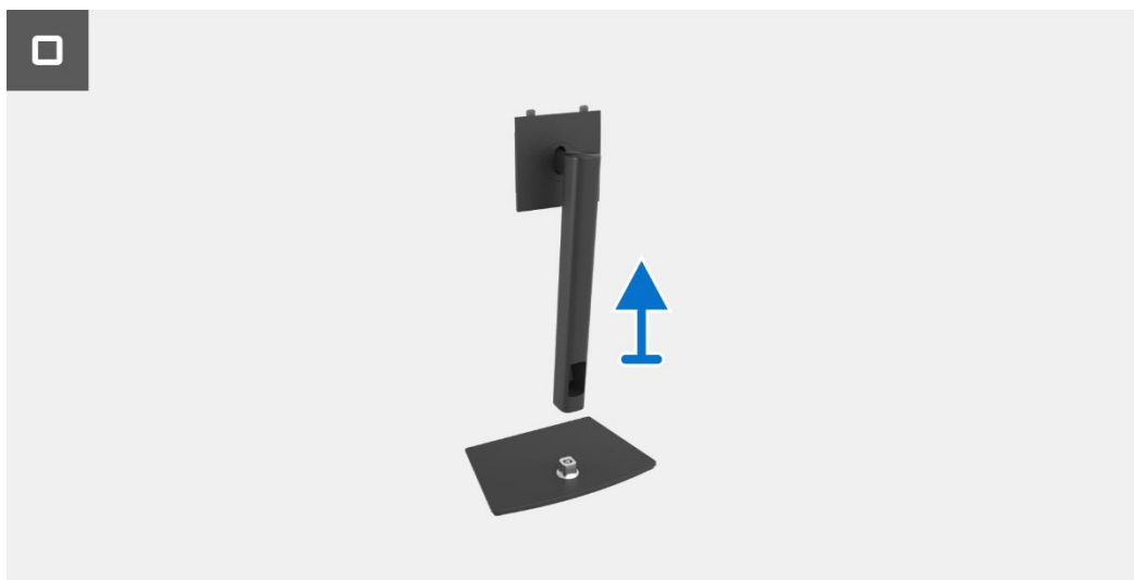
Figura 2. Desmontaje del soporte
