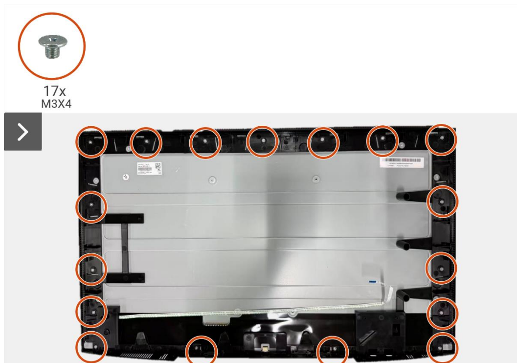
Figura 39. Desmontaje la placa LED
