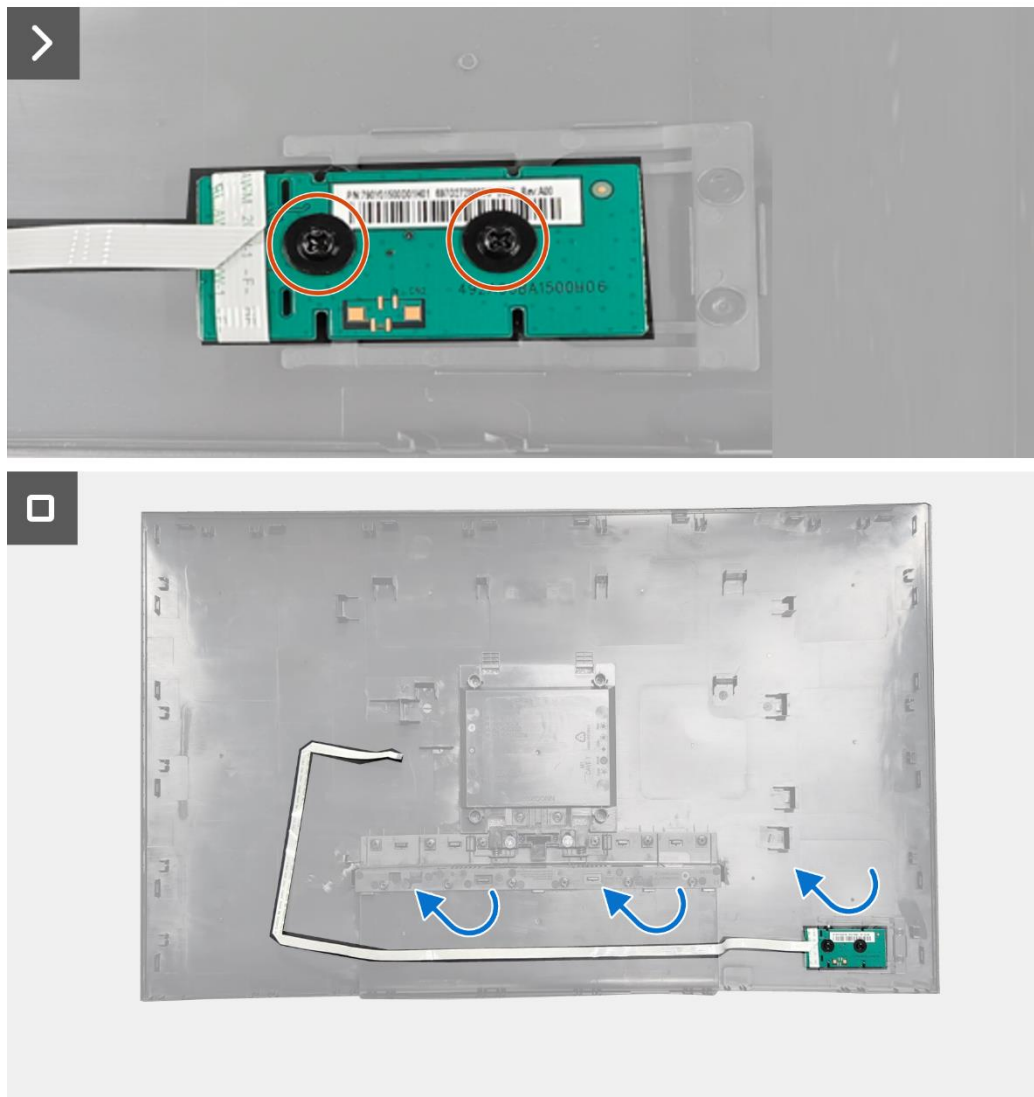
Figura 21. Desmontaje de la placa del teclado
