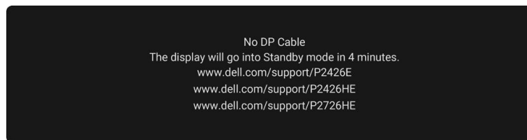
Figura 44. Mensaje de advertencia de cable DisplayPort desconectado
