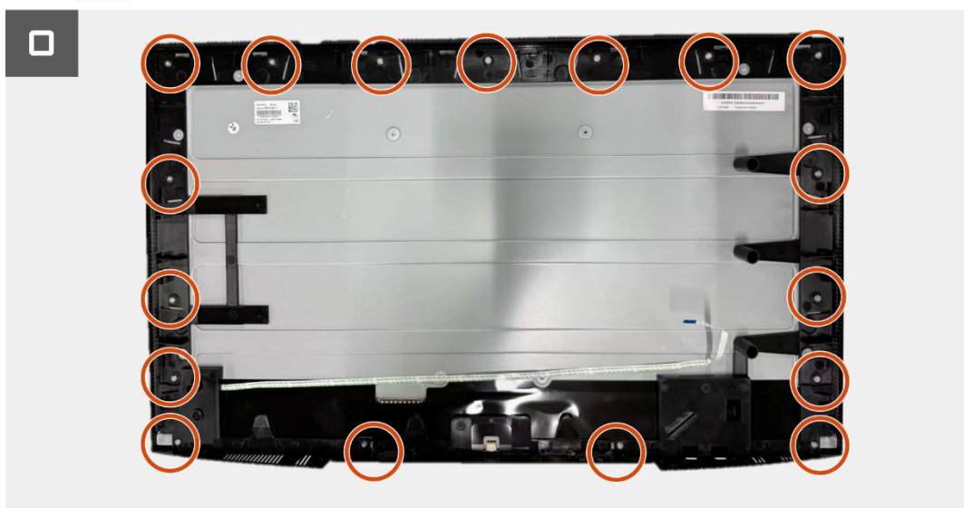
Figura 43. Instalación de la placa LED
