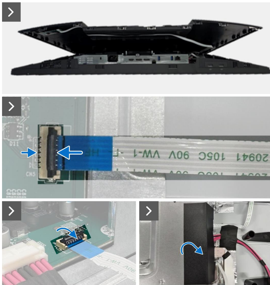
Figure 7. Installation du couvercle arrière
