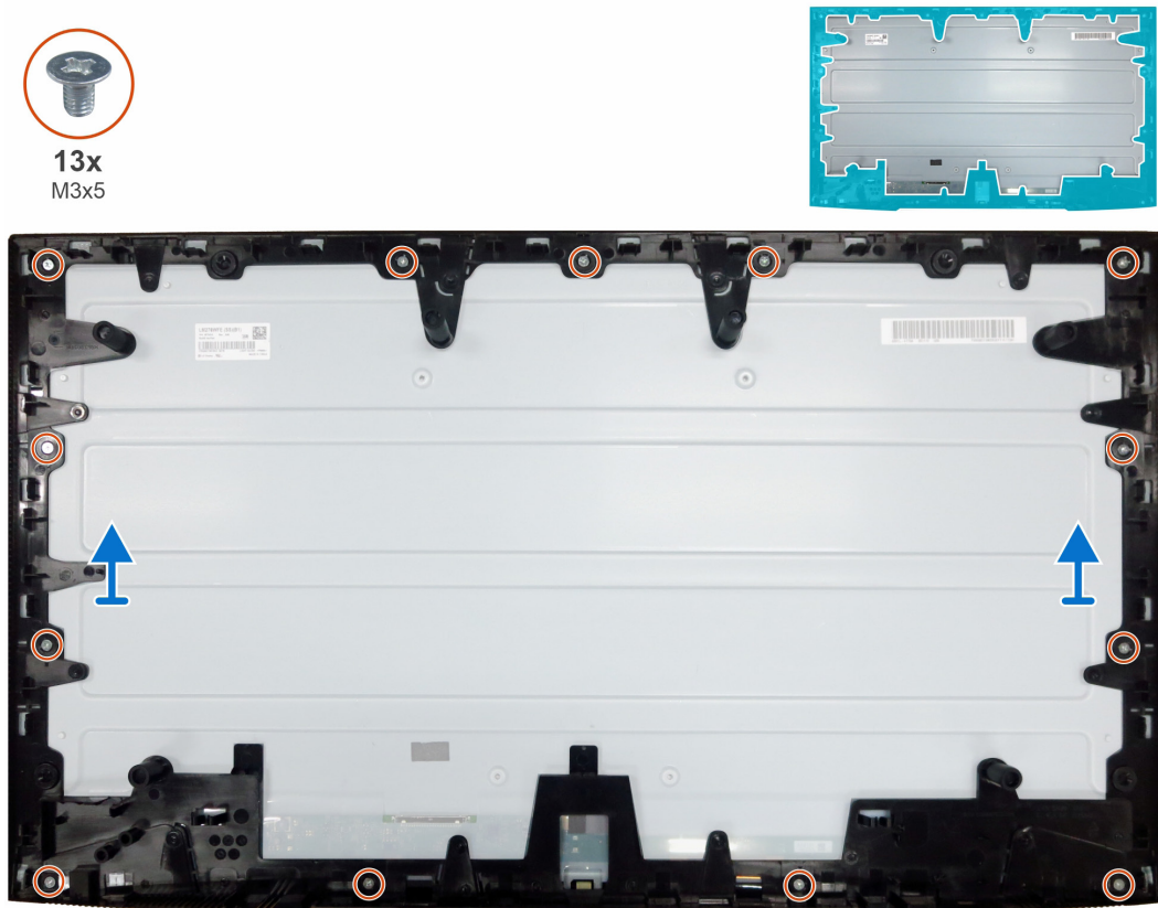
Figure 13. Retrait du cadre intermédiaire
