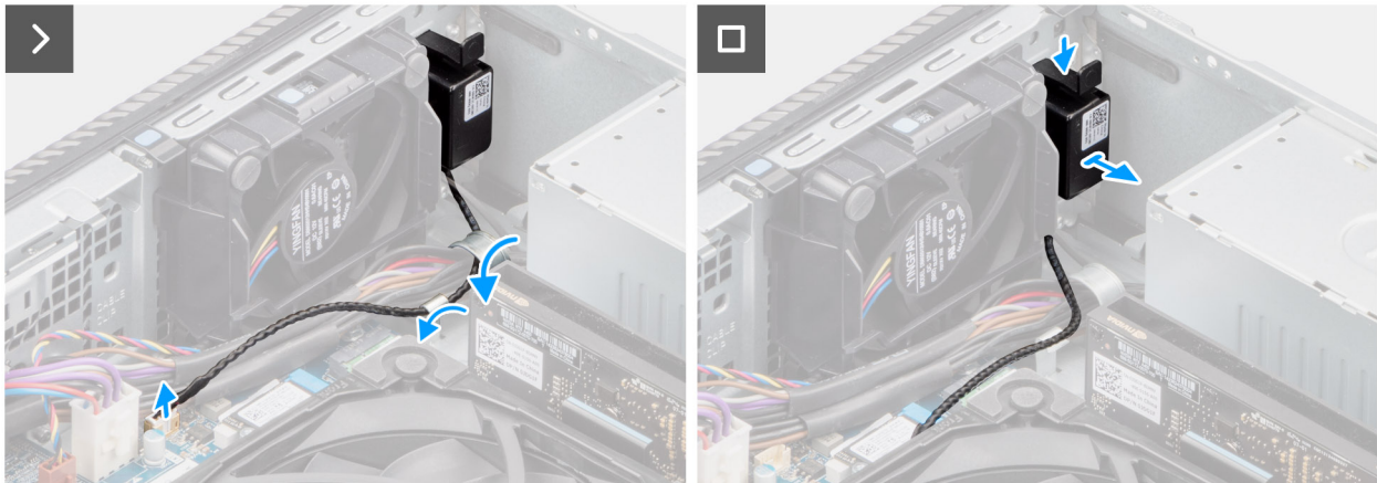
Abbildung 25. Entfernen des internen Lautsprechers
