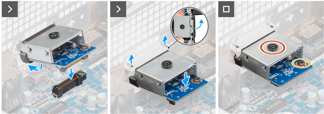
Abbildung 63. Installieren des optionalen VGA-Moduls
