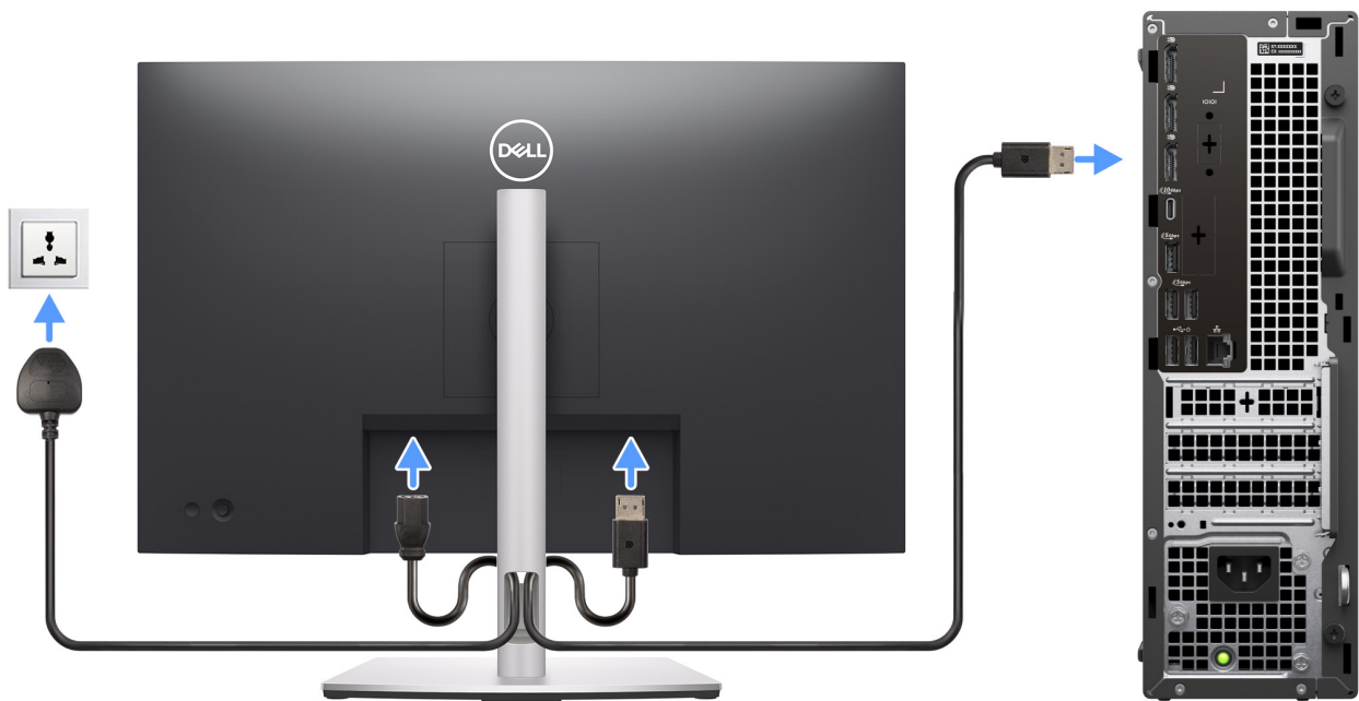
Abbildung 5. Anschließen des Displays
