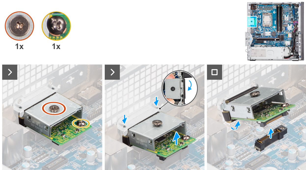
Abbildung 76. Entfernen des optionalen DisplayPort-Moduls
