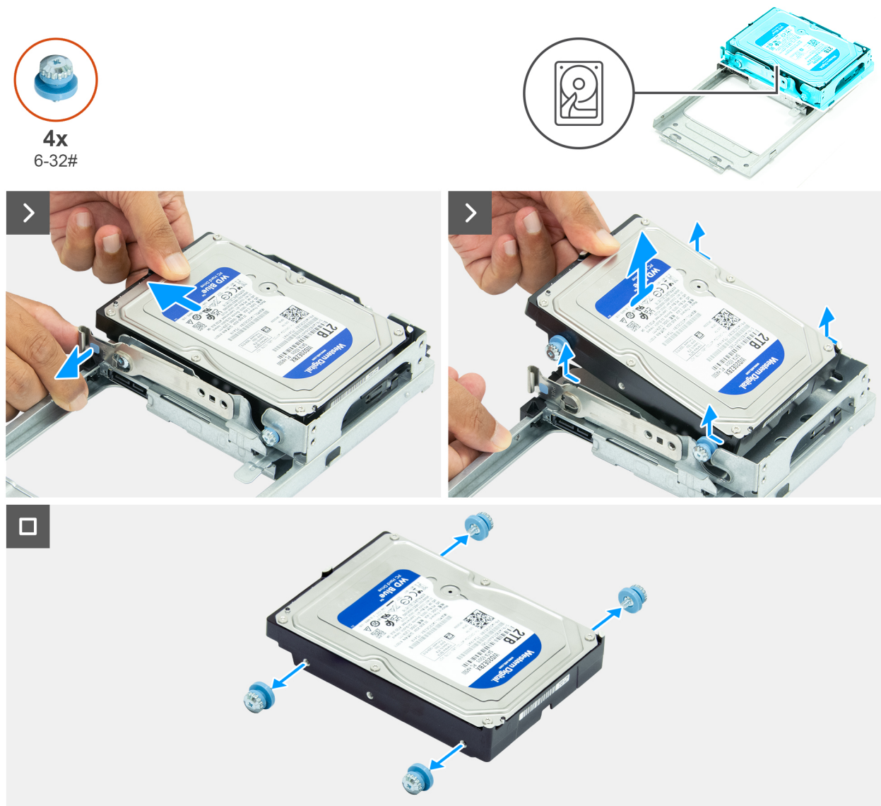
Abbildung 29. Entfernen der Festplatte
