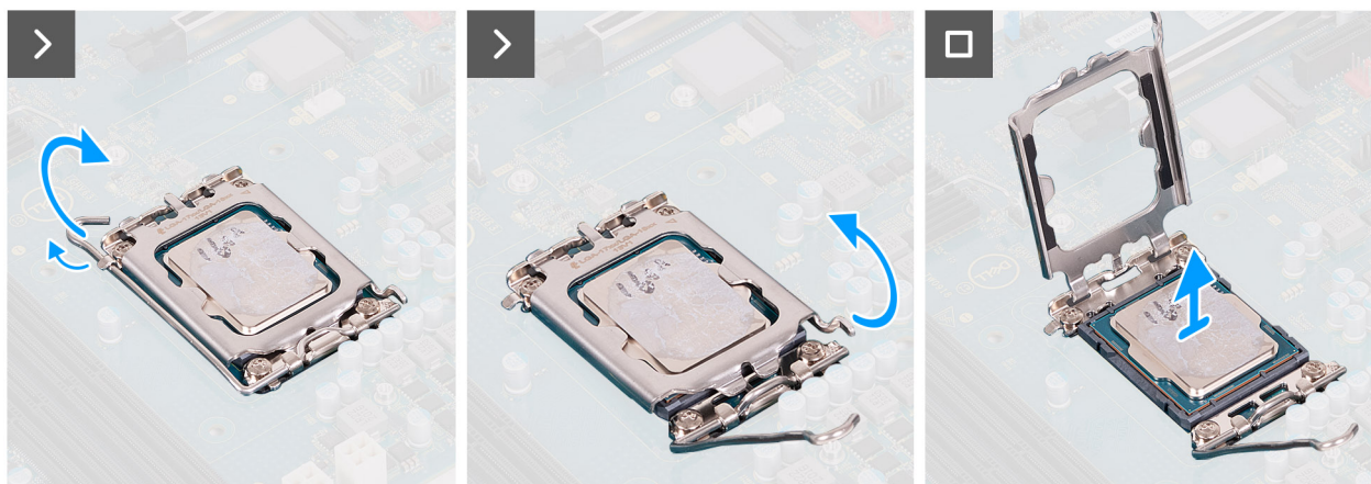
Abbildung 55. Entfernen des Prozessors
