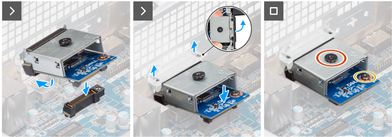
Abbildung 75. Installieren des optionalen HDMI-Moduls
