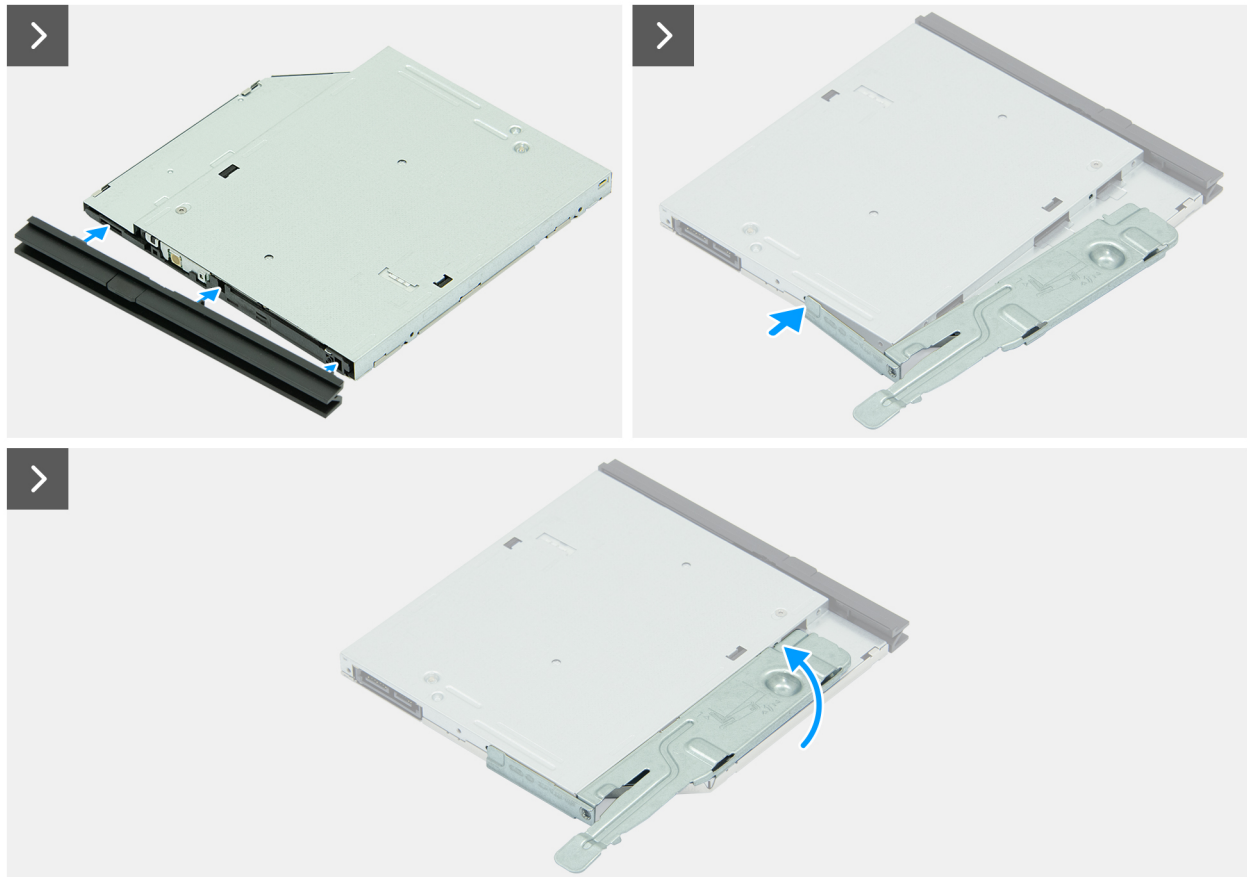
Abbildung 19. Installieren des optischen Laufwerks
