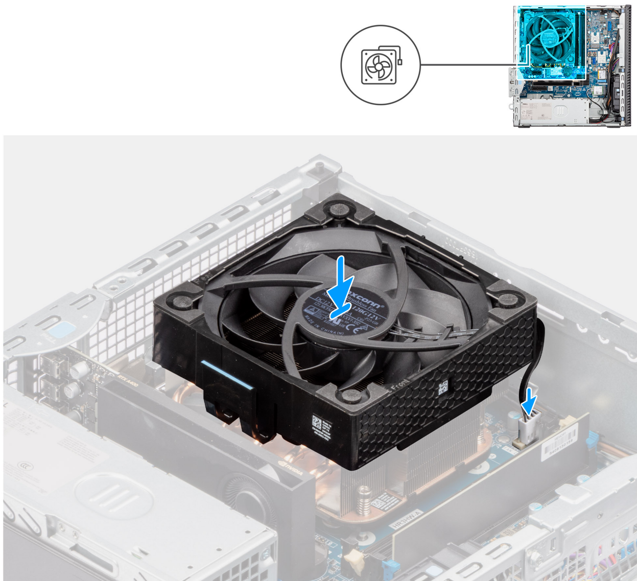
Abbildung 52. Installieren des Prozessorlüfters
