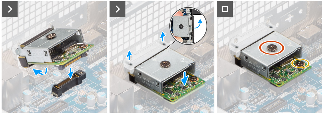
Abbildung 72. Installieren des optionalen LAN-Moduls
