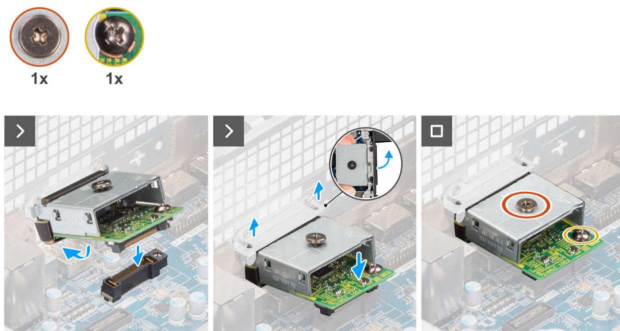
Abbildung 78. Installieren des optionalen DisplayPort-Moduls
