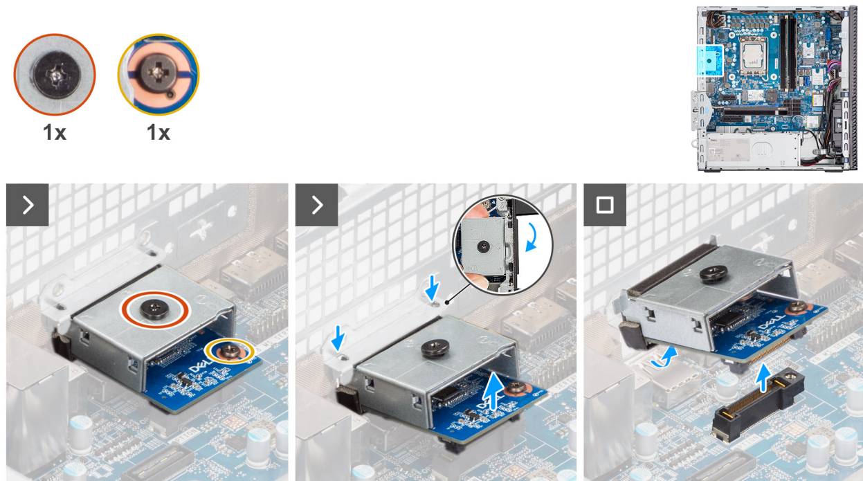
Abbildung 73. Entfernen des optionalen HDMI-Moduls
