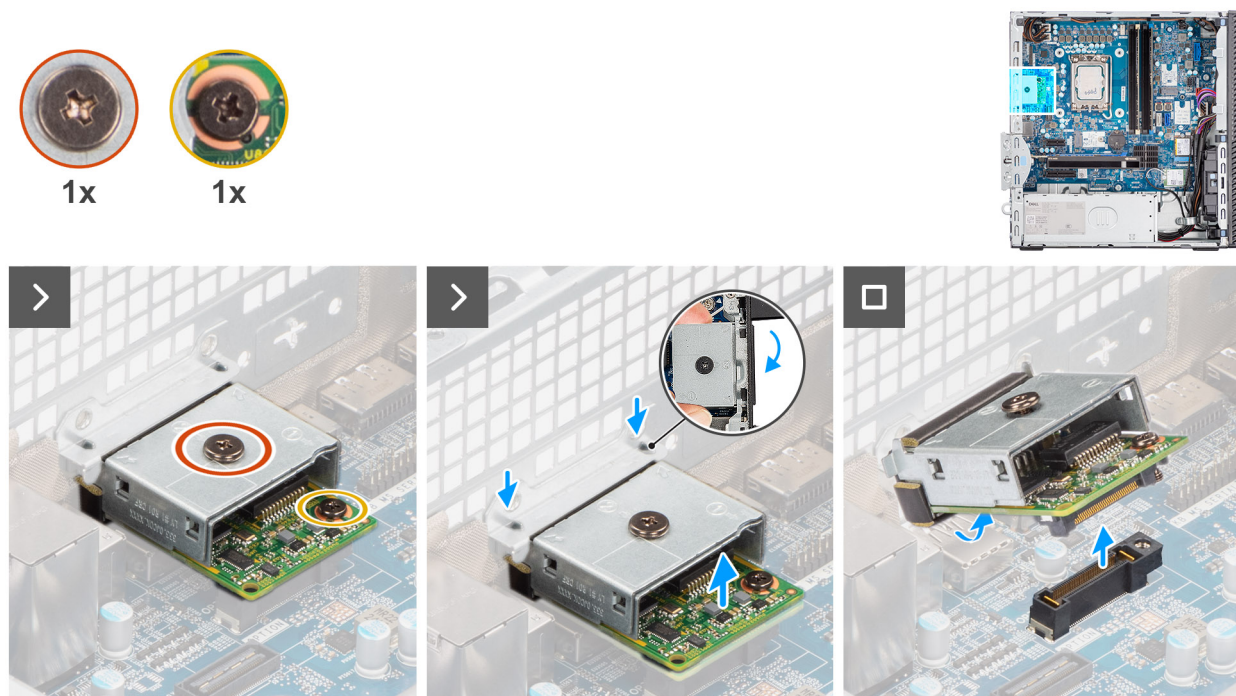
Abbildung 70. Entfernen des optionalen LAN-Moduls
