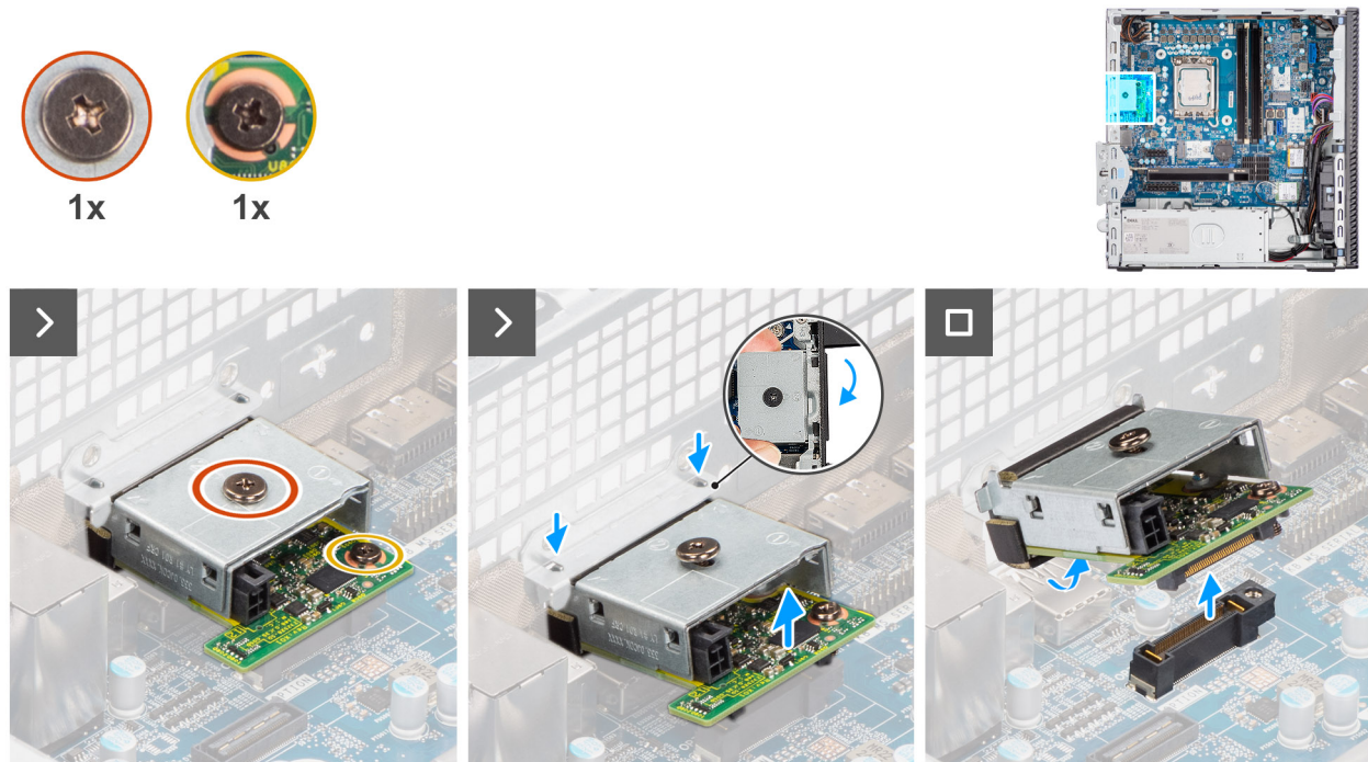
Figure 67. Retrait du module Thunderbolt en option
