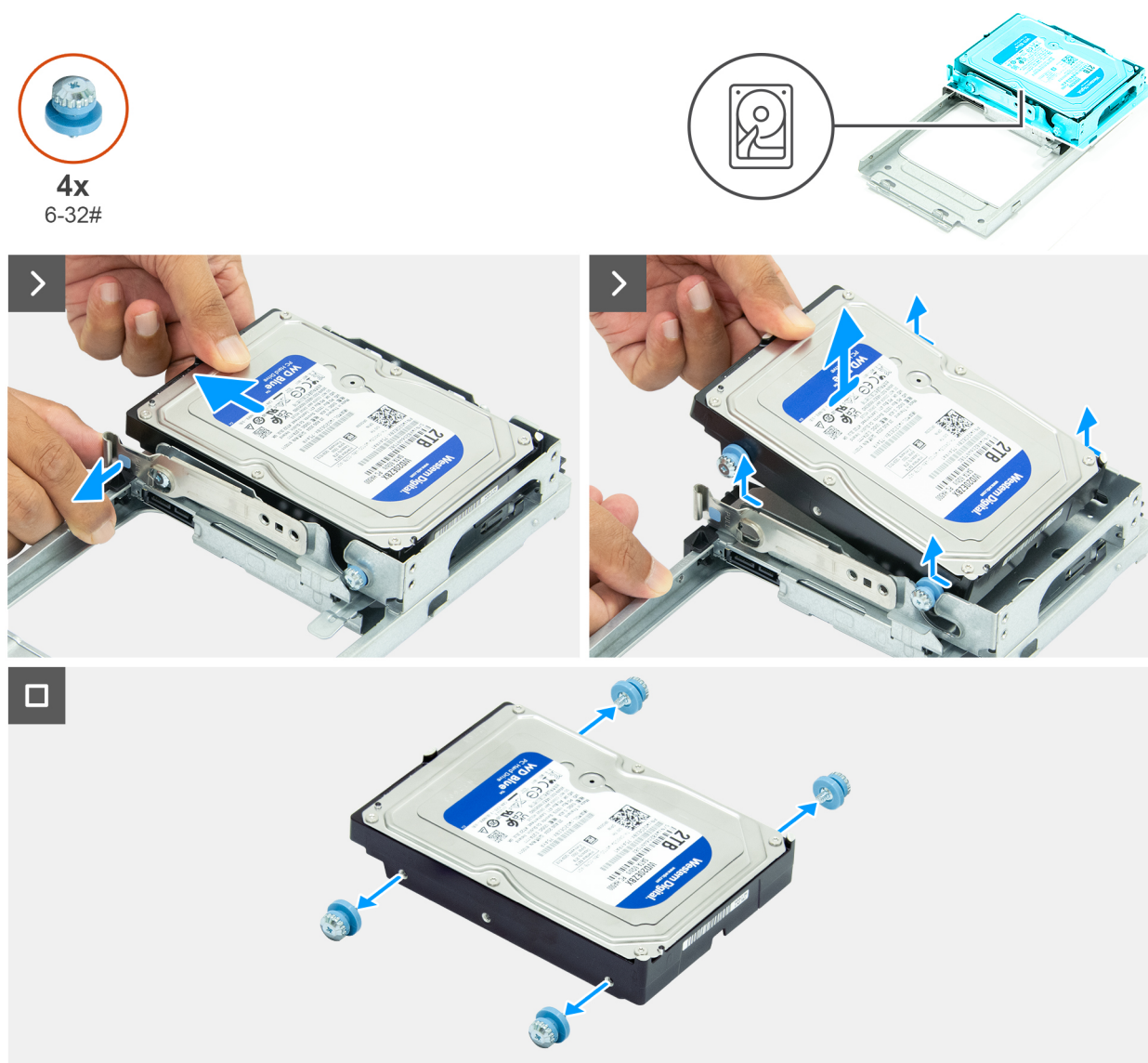
Figure 29. Retrait du disque dur
