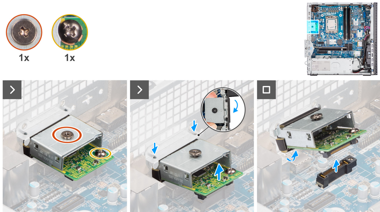
Figure 76. Retrait du module DisplayPort en option
