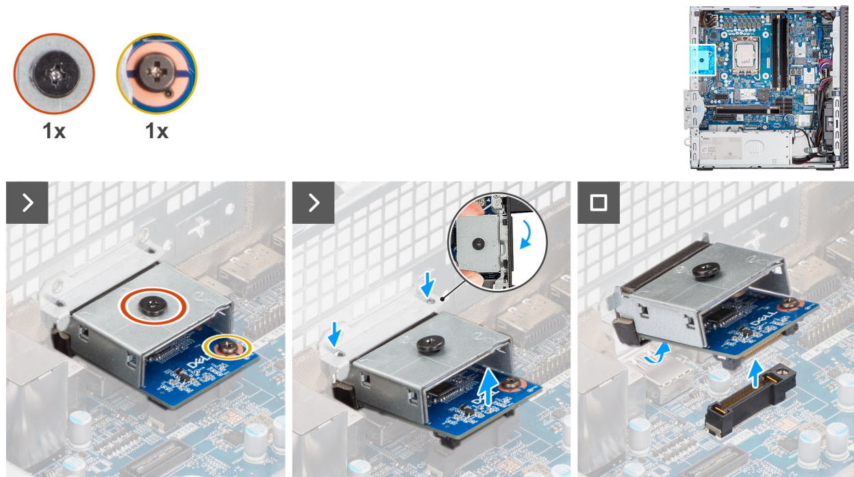
Figure 73. Retrait du module HDMI en option
