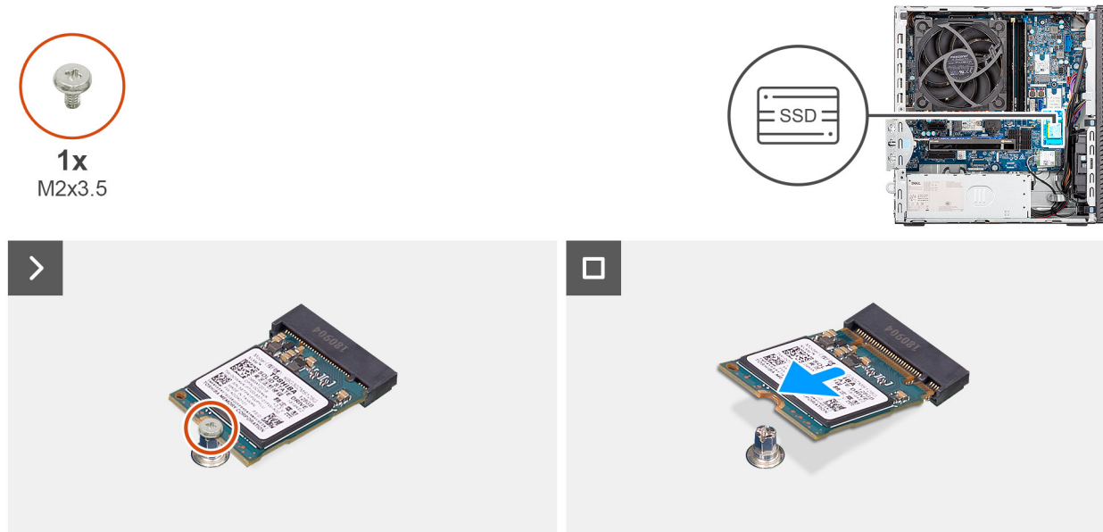
Figure 31. Retrait du disque SSD M.2 2230
