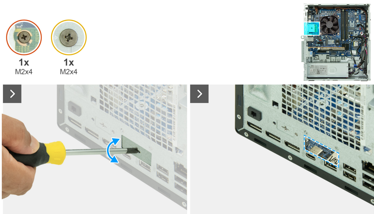
Figure 76. Installation du module de port en option
