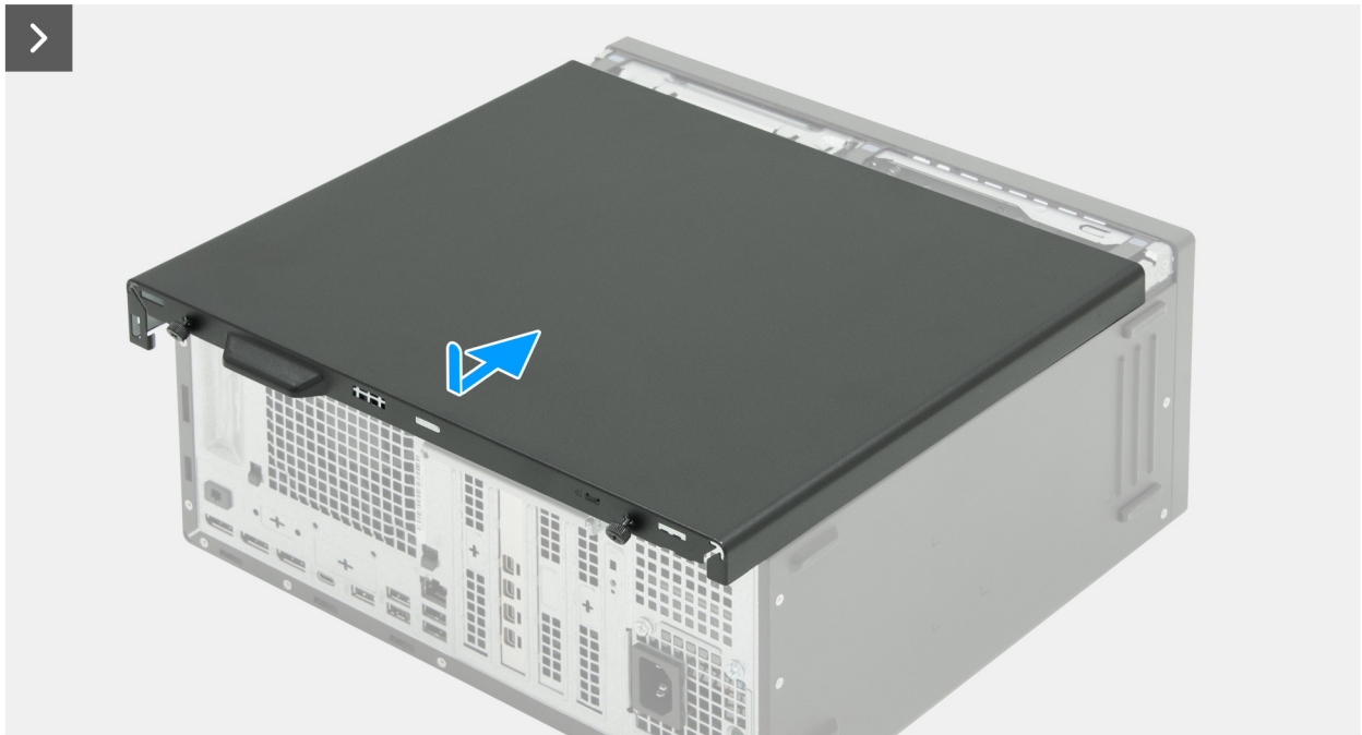
Figure 15. Installation du panneau latéral gauche
