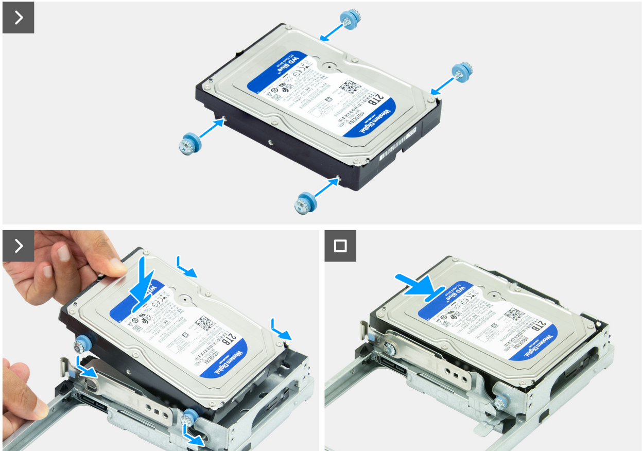
Figure 64. Installation du disque dur
