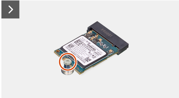
Figure 34. Retrait du disque SSD M.2 2230 du logement 1
