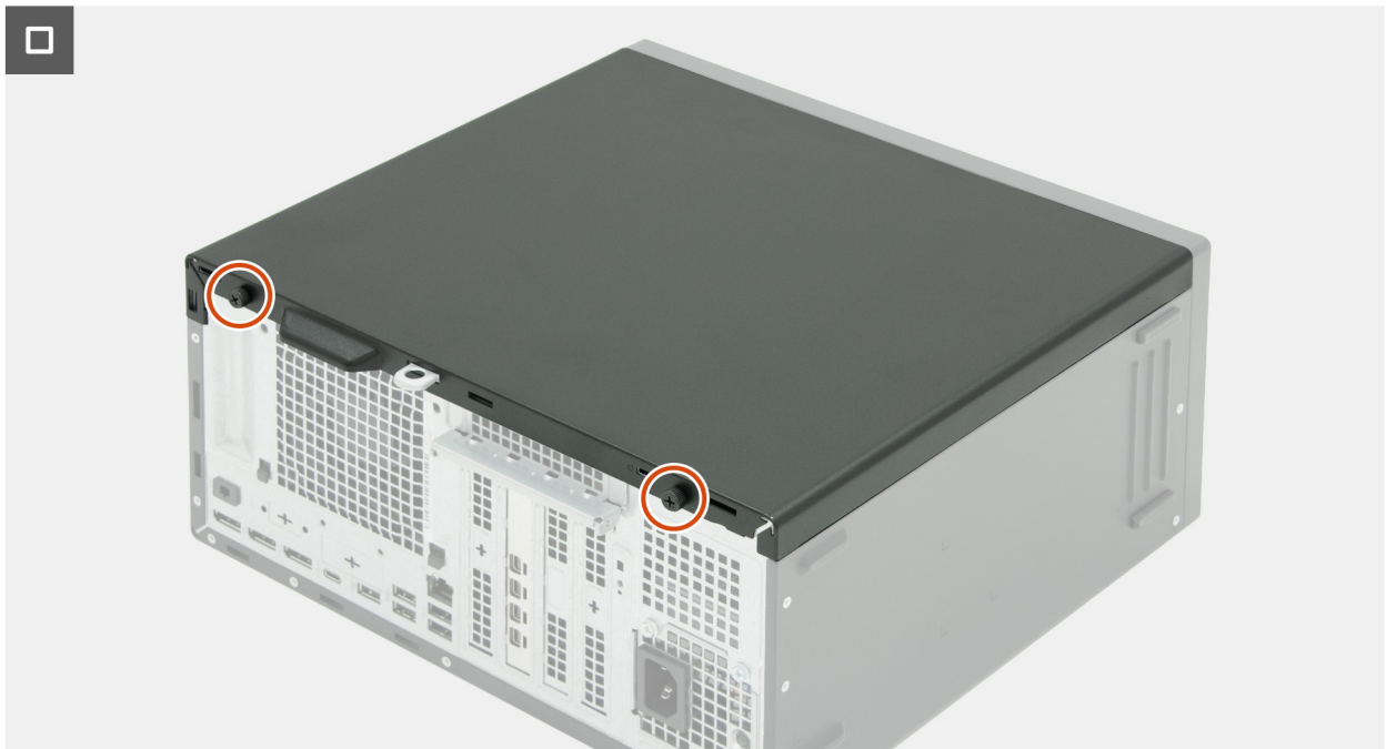
Figure 16. Installation du panneau latéral gauche
