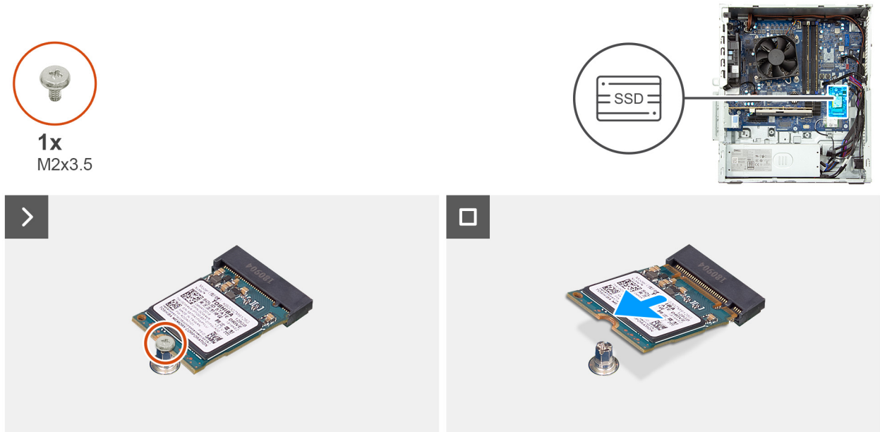
Figure 29. Retrait du disque SSD M.2 2230 du logement 0
