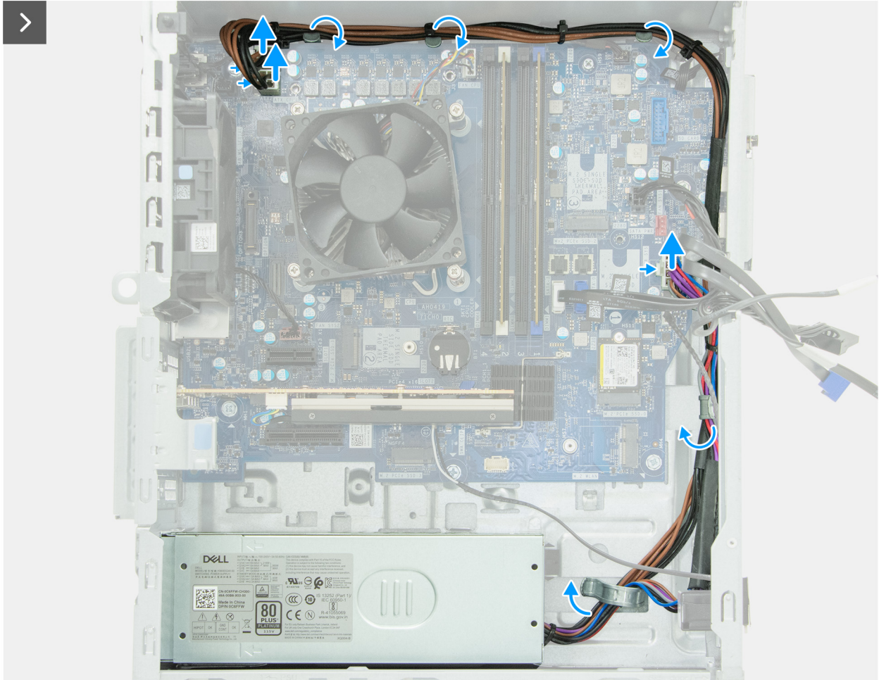
Figure 88. Retrait du bloc d'alimentation
