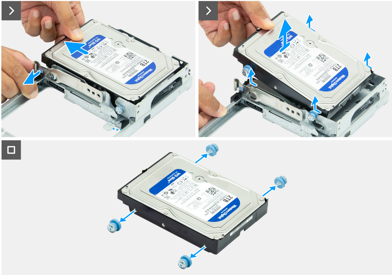
Figure 63. Retrait du disque dur
