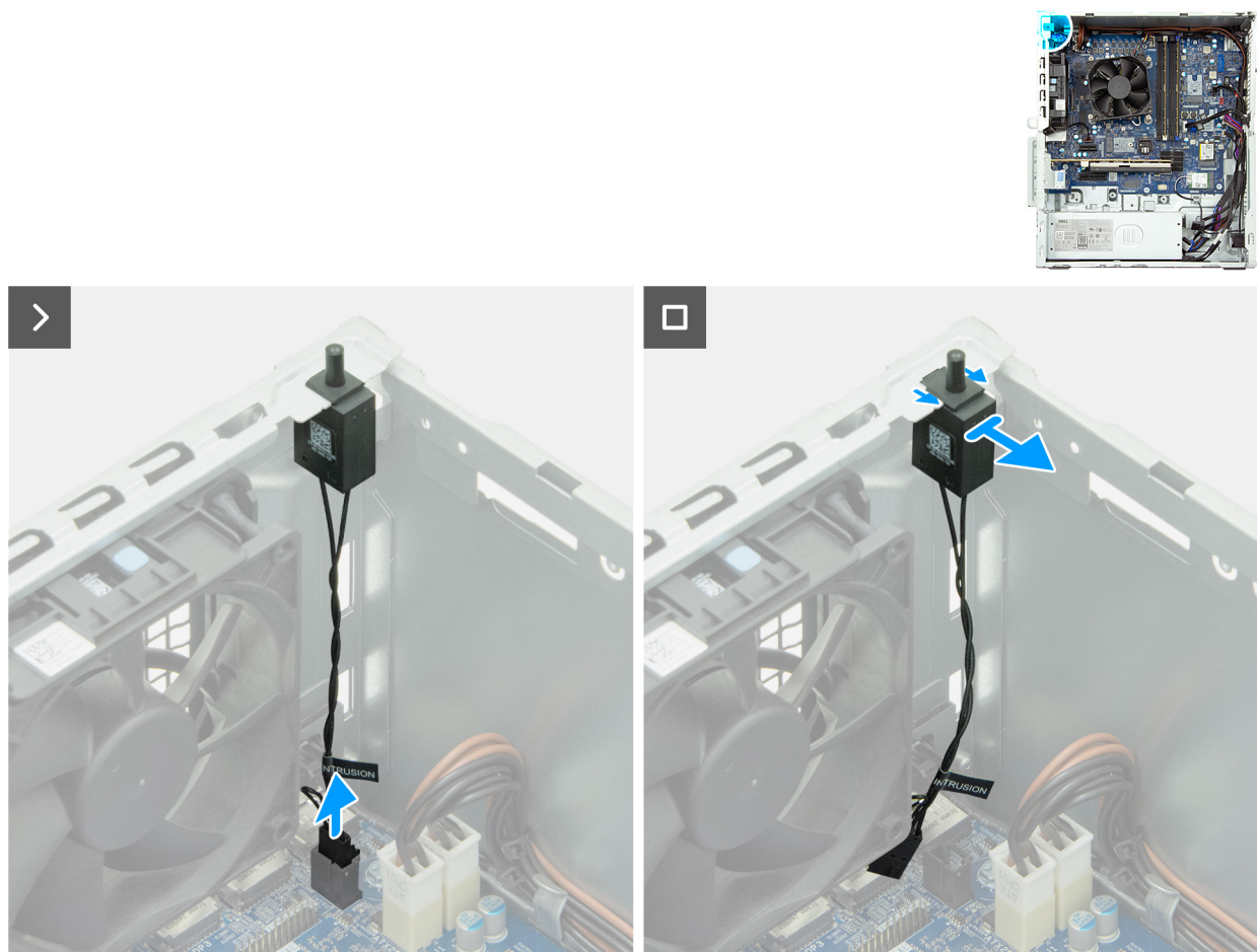
Figure 65. Retrait du commutateur d'intrusion
