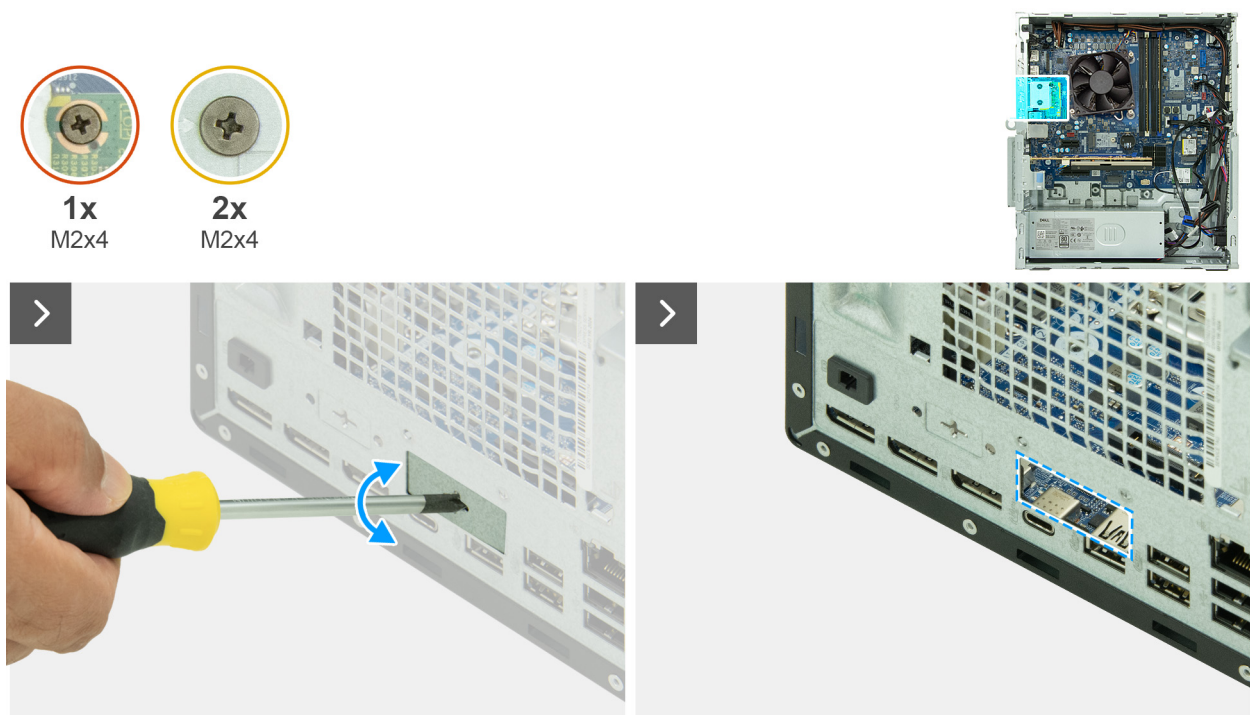
Figure 79. Installation du module de port de fibre optique
