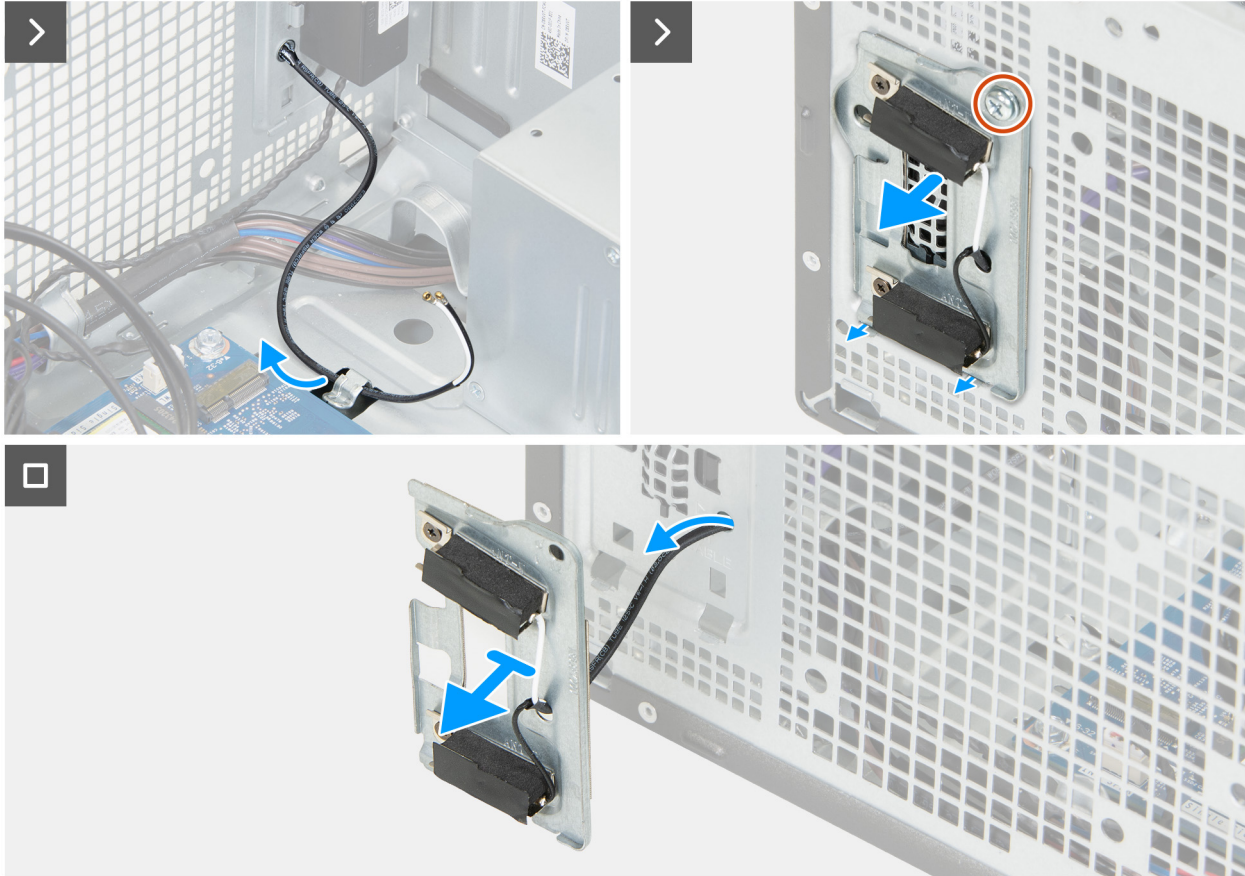
Figure 86. Retrait des modules d'antenne
