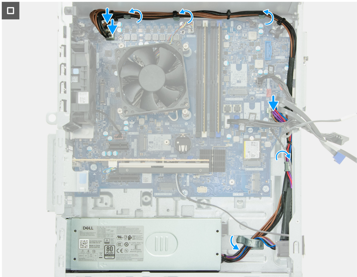
Figure 91. Installation du bloc d'alimentation
