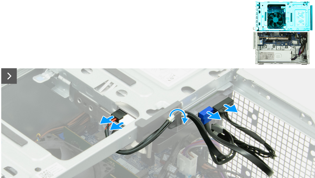
Figure 58. Retrait de la baie de disques
