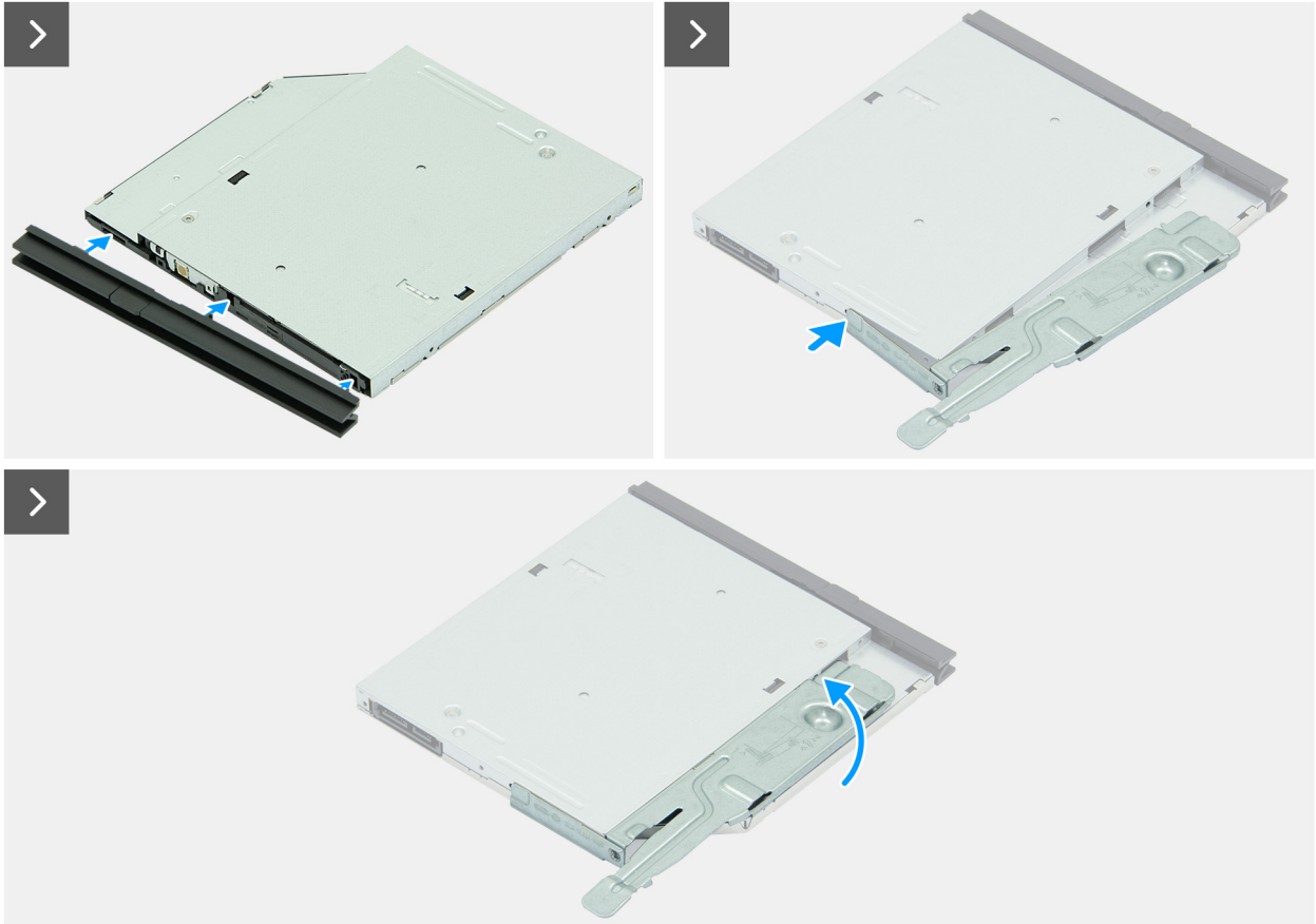
Figure 56. Installation du lecteur optique
