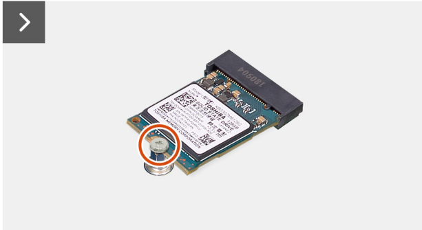
Afbeelding 34. De M.2 2230 SSD uit slot 1 verwijderen
