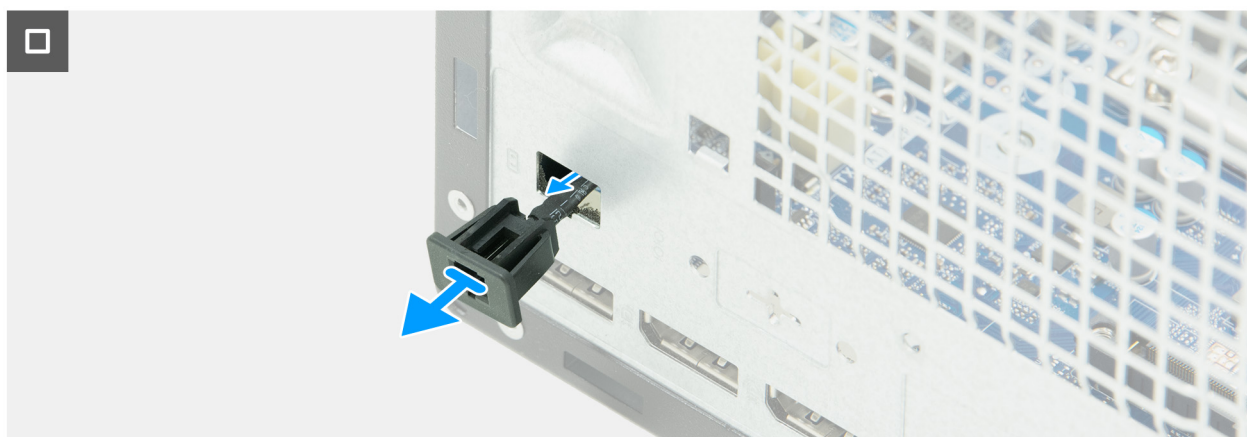
Afbeelding 70. De kabel van de externe aan-uitknop verwijderen
