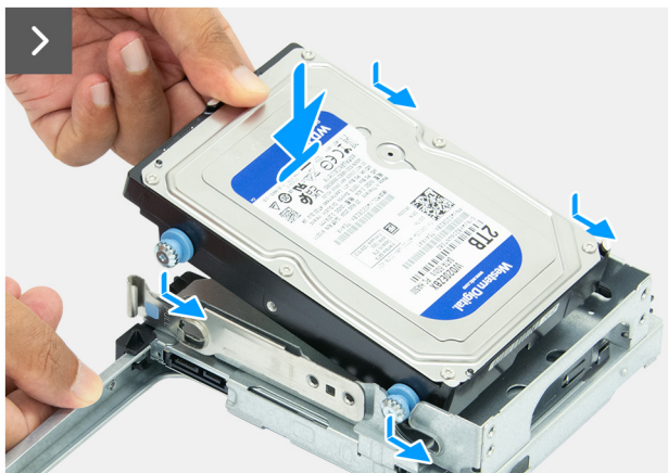
Afbeelding 64. De harde schijf plaatsen
