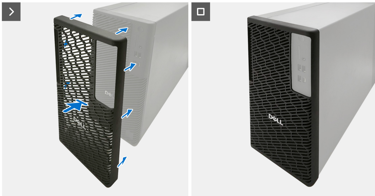
Afbeelding 22. Het stoffilter plaatsen
