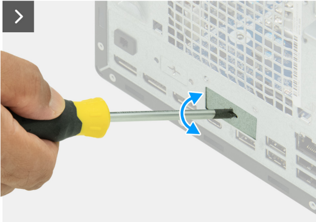
Afbeelding 79. De glasvezelpoortmodule installeren
