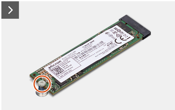
Afbeelding 31. De M.2 2280 SSD uit slot 0 verwijderen
