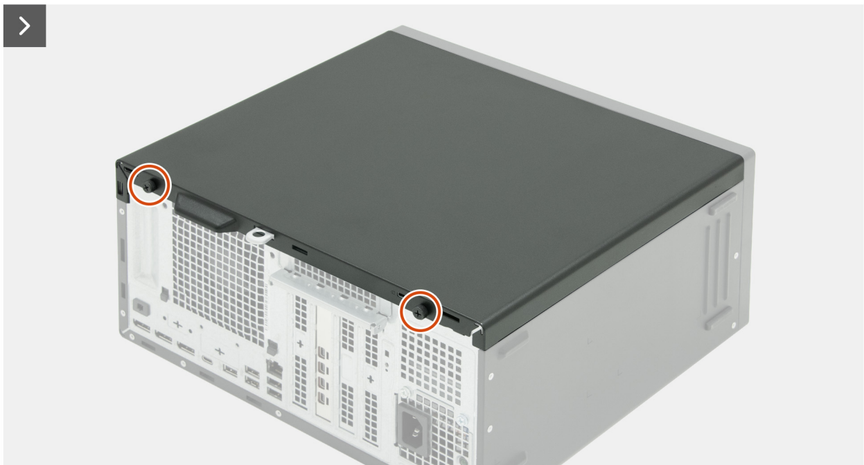
Afbeelding 13. De linkerplaat verwijderen
