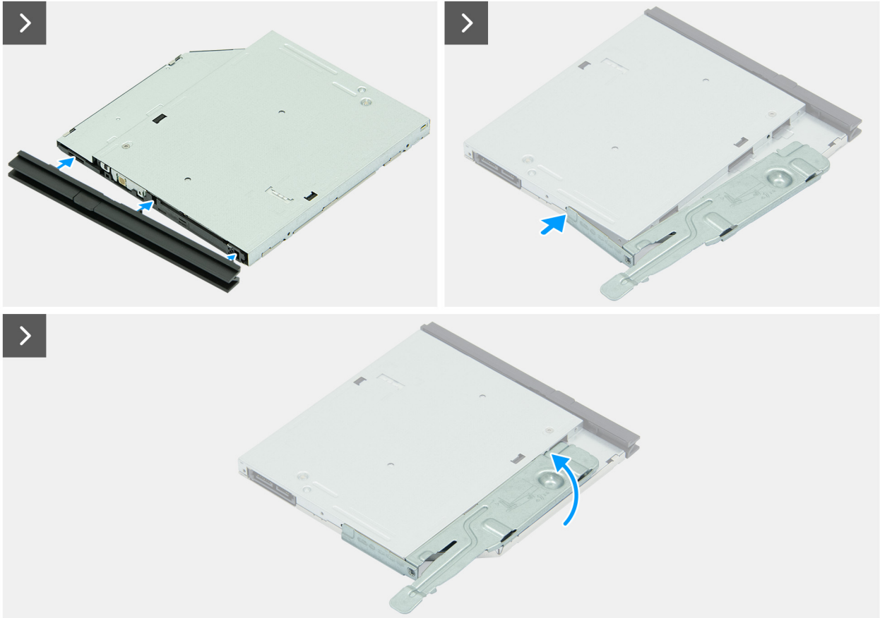
Afbeelding 56. Het optisch station plaatsen
