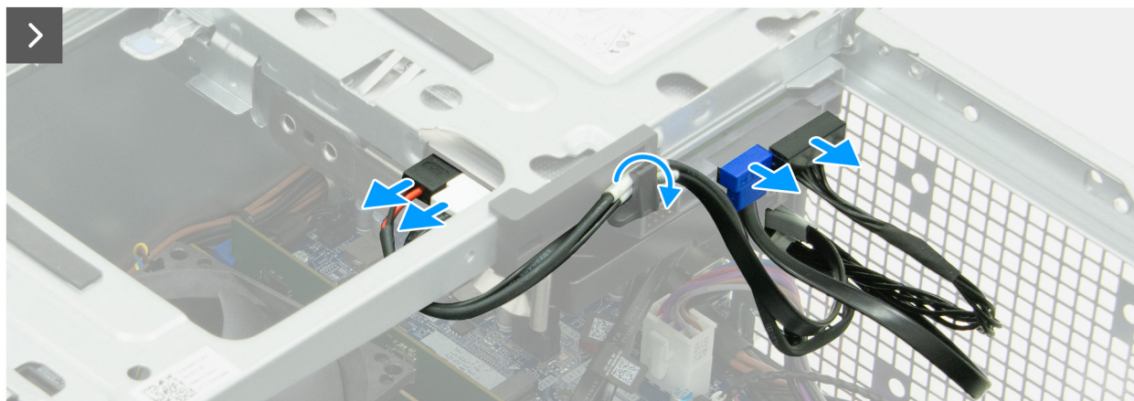
Afbeelding 58. De schijfbay verwijderen
