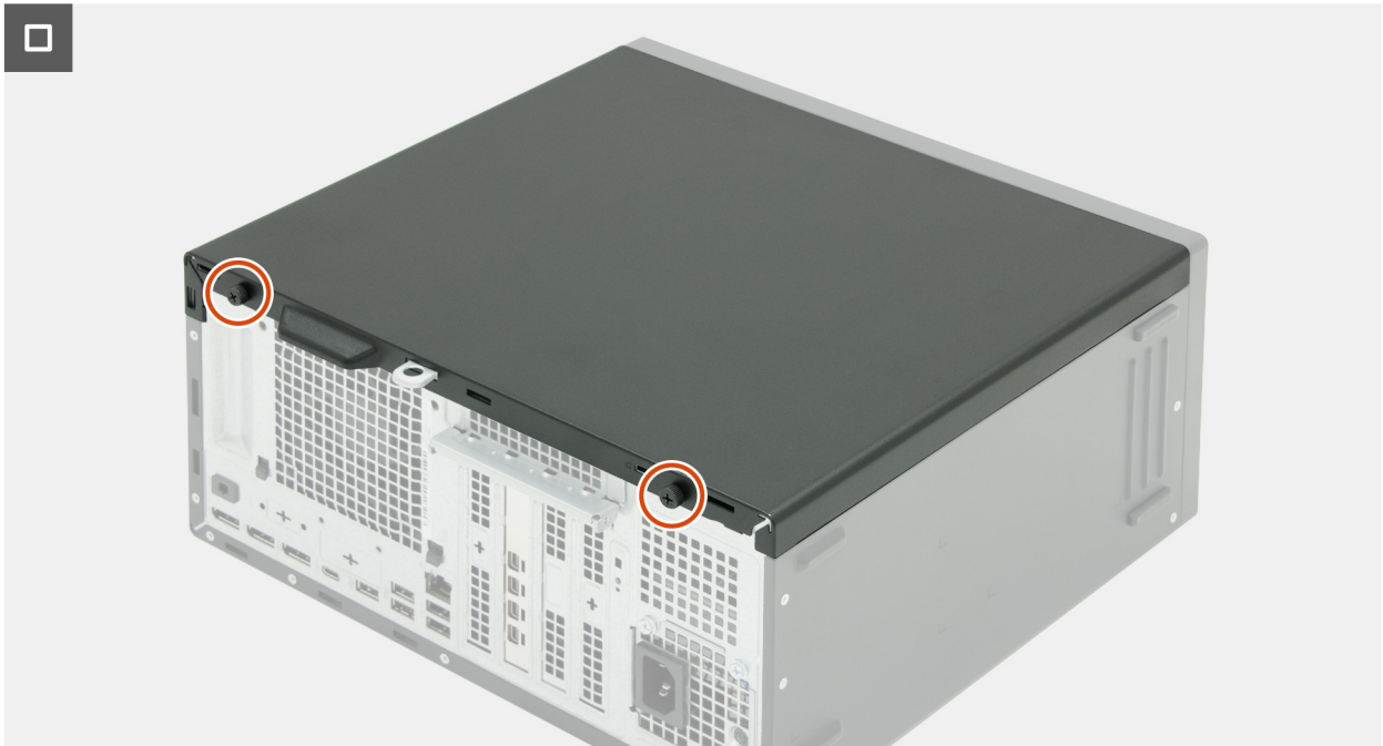
Afbeelding 16. De linkerplaat plaatsen
