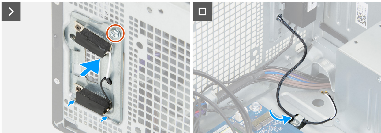
Afbeelding 87. De antennemodules plaatsen
