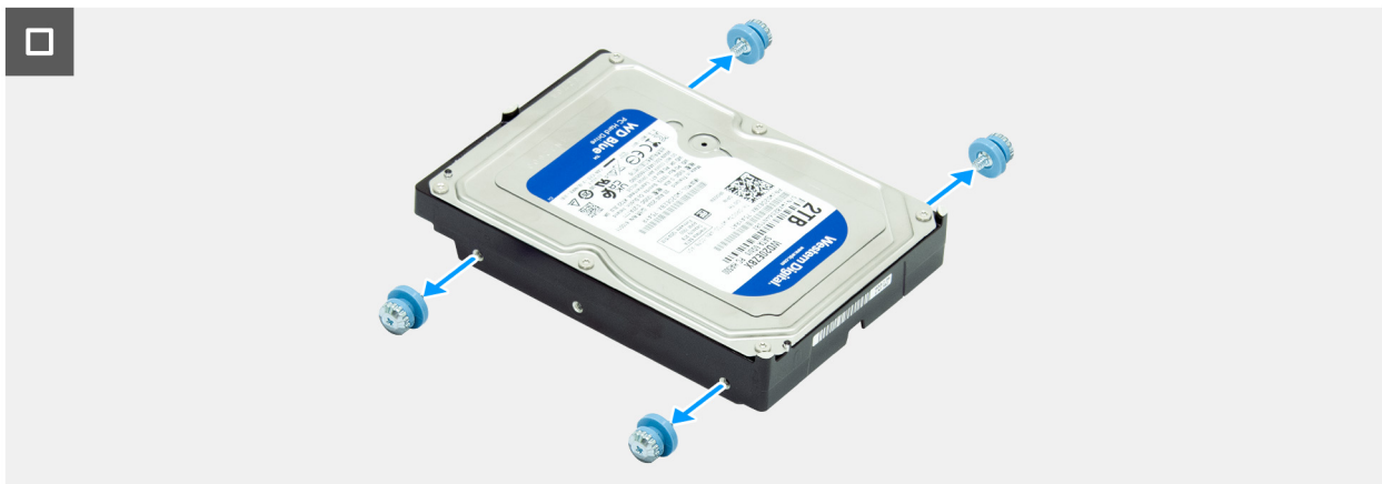
Afbeelding 63. De harde schijf verwijderen
