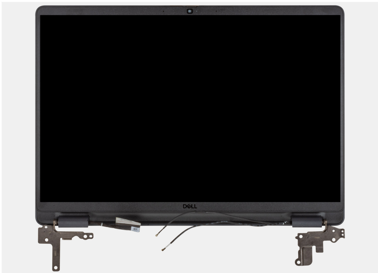
Abbildung 101. Entfernen der Bildschirmbaugruppe
