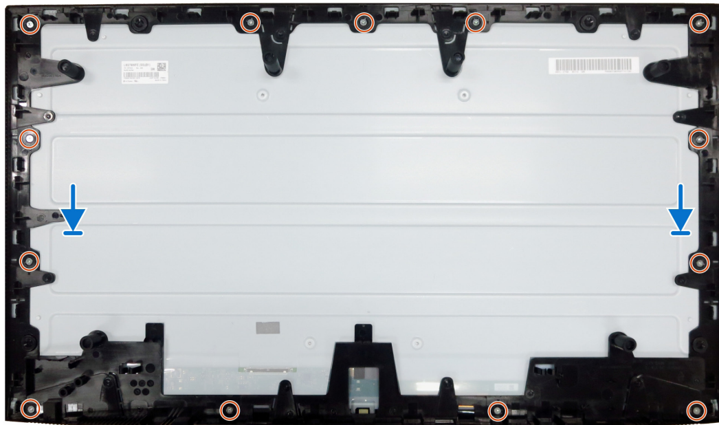
Figura 21. Instalación del marco central
