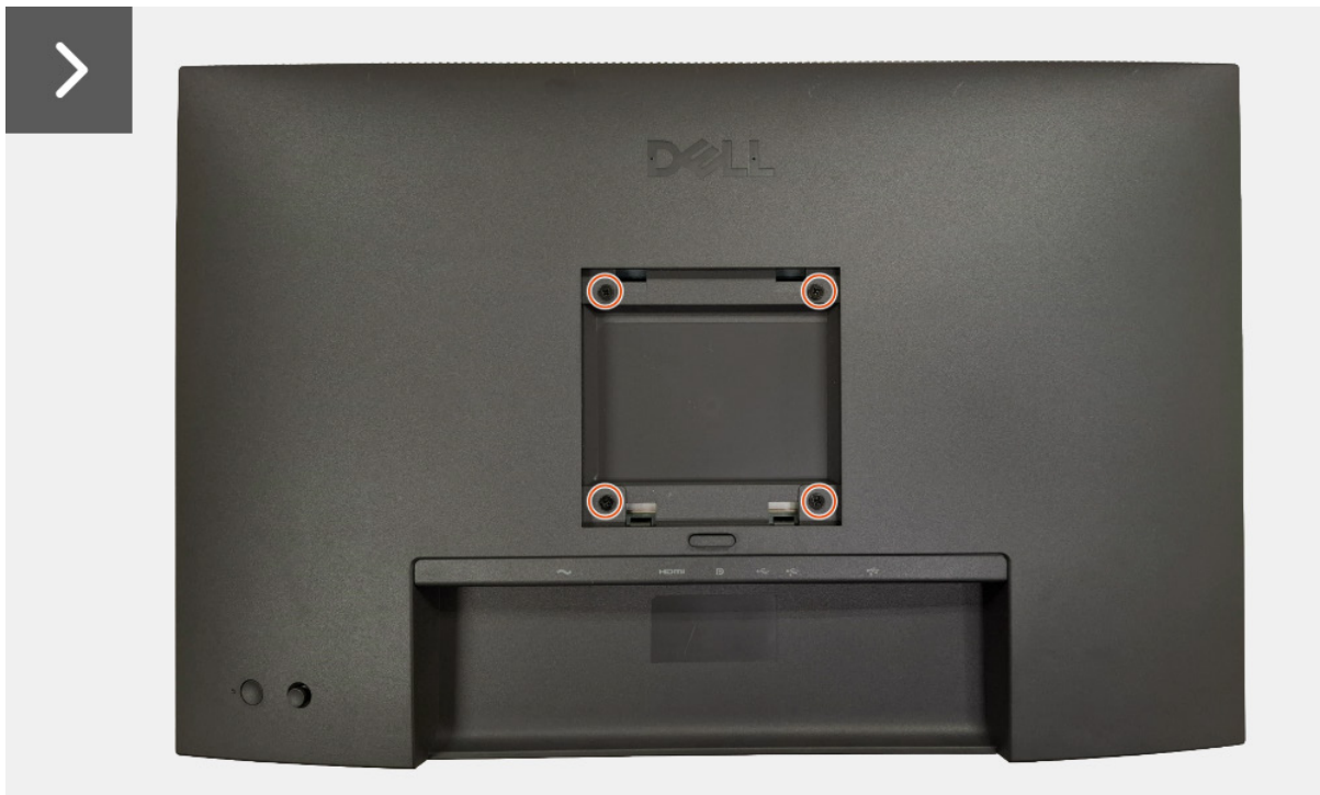
Figura 13. Retirar la cubierta posterior
