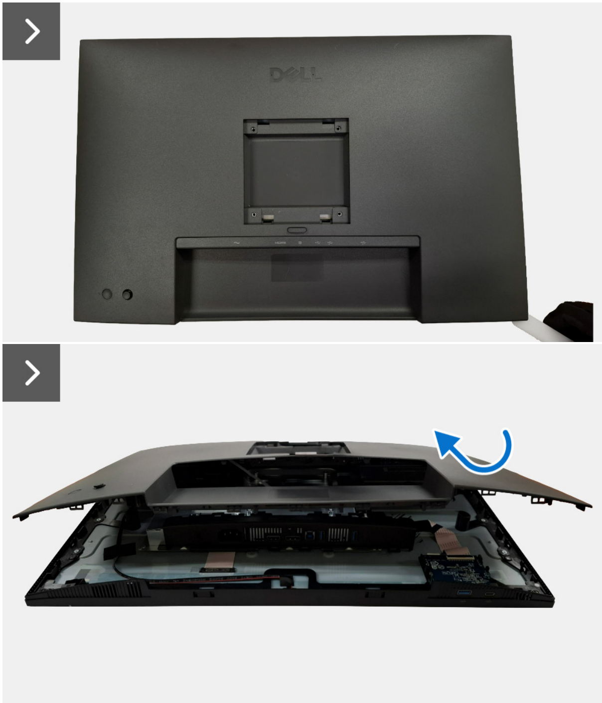
Figura 14. Retirar la cubierta posterior
