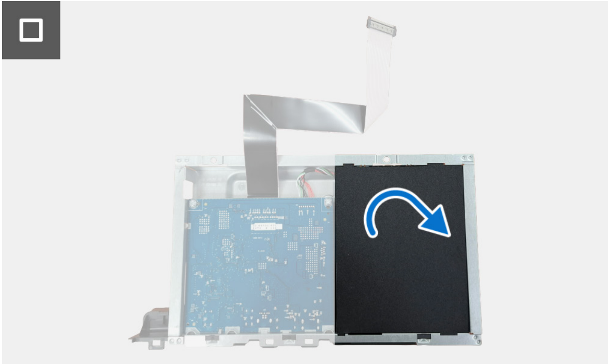
Figura 29. Instalar la placa de alimentación
