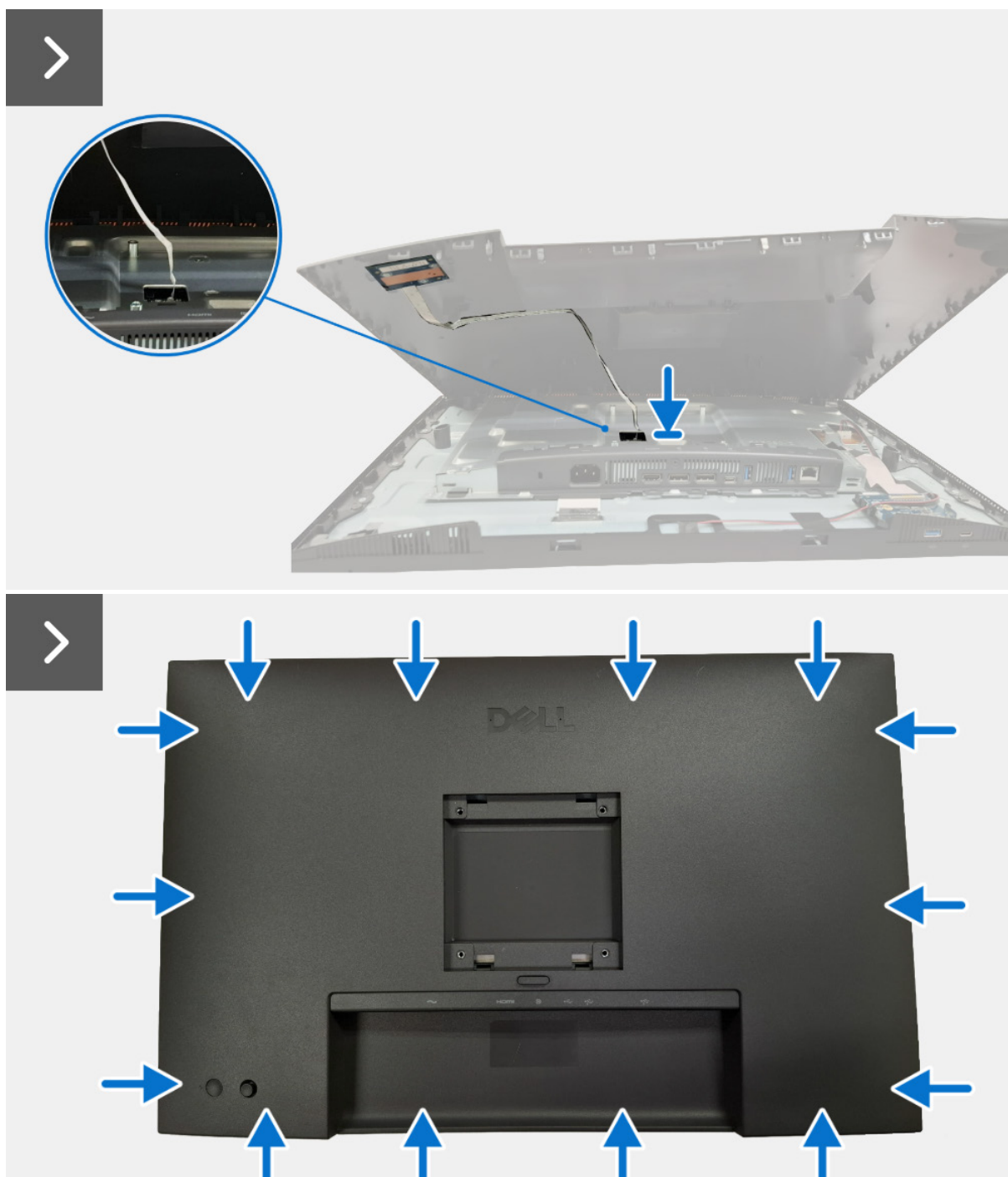
Figura 16. Instalar la cubierta posterior
