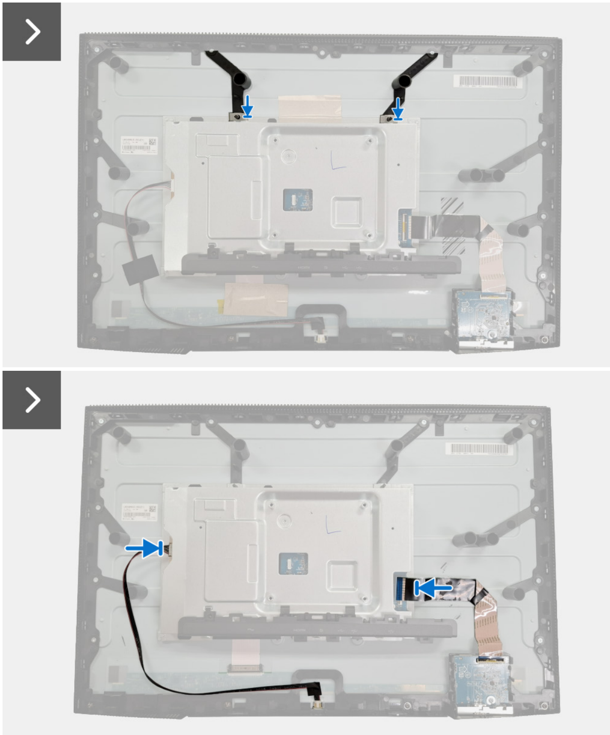
Figura 22. Instalar el protector metálico
