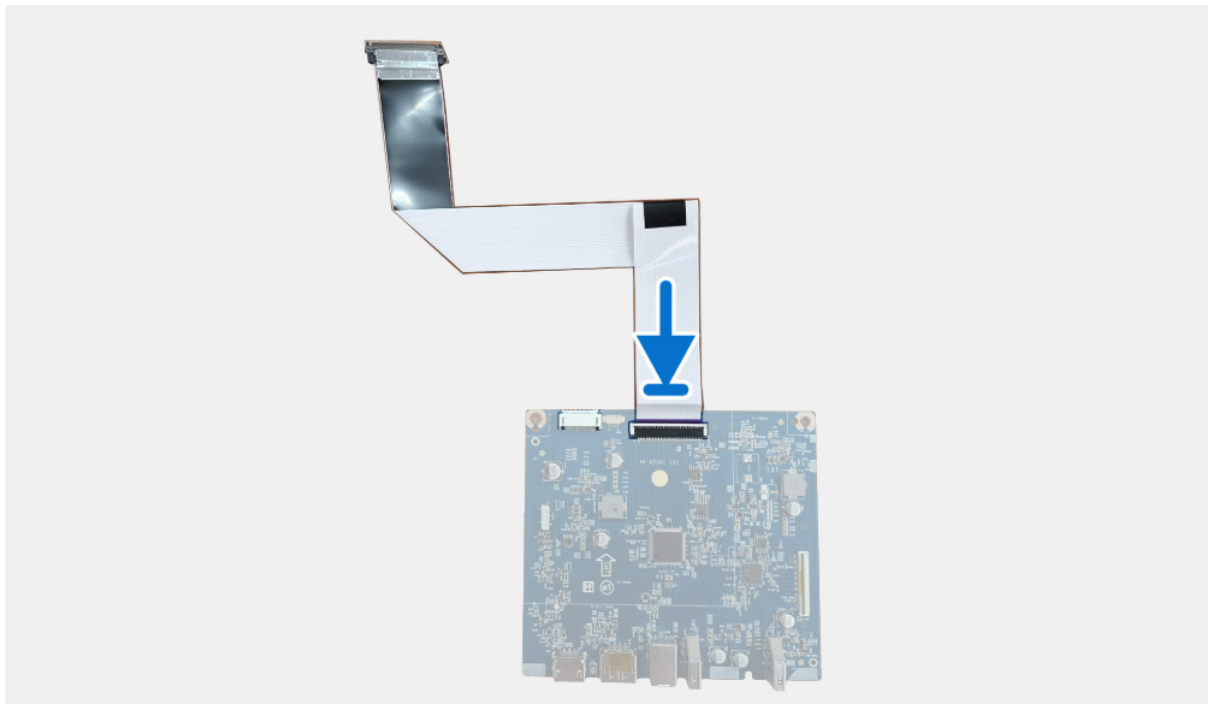
Figura 31. Instalar la placa de la interfaz
