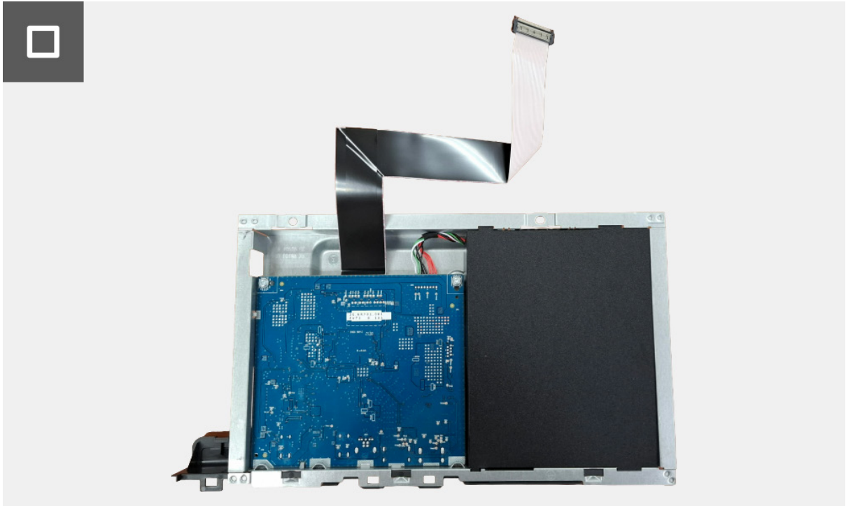
Figura 20. Retirar el protector metálico
