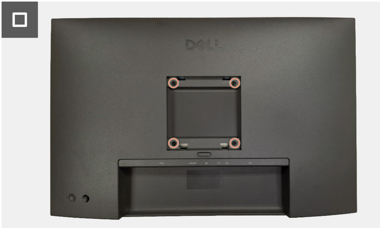
Figura 17. Instalar la cubierta posterior superior
