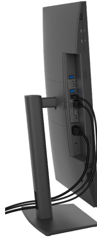
Figura 28. Conecte los cables en la posición más alta y con el máximo ángulo de giro
