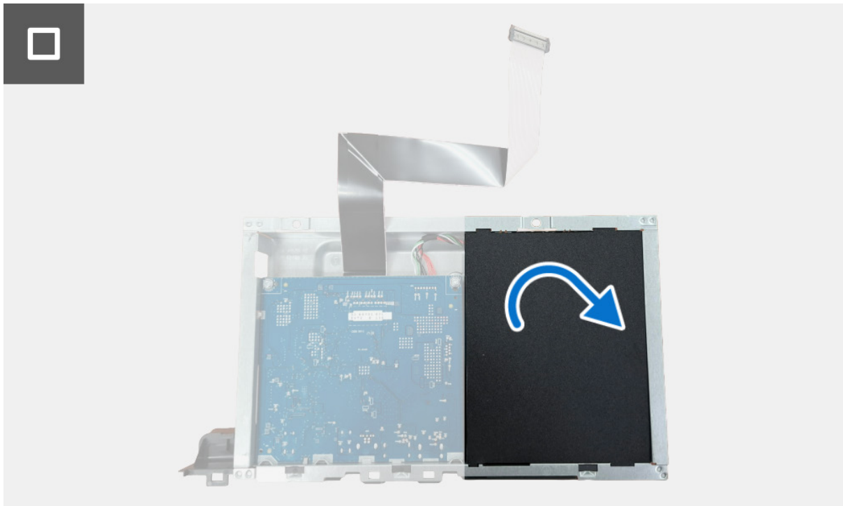
Figura 19. Instalar la placa de alimentación
