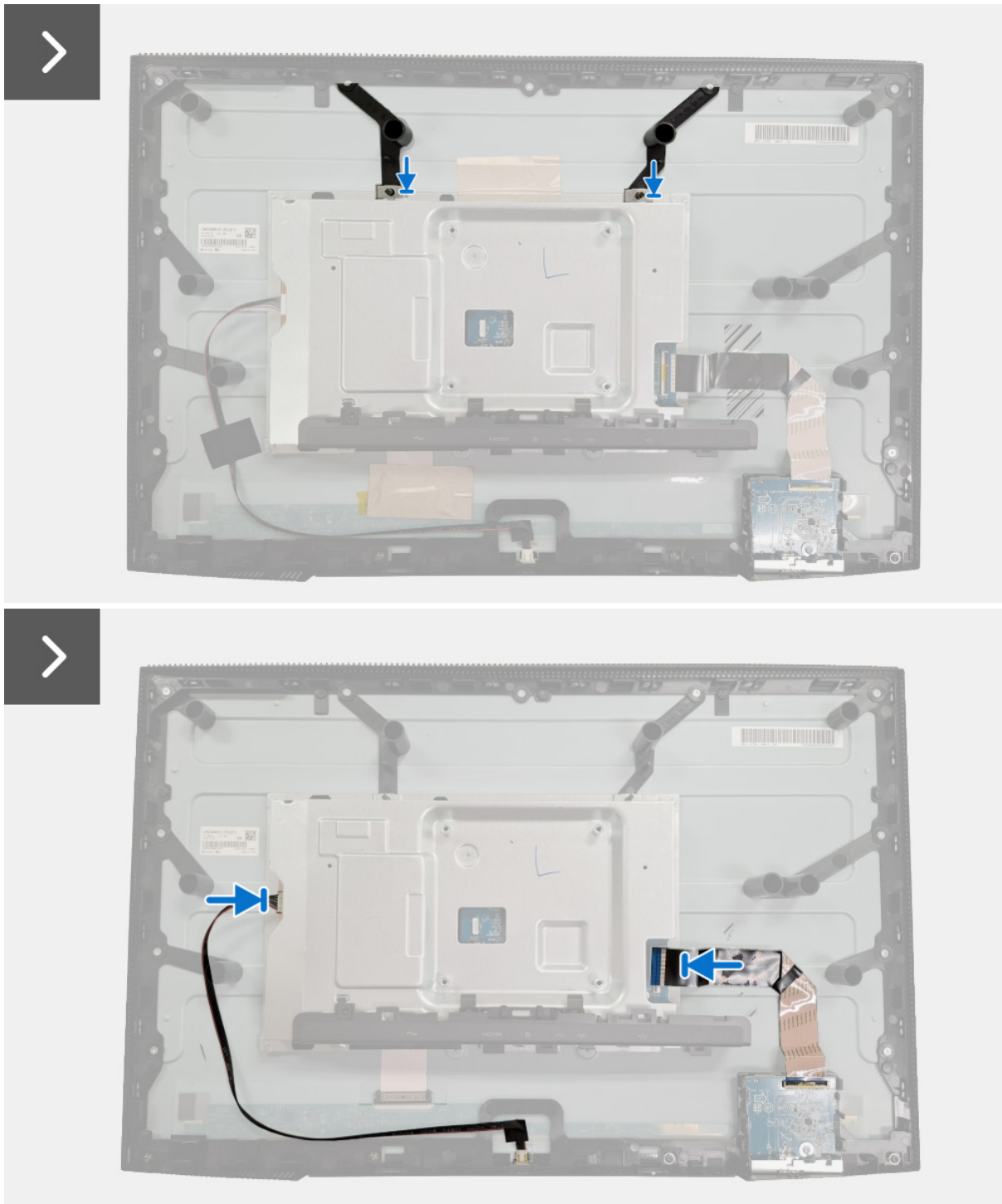
Figura 12. Instalar el protector metálico
