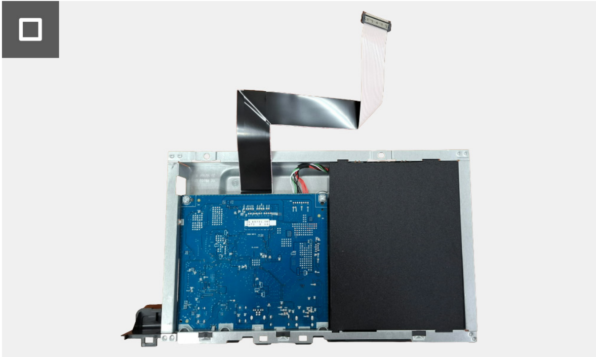
Figura 10. Retirar el protector metálico
