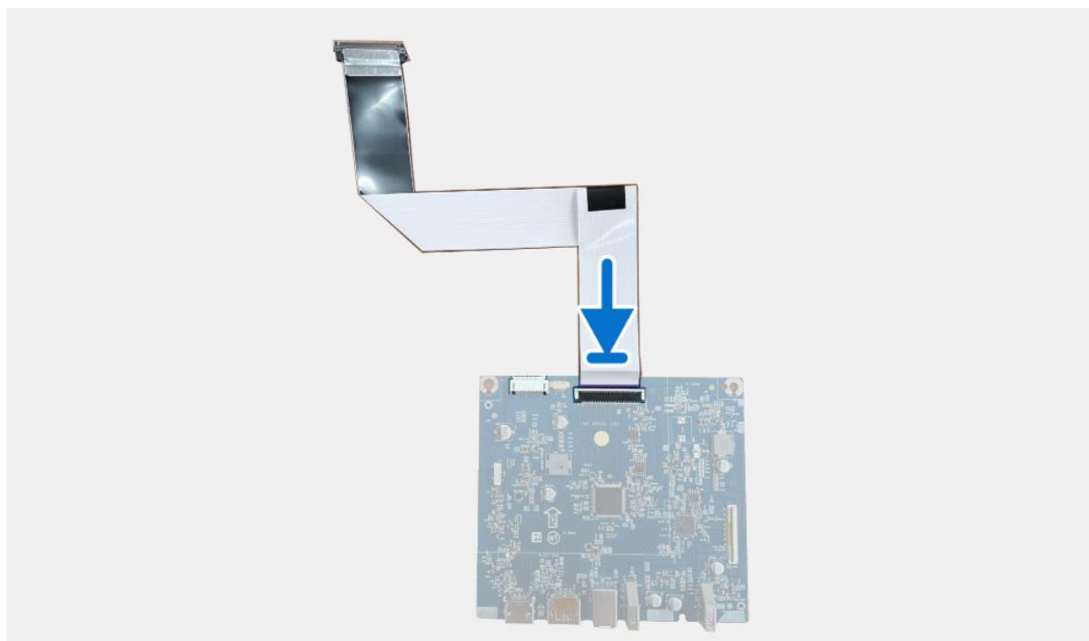
Figura 21. Instalar la placa de la interfaz
