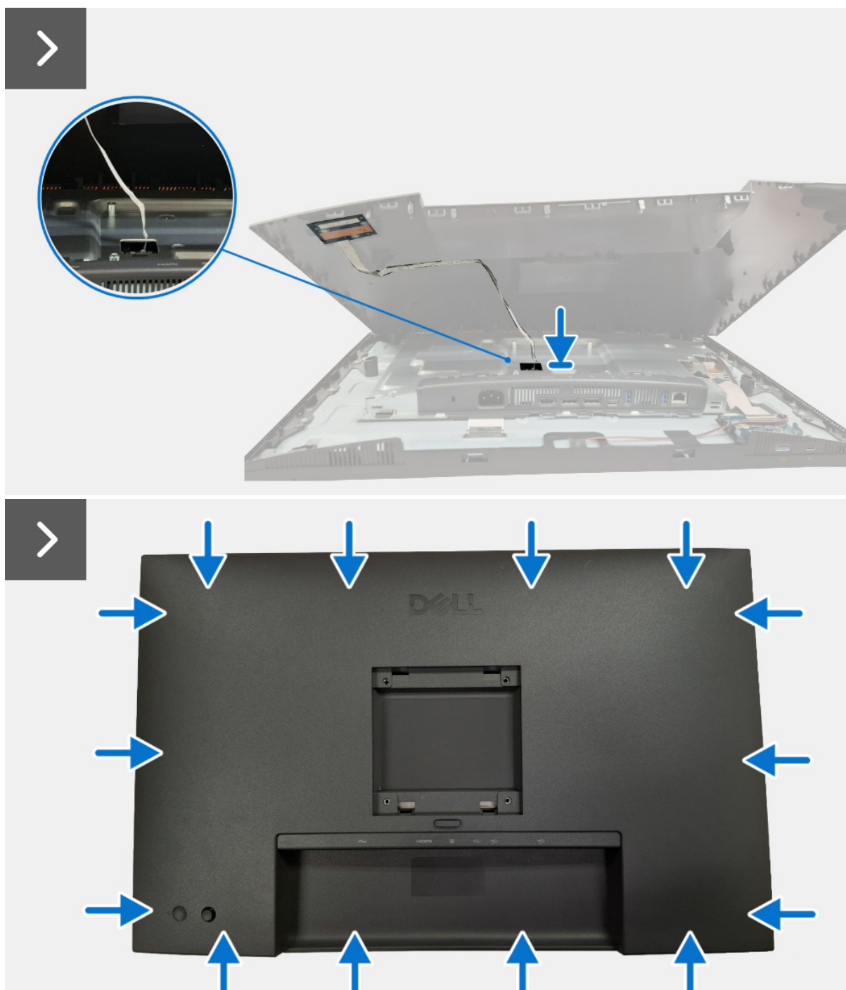
Figura 6. Instalar la cubierta posterior
