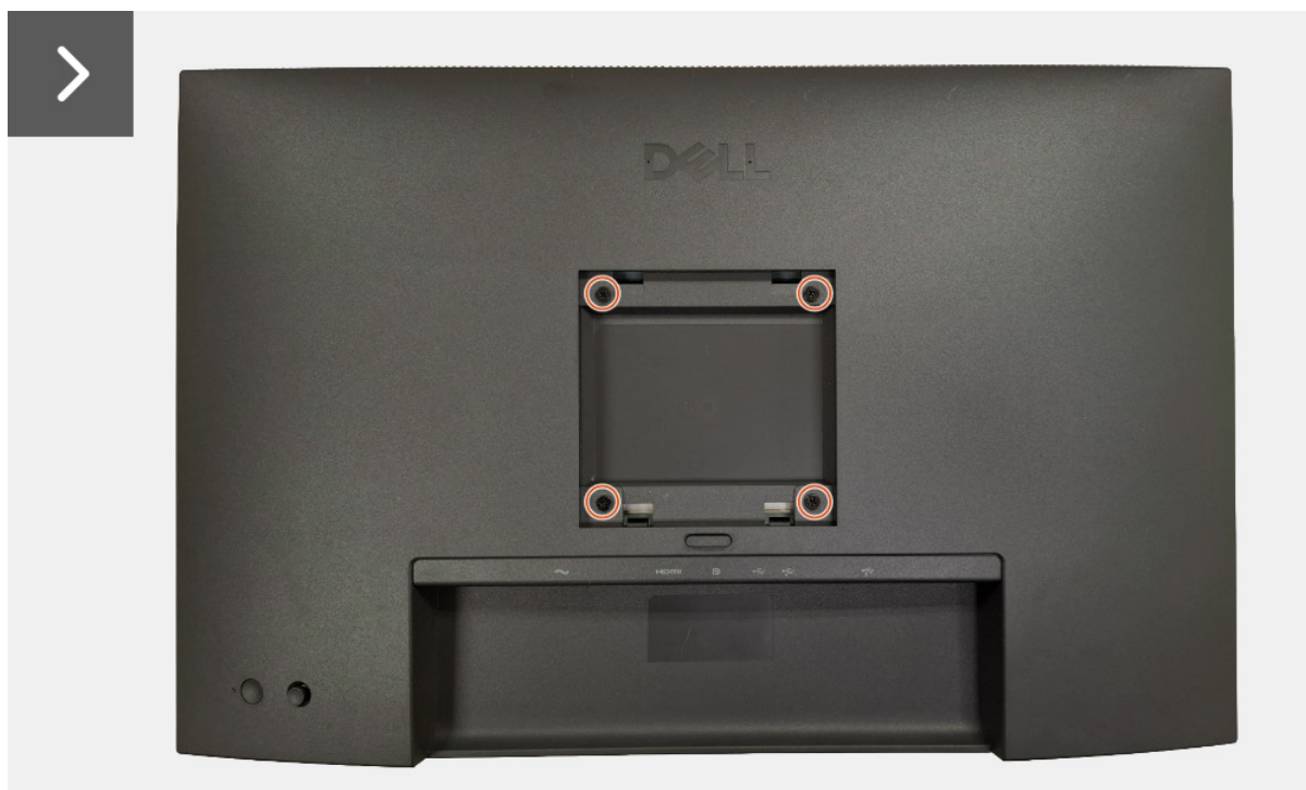
Figura 3. Retirar la cubierta posterior
