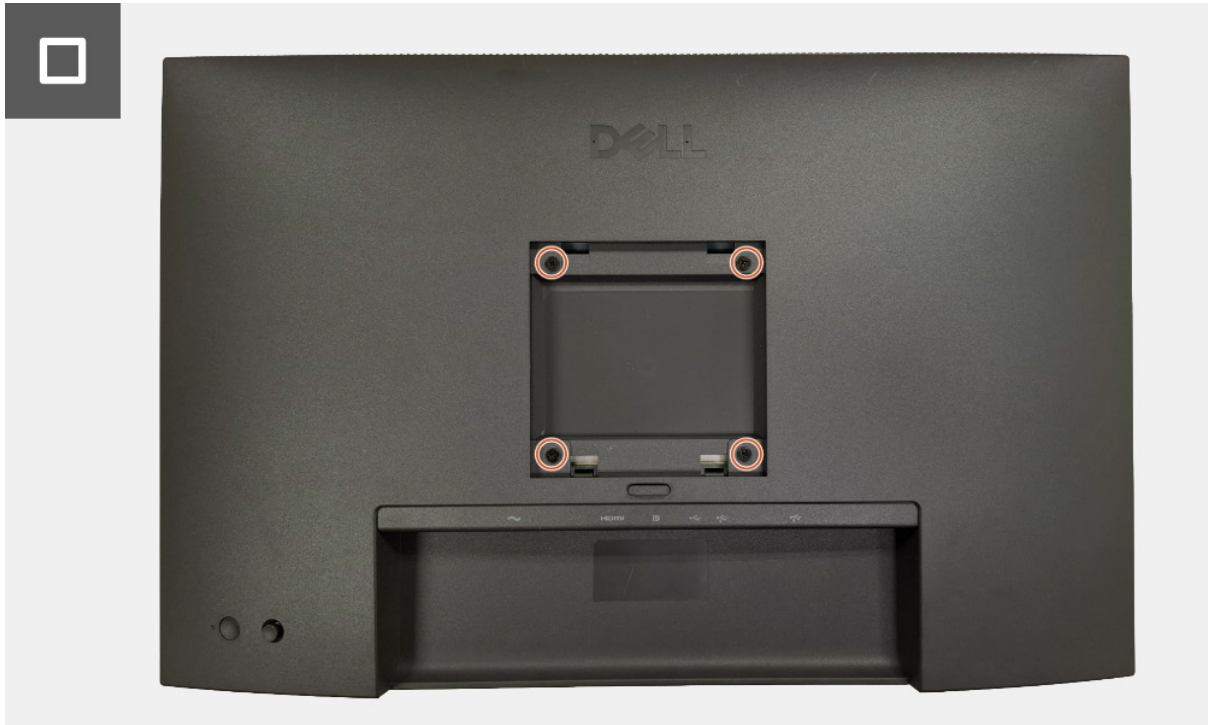
Figura 7. Instalar la cubierta posterior superior
