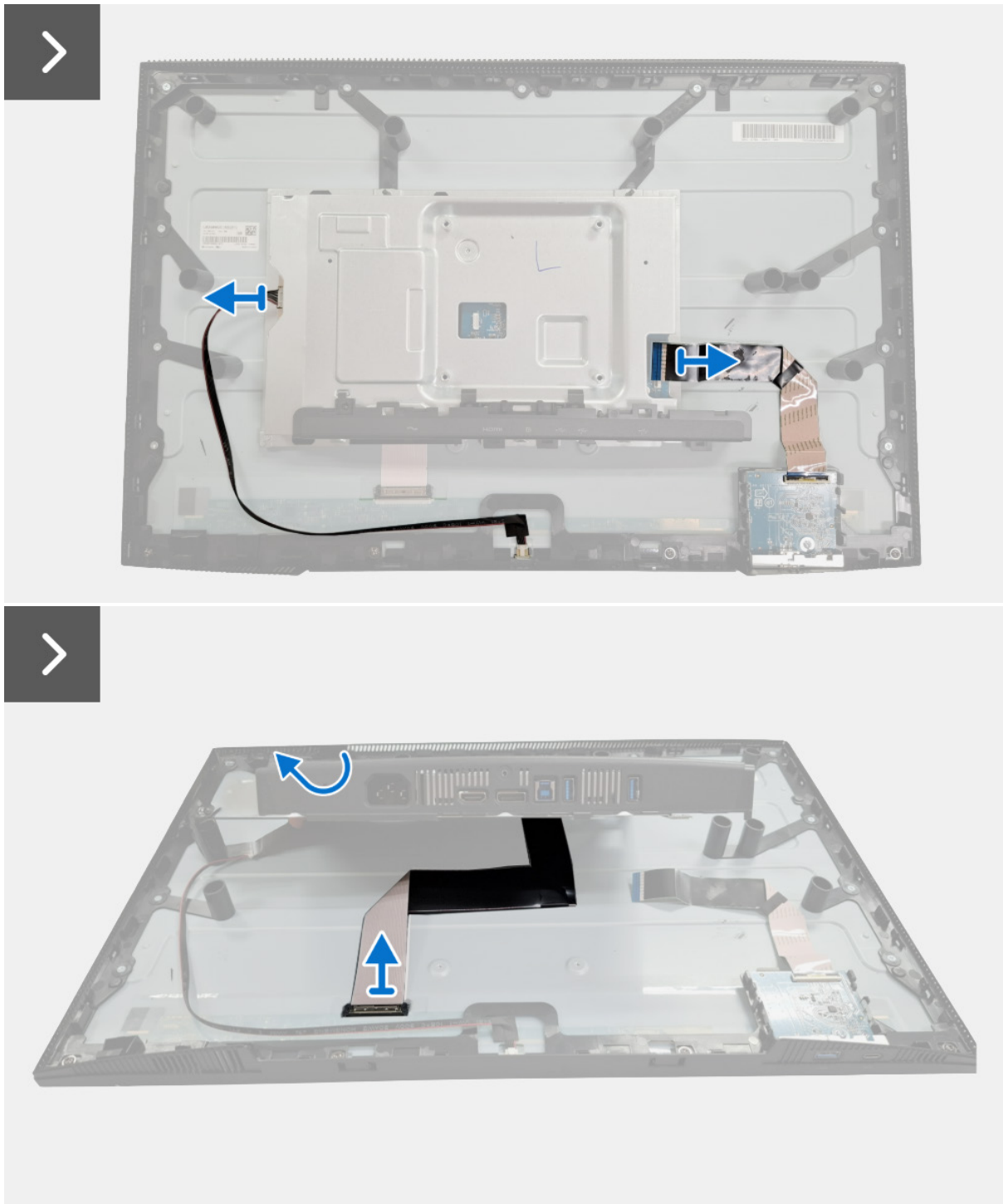
Figura 9. Retirar el protector metálico
