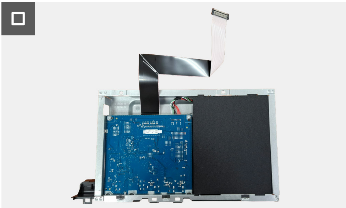
Rysunek 10. Demontaż metalowej osłony
