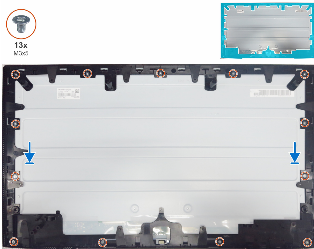
Figura 25. Instalación del marco central
