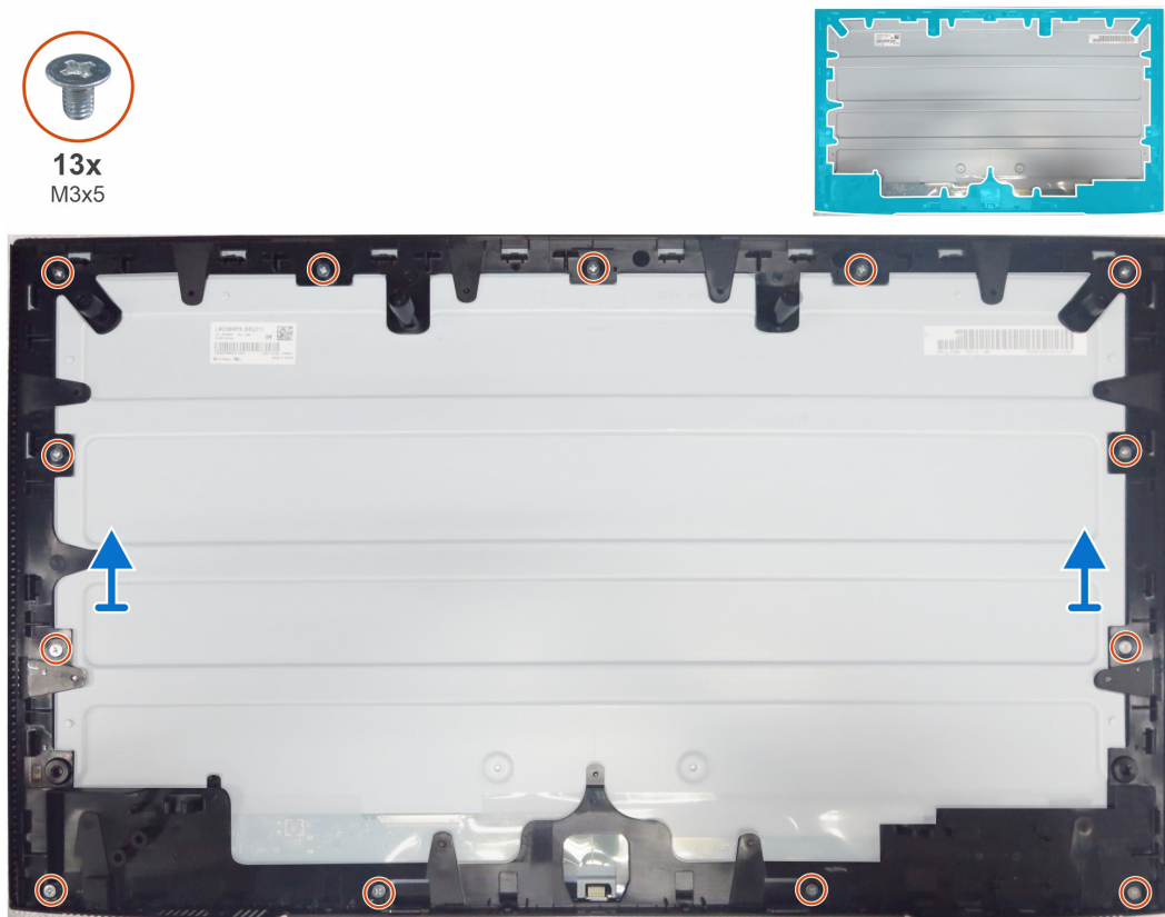
Figure 13. Retrait du cadre intermédiaire
