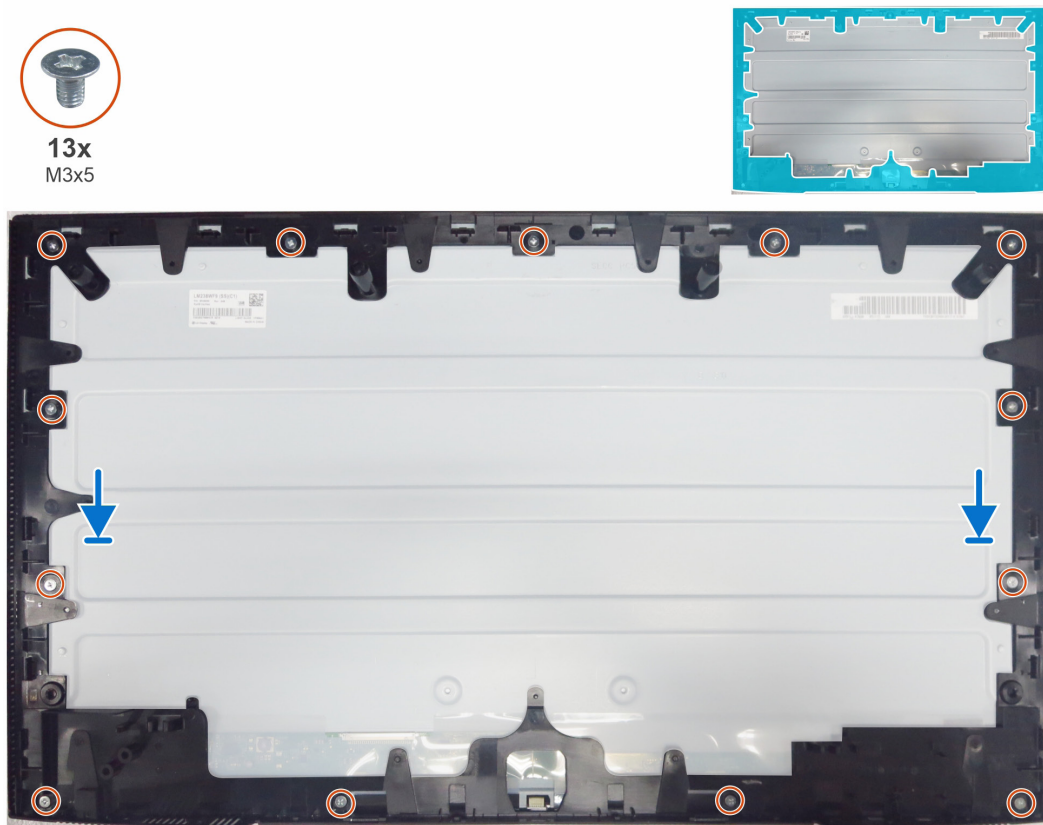
Figure 14. Installation du cadre intermédiaire
