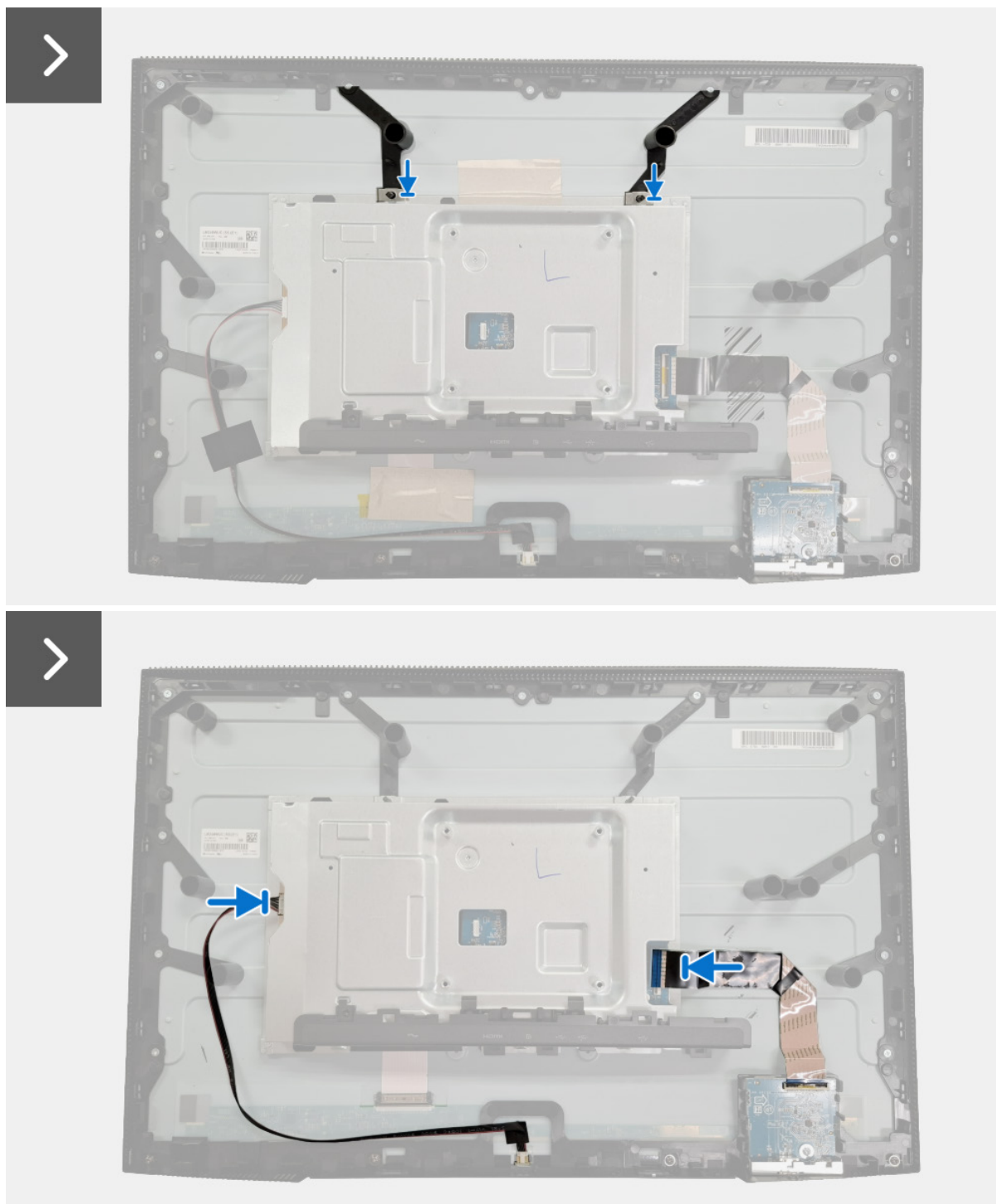
Obrázek 22. Instalace kovového štítu
