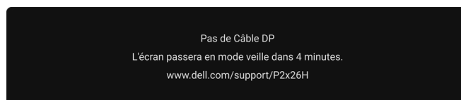
Figure 79. Message d'avertissement de câble de signal déconnecté
