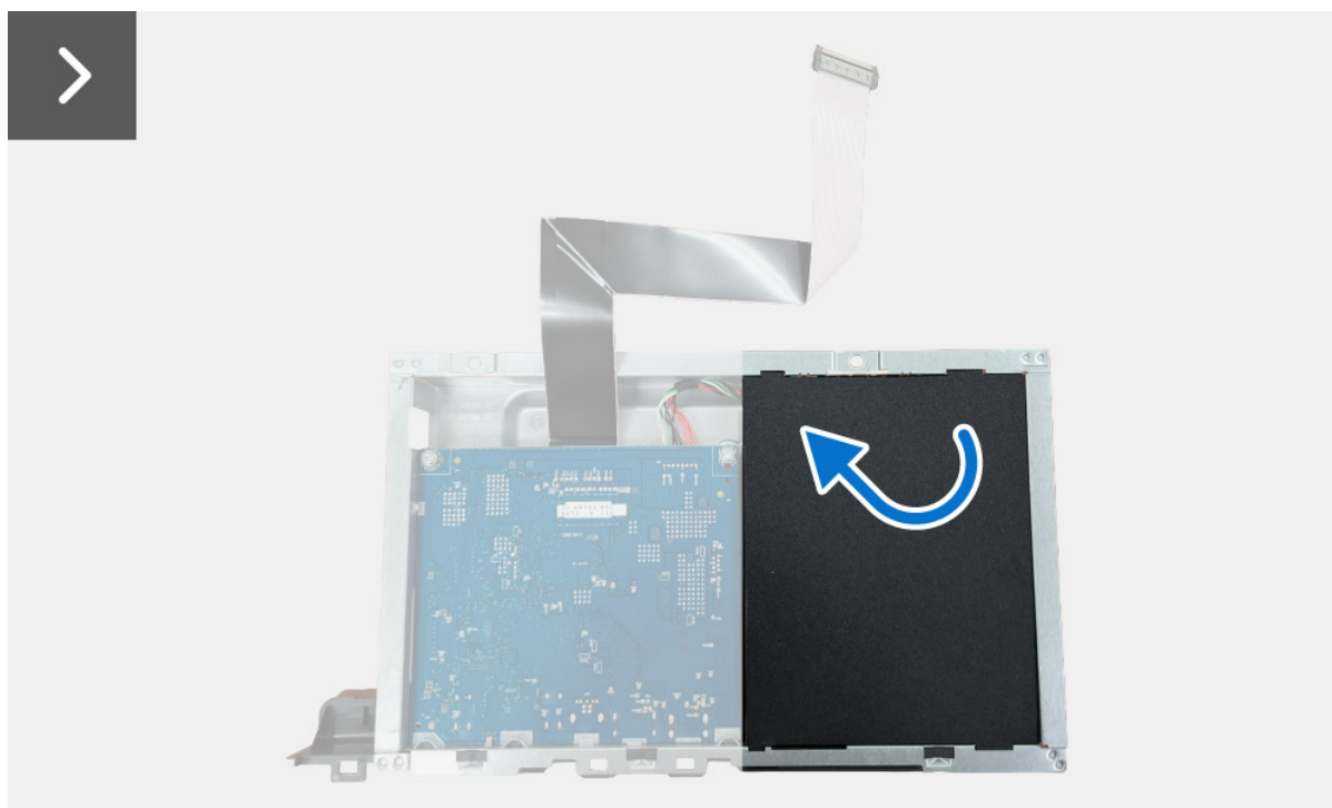
Figure 14. Retirer la carte d'alimentation
