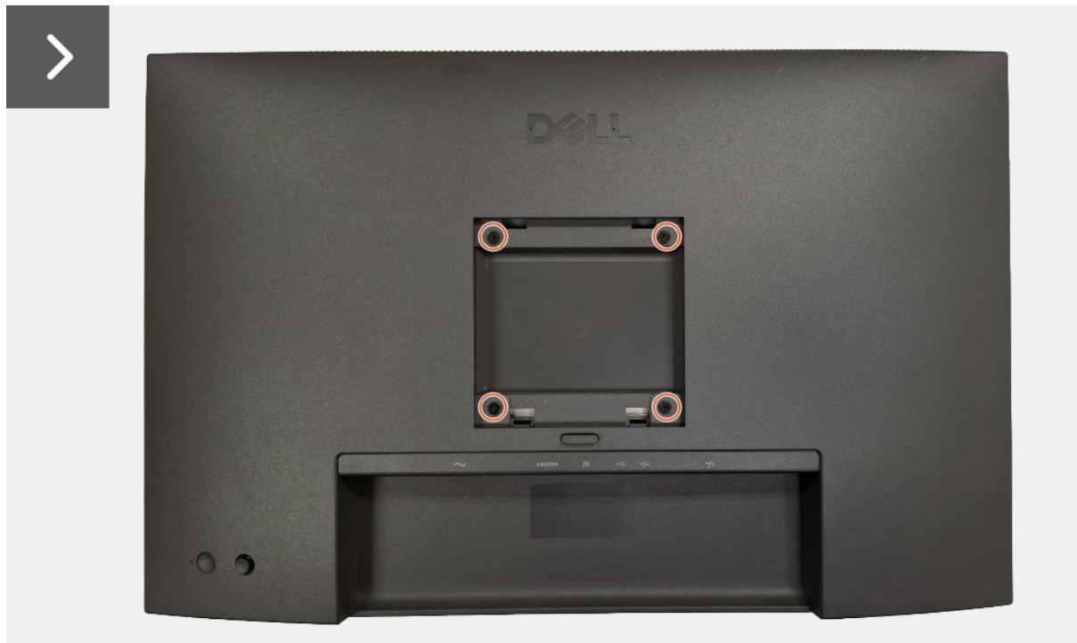
Figure 13. Retirer le couvercle arrière
