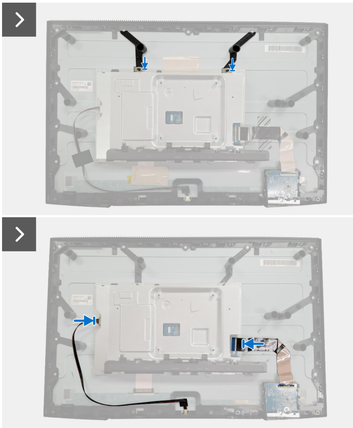
Figure 22. Installer le blindage métallique
