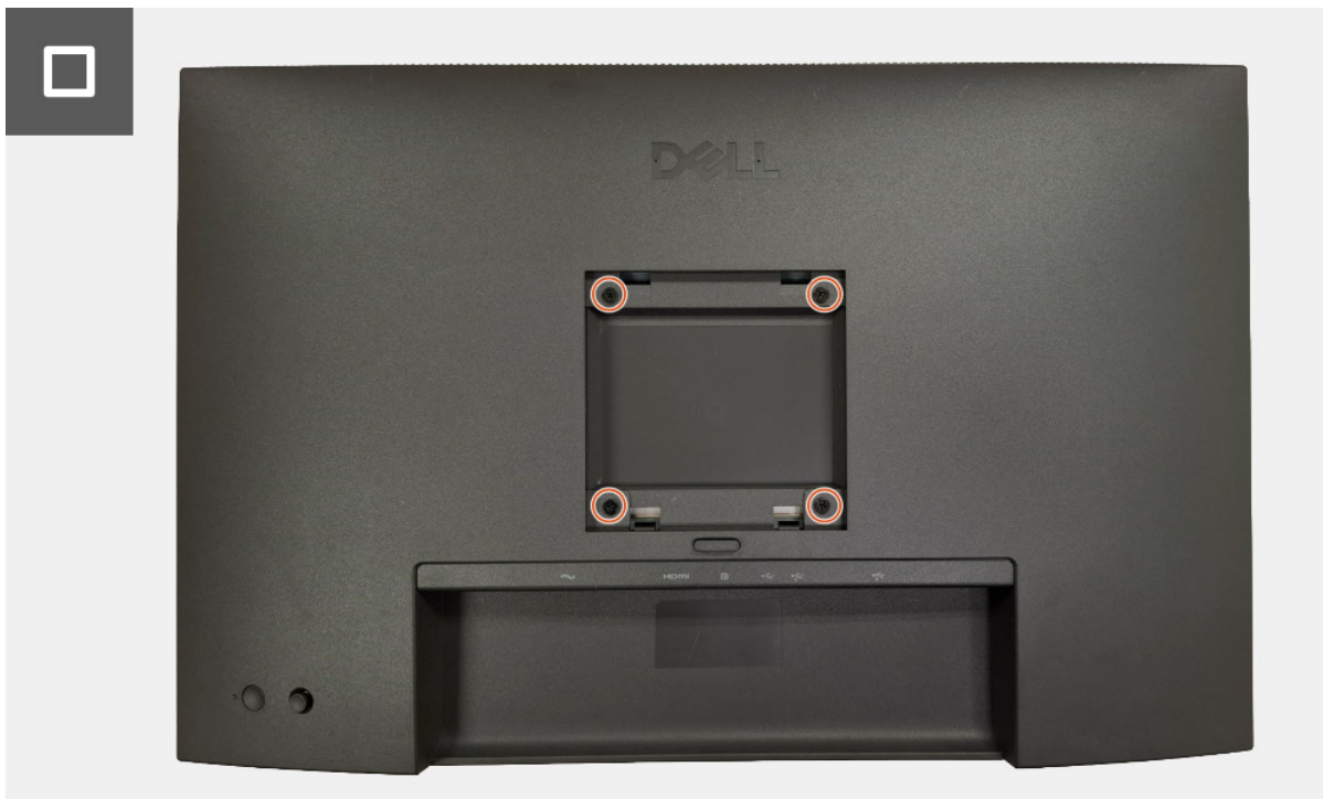
Figure 17. Installer le couvercle arrière supérieur
