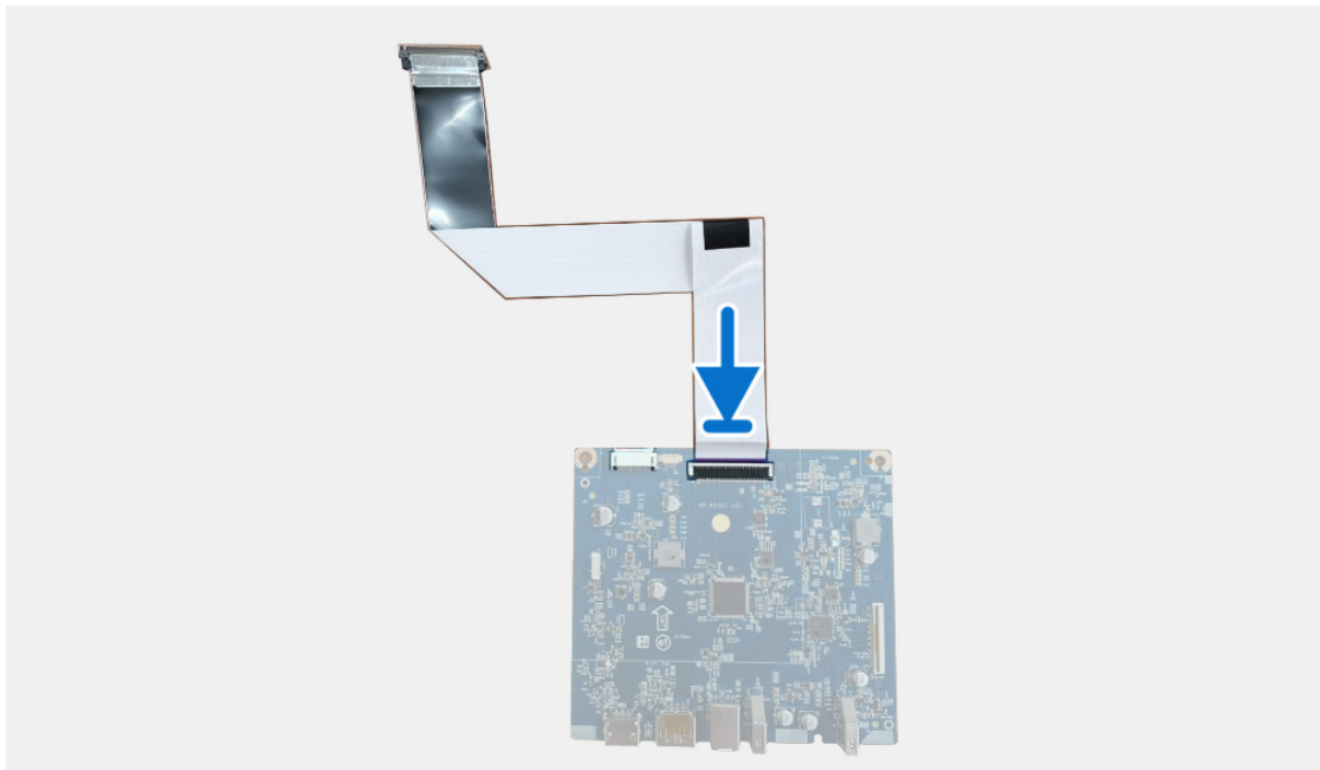
Figure 31. Installer la carte d'interface
