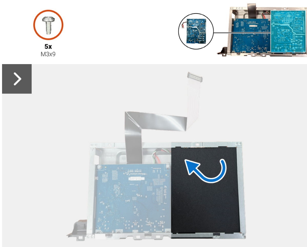
Figure 24. Retirer la carte d'alimentation
