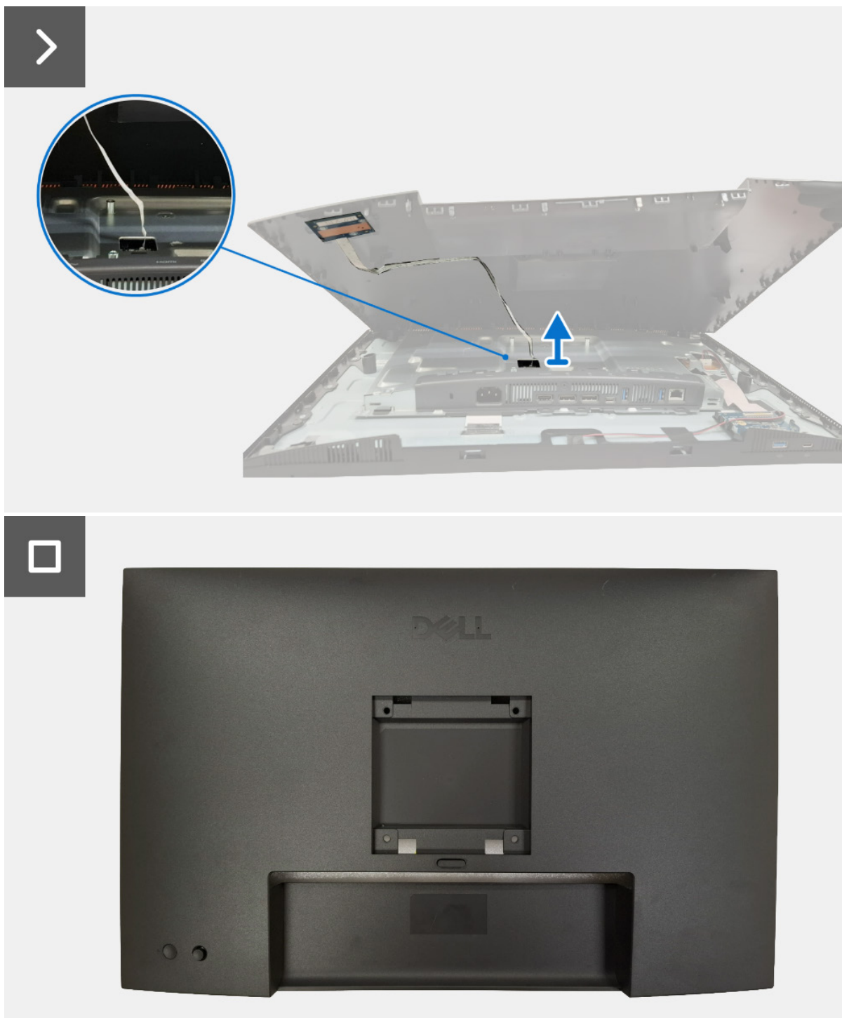
Figura 15. Retirar la cubierta posterior
