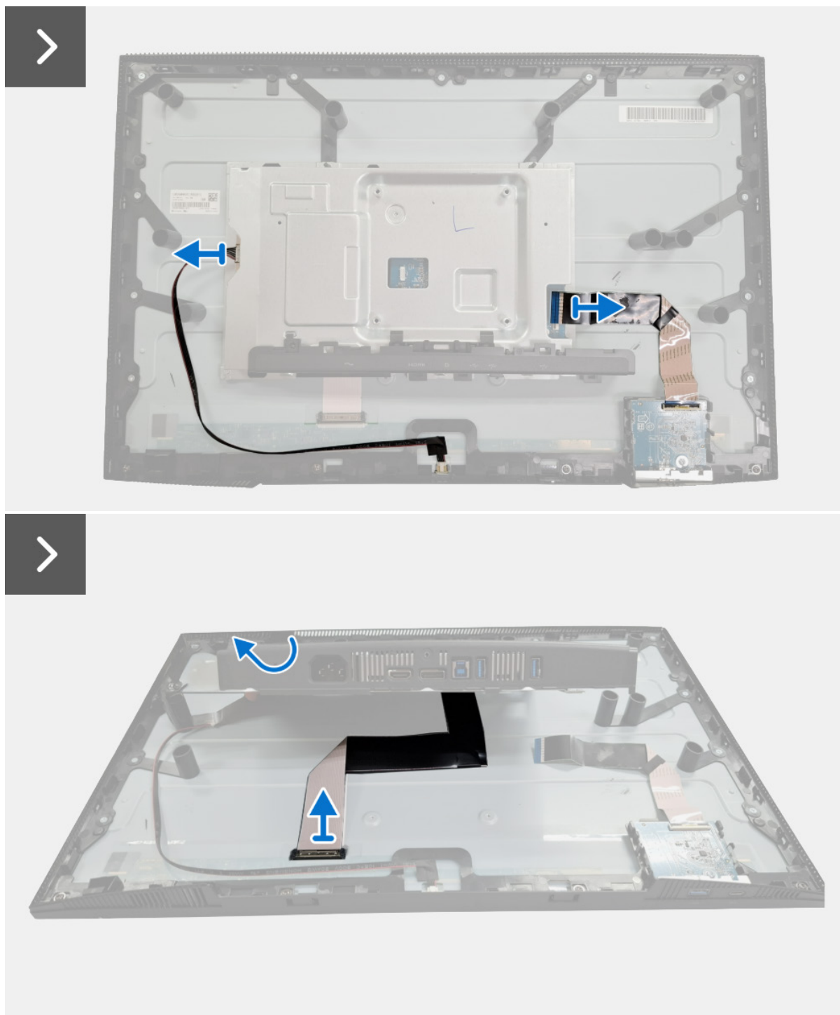
Figura 19. Retirar el protector metálico
