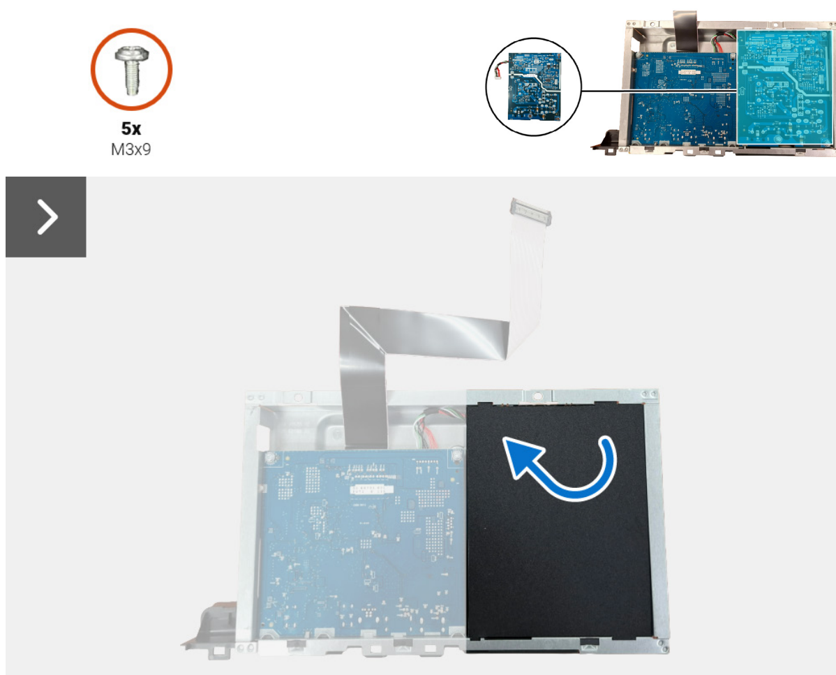
Figura 24. Retirar la placa de alimentación
