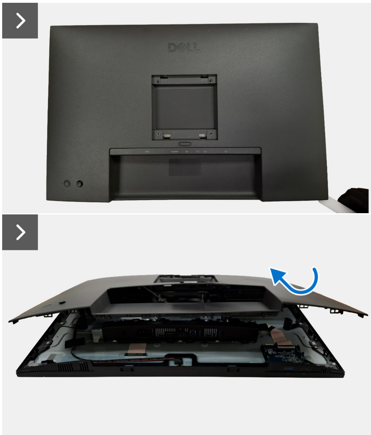
Figura 14. Retirar la cubierta posterior
