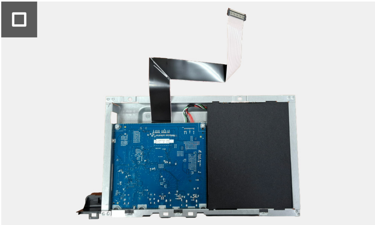
Figura 20. Retirar el protector metálico
