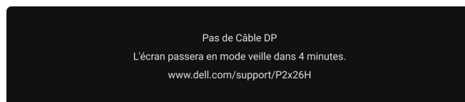
Figure 75. Message d'avertissement de câble de signal déconnecté
