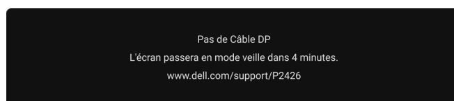
Figure 80. Message d'avertissement de câble de signal déconnecté
