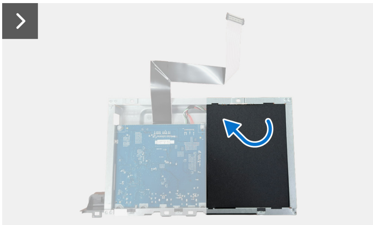
Figure 24. Retirer la carte d'alimentation
