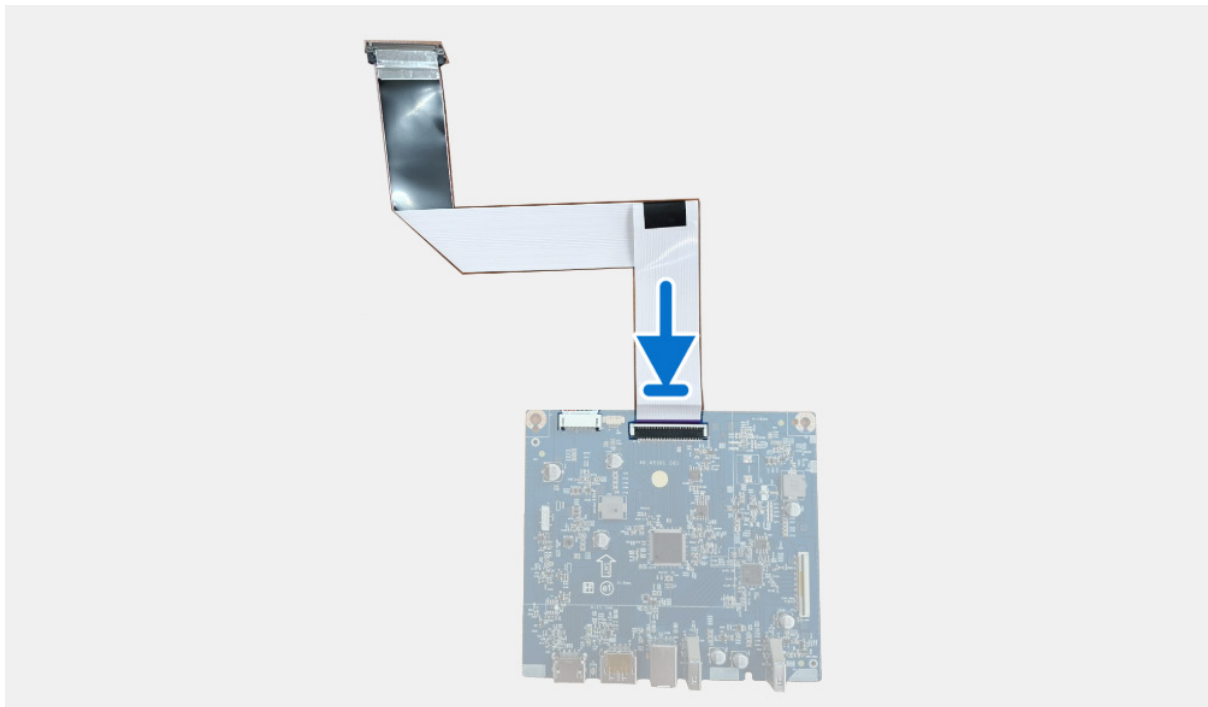
Figure 31. Installer la carte d'interface
