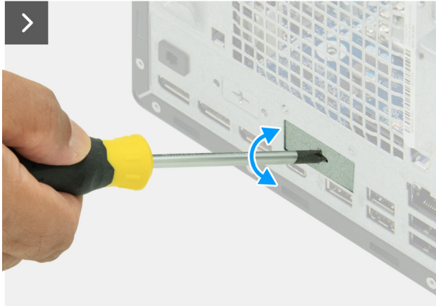
Ilustración 76. Instalación del módulo de puerto opcional
