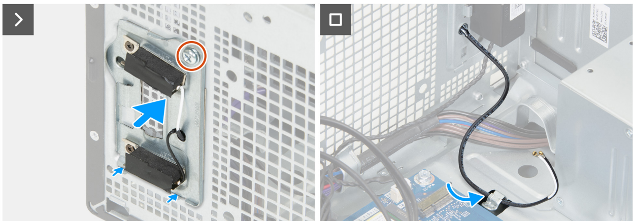
Ilustración 87. Instalación de los módulos de la antena
