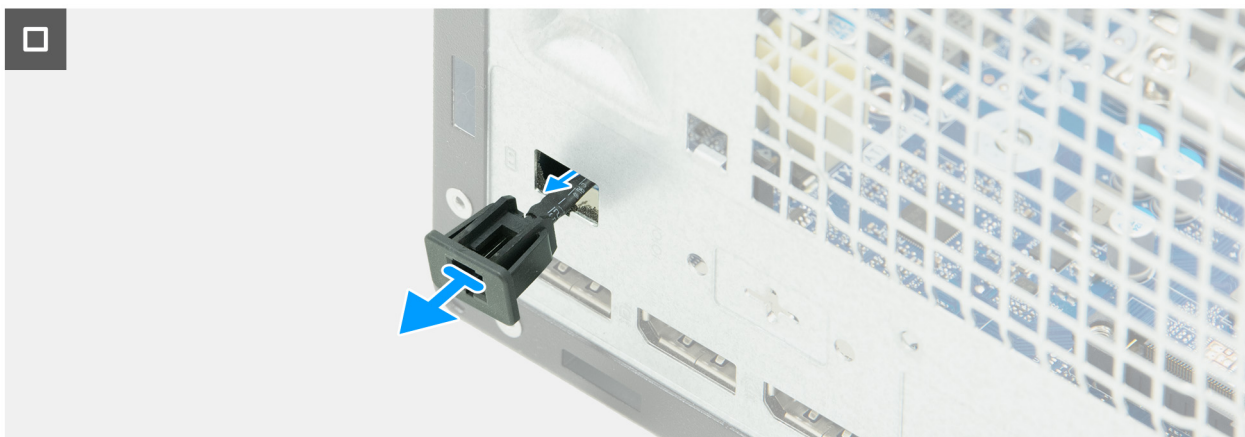
Ilustración 70. Extracción del cable del switch de alimentación remota
