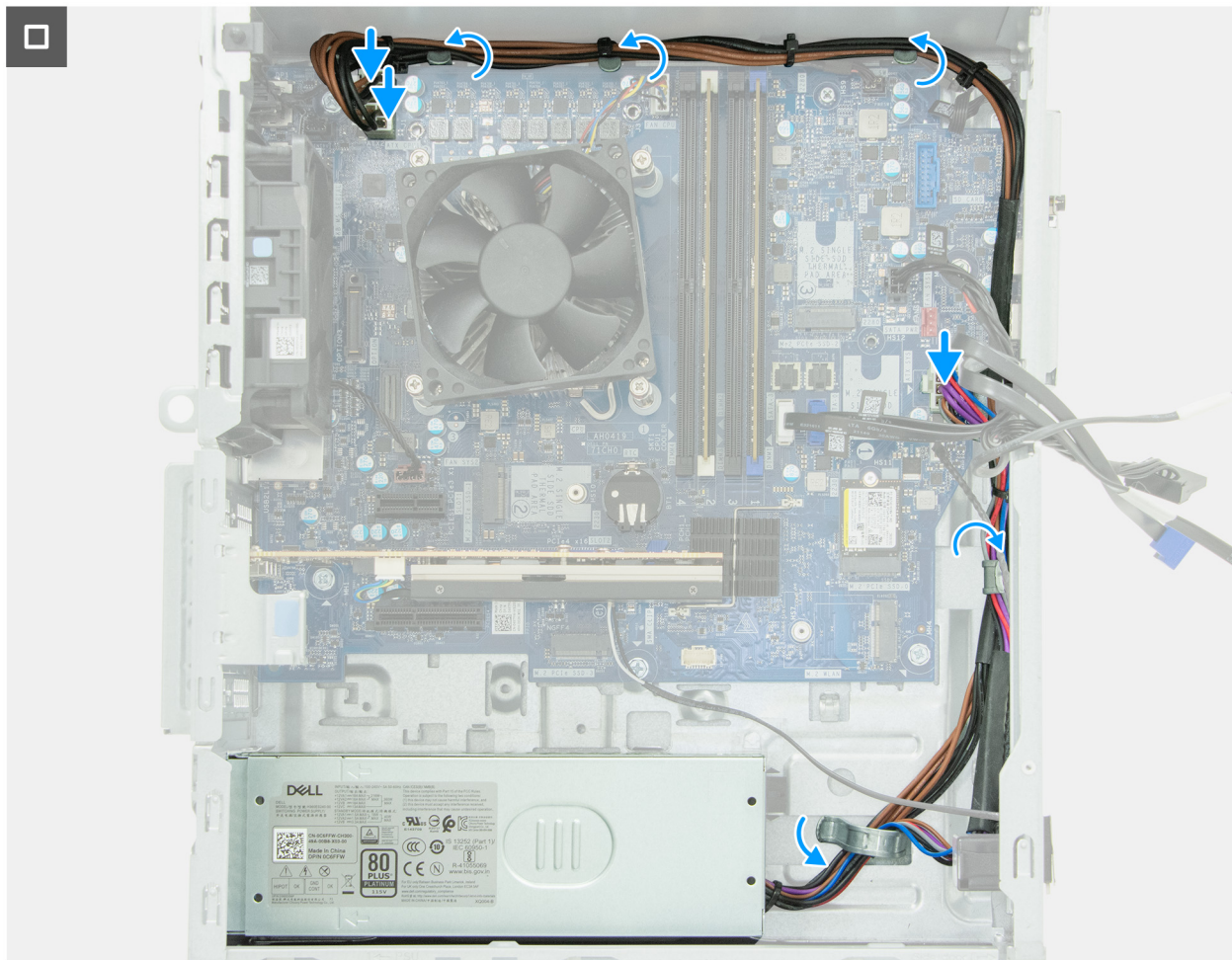
Ilustración 91. Instalación de la fuente de alimentación
