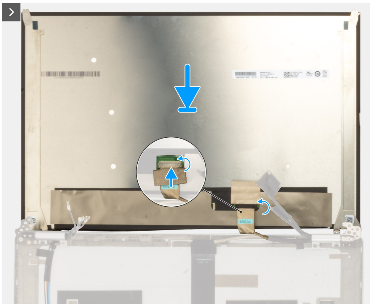
Figure 72. Installation du panneau d'écran
