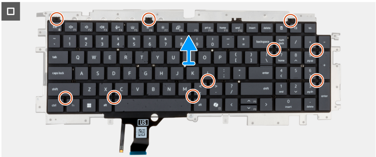
Figure 85. Retrait du clavier
