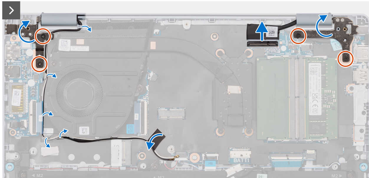
Abbildung 51. Entfernen der Bildschirmbaugruppe
