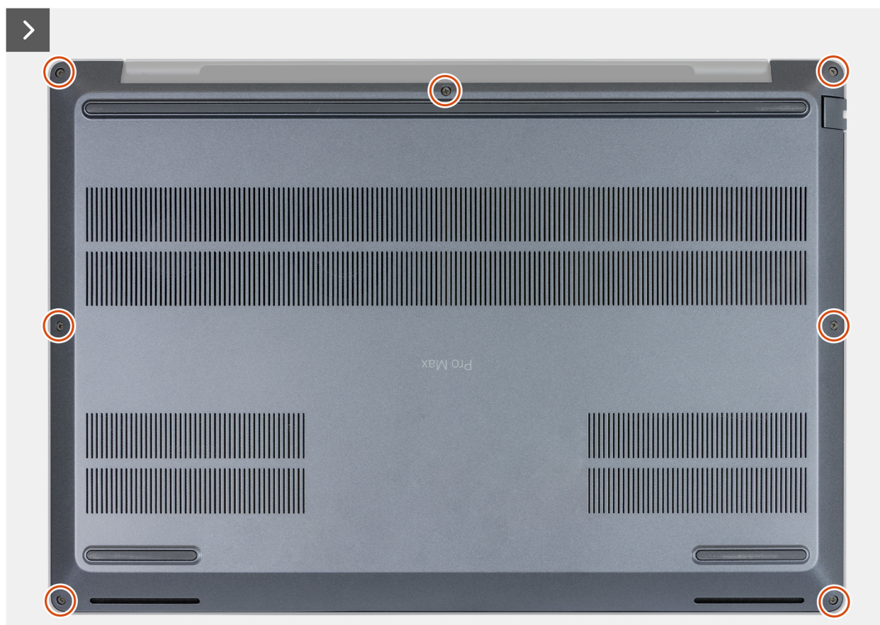
Ilustración 24. Cómo aflojar los tornillos cautivos
