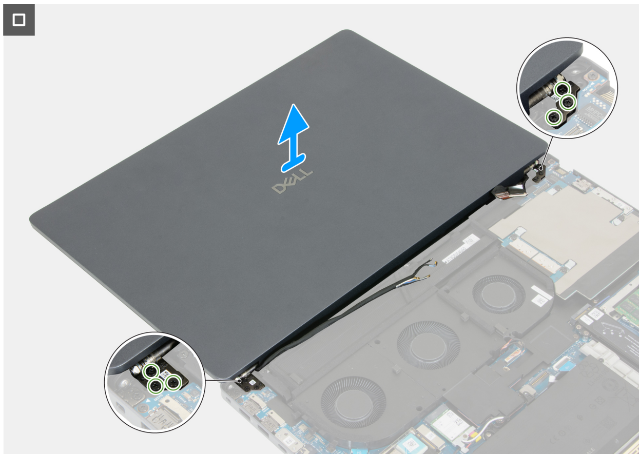
Ilustración 64. Extracción del ensamblaje de la pantalla
