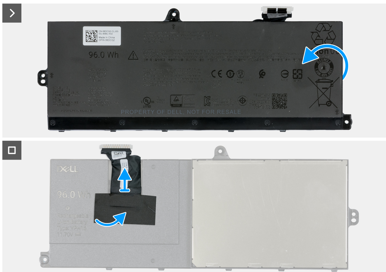
Ilustración 45. Extracción del cable de la batería de la batería
