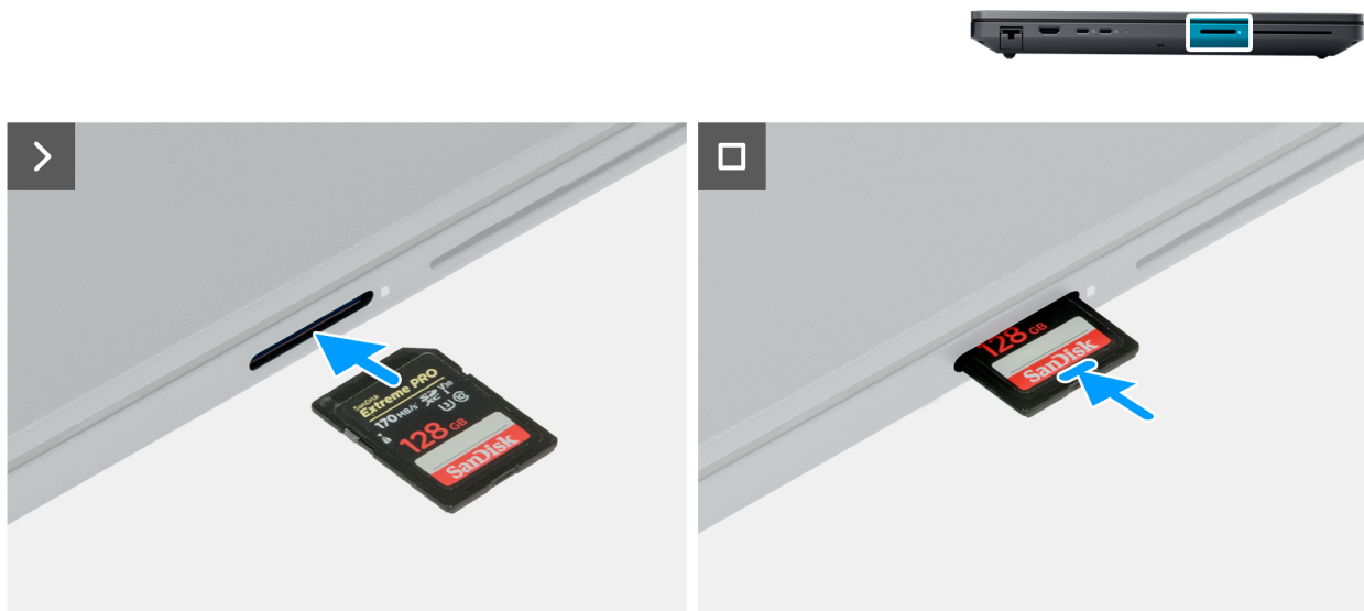
Ilustración 11. Instalación de la tarjeta SD
