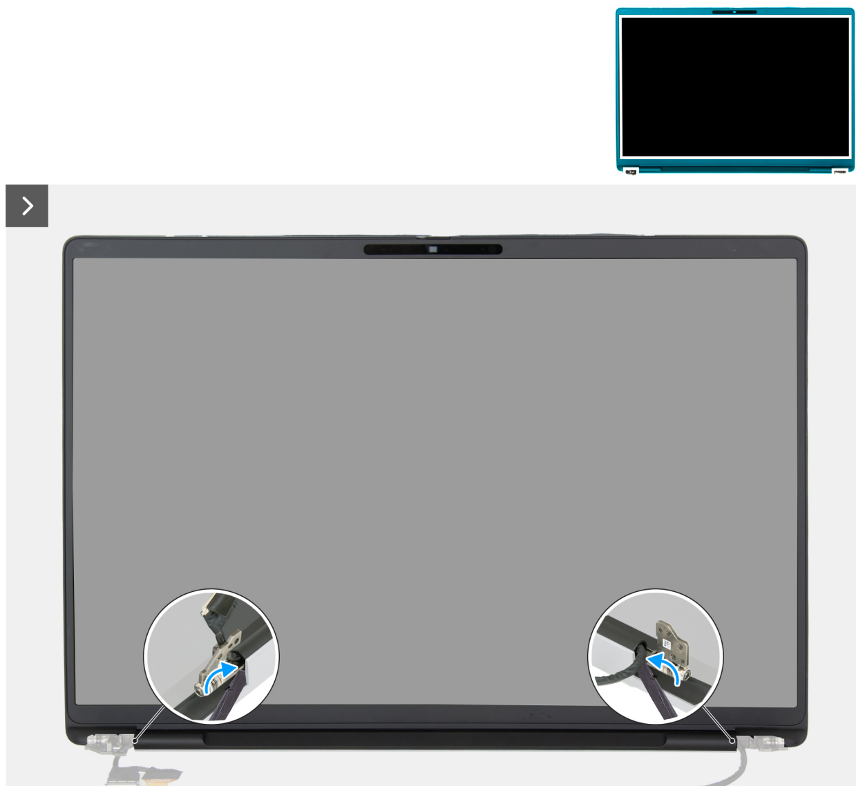
Ilustración 83. Extracción del embellecedor de la pantalla
