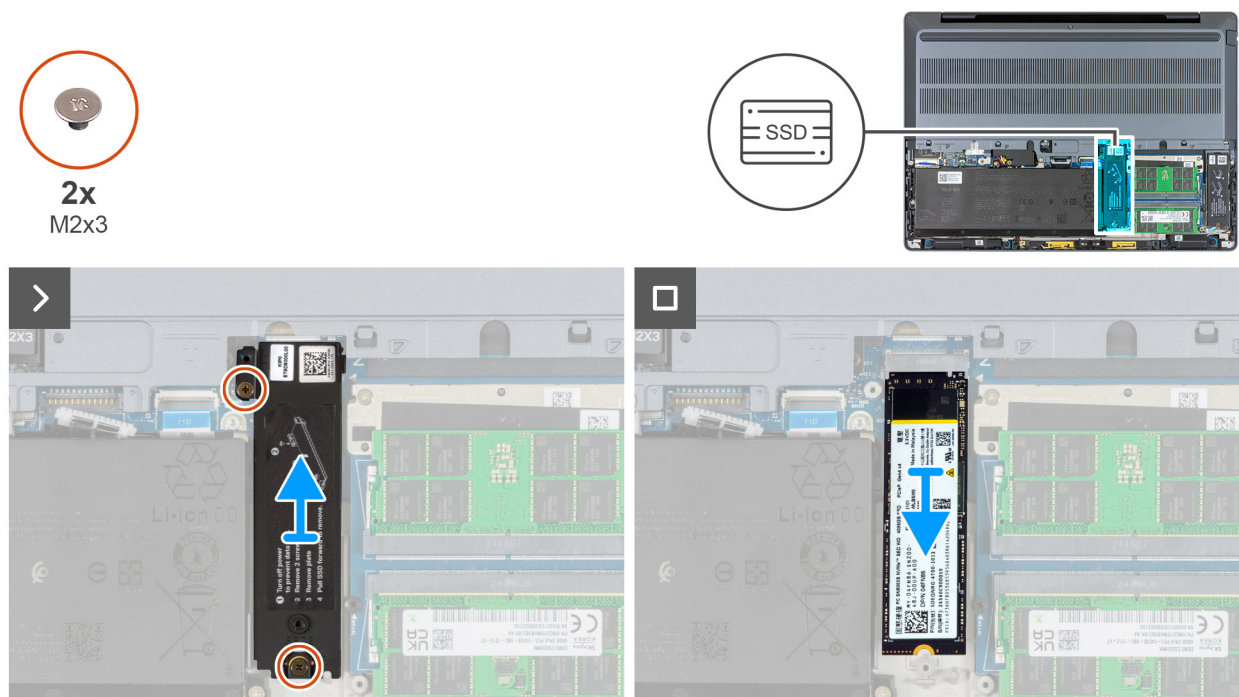
Ilustración 38. Extracción de la SSD M.2 2280 de la ranura 2 (SSD2)
