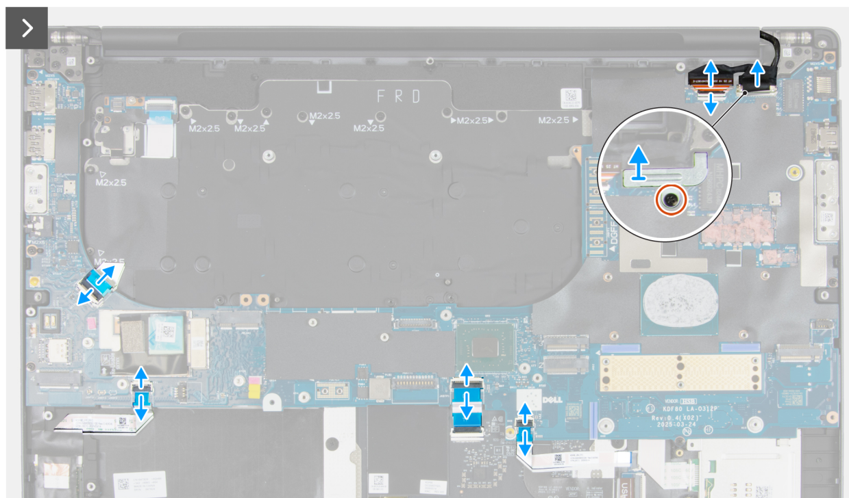
Ilustración 107. Extracción de la tarjeta madre
