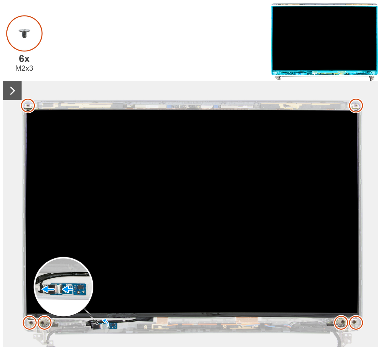
Ilustración 95. Extracción del panel de pantalla
