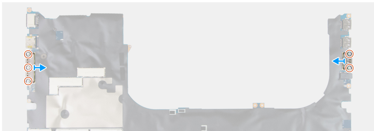
Ilustración 113. Extracción del módulo del conector USB Type-C
