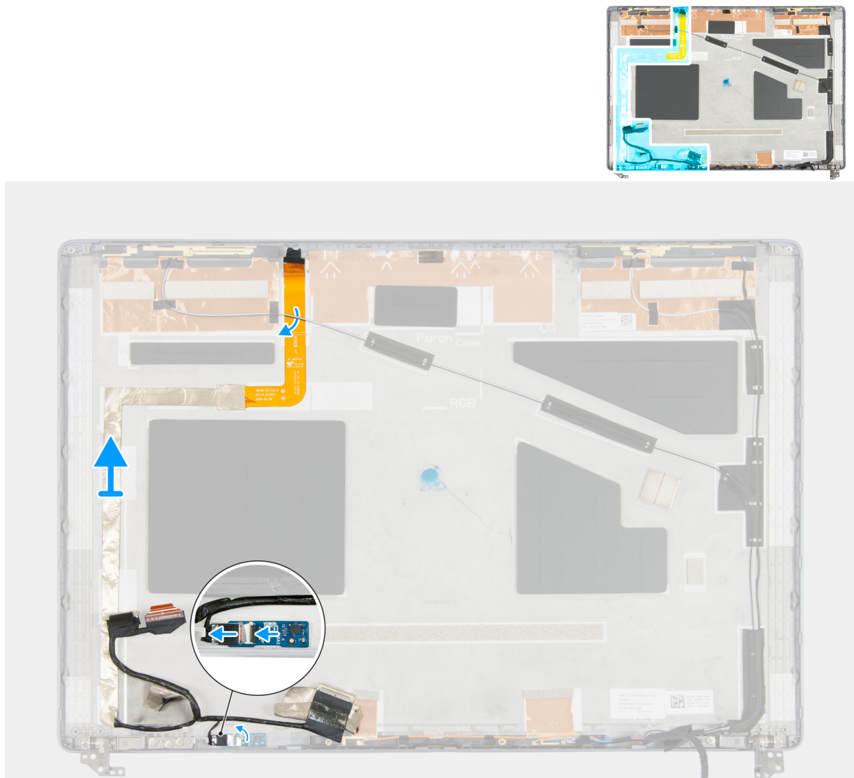
Ilustración 107. Extracción del cable de pantalla
