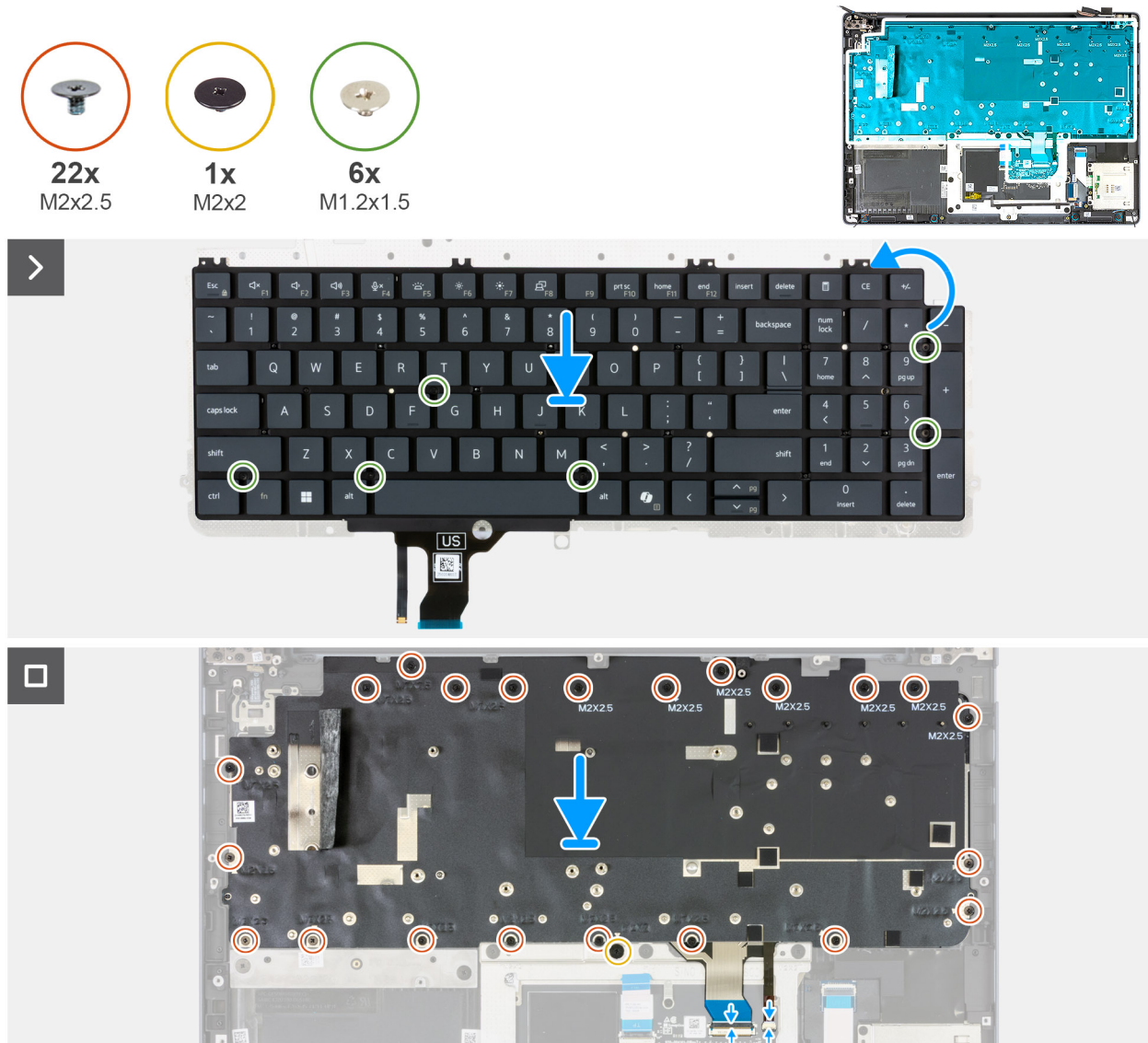
Ilustración 123. Instalación del teclado
