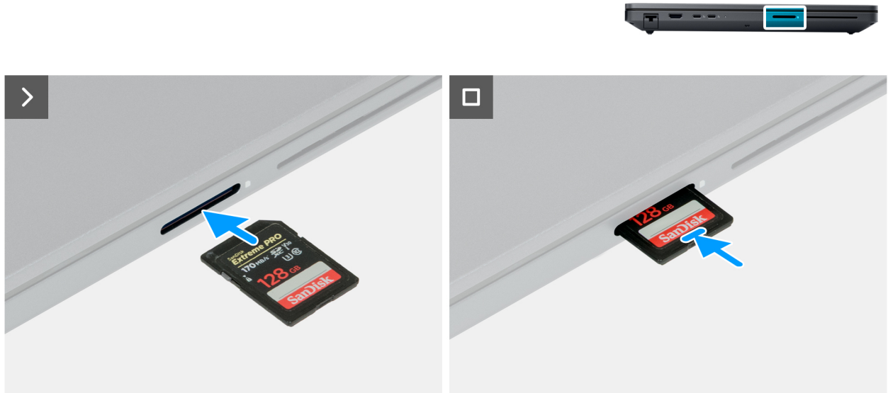
Ilustración 11. Instalación de la tarjeta SD
