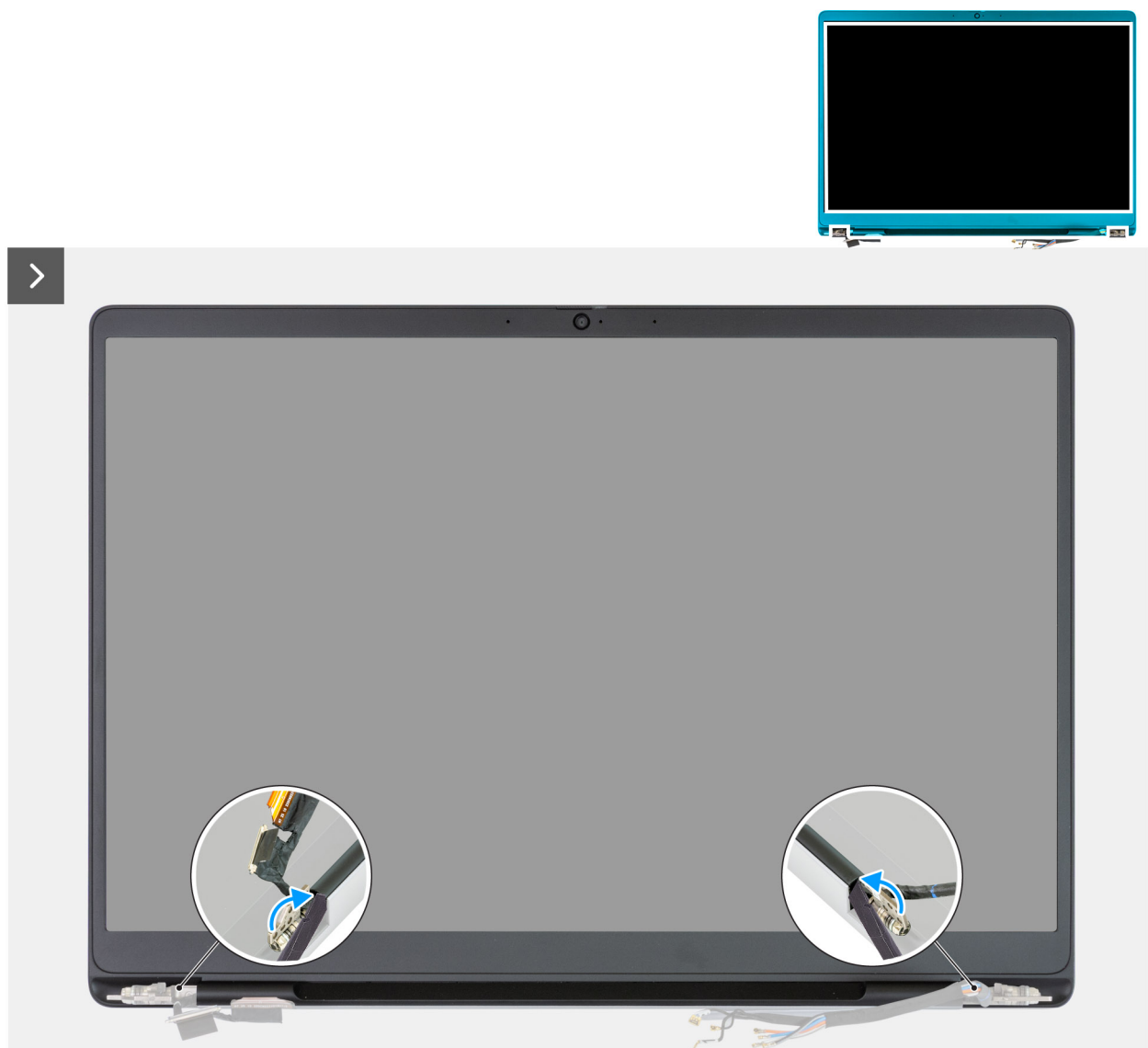
Ilustración 86. Extracción del embellecedor de la pantalla
