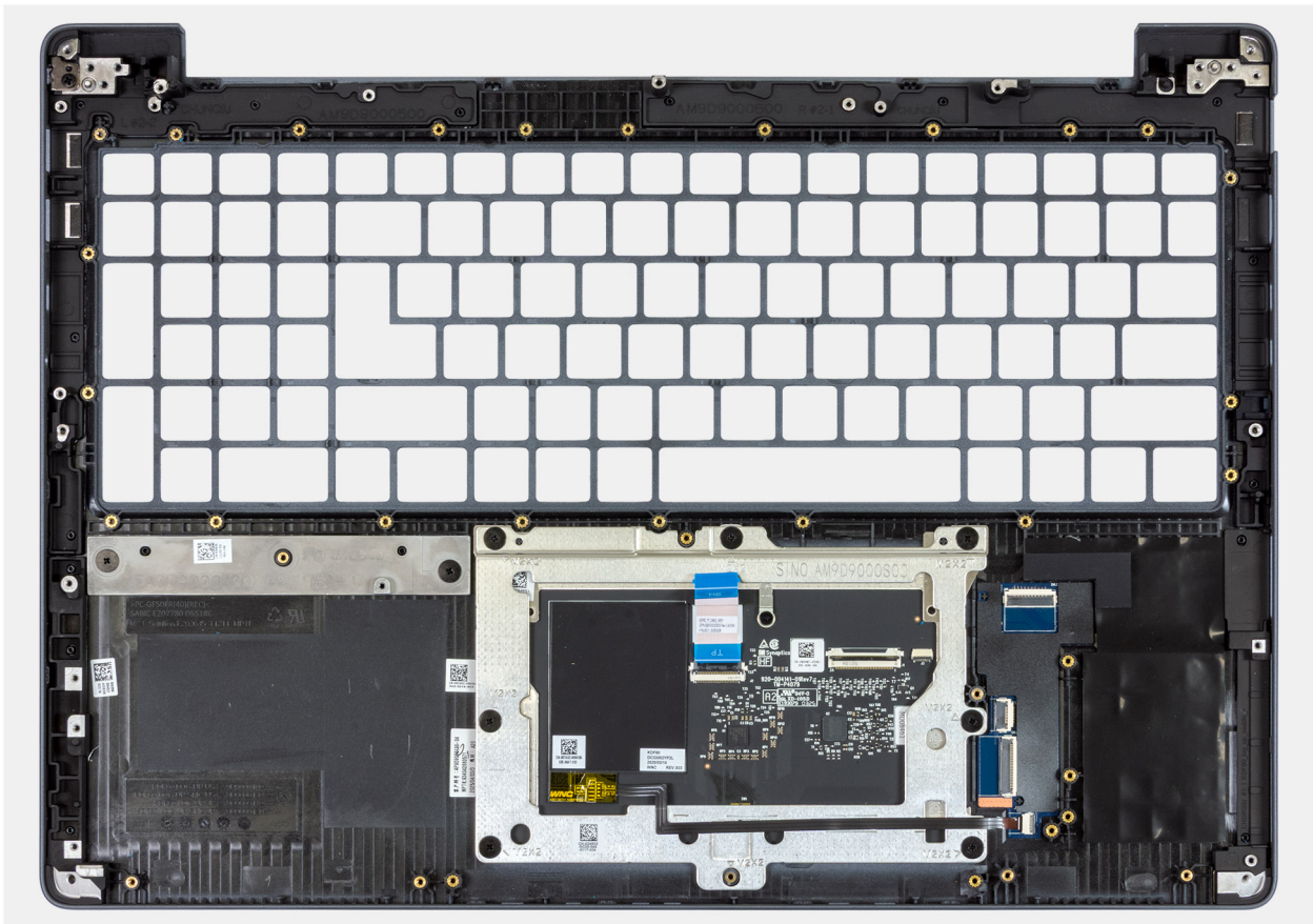
Ilustración 132. Ensamblaje del reposamanos
