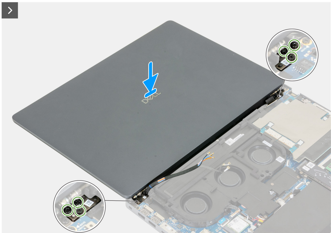
Ilustración 68. Instalación del ensamblaje de la pantalla
