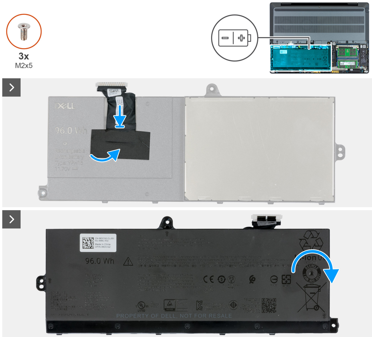
Ilustración 42. Reemplazo del cable de la batería
