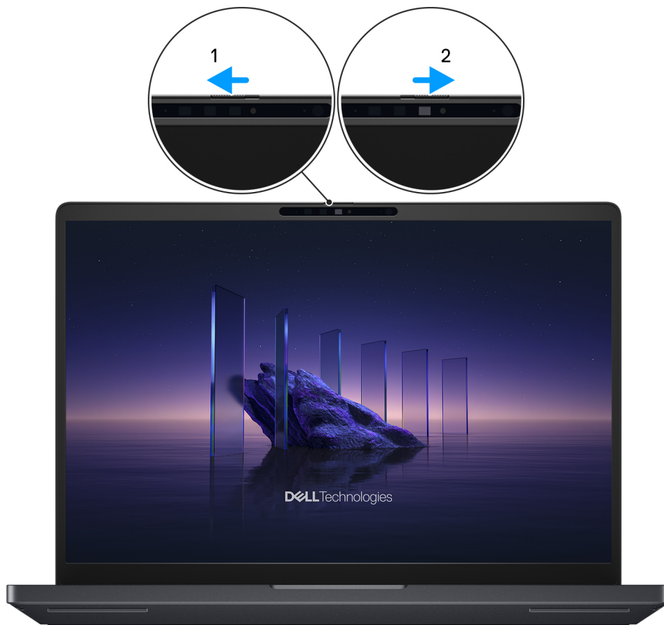
Ilustración 8. Obturador de la cámara
