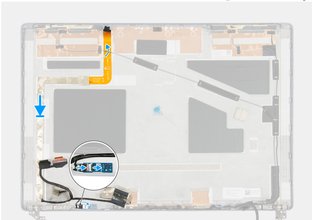
Ilustración 108. Instalación del cable de pantalla
