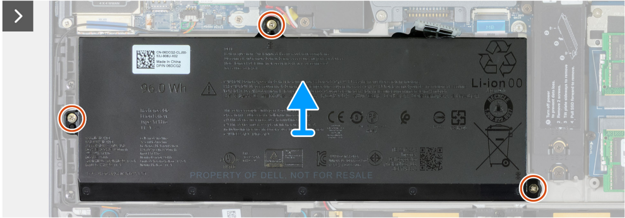
Ilustración 40. Extracción de la batería
