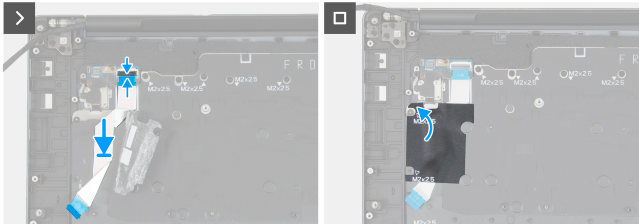
Ilustración 127. Instalación del cable de la placa del botón de encendido
