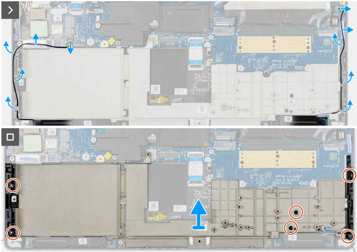
Ilustración 82. Extracción de la trama interna
