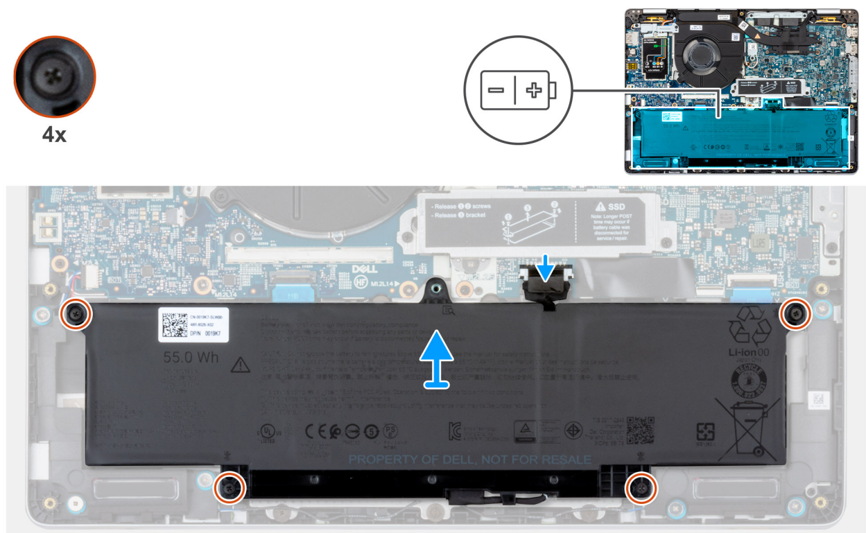
Figure 10. Installation de la batterie
