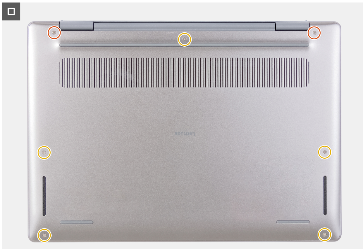
Figure 21. Serrage et remise en place des vis
