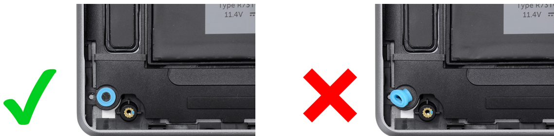
Figure 35. Installation des passe-câbles en caoutchouc
