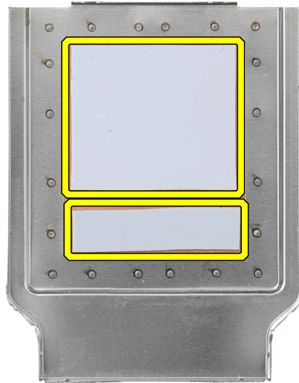
Figure 28. Tampons thermiques sur la partie inférieure de la protection thermique WWAN
