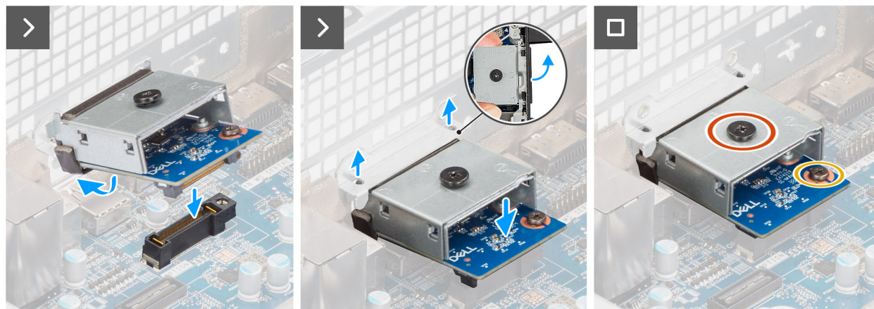
Ilustración 63. Instalación del módulo VGA opcional
