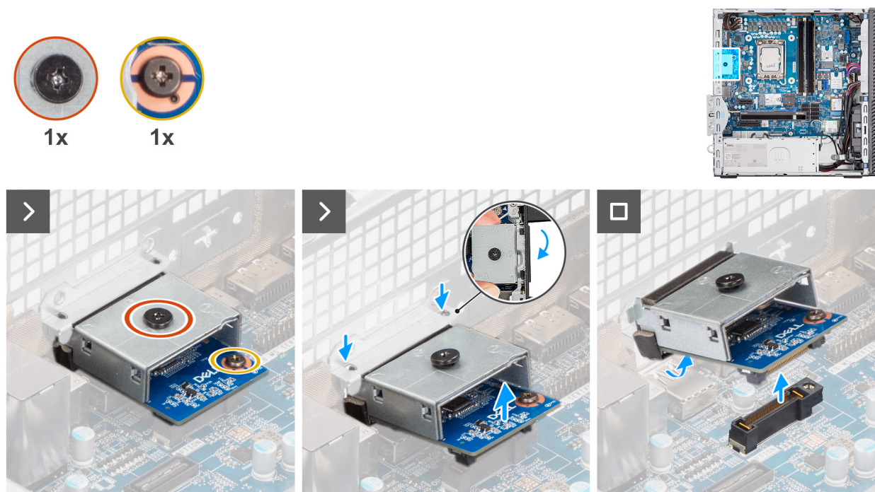
Ilustración 73. Extracción del módulo HDMI opcional
