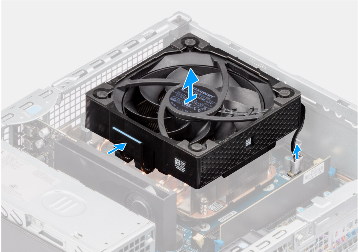
Ilustración 51. Extracción del ventilador del procesador
