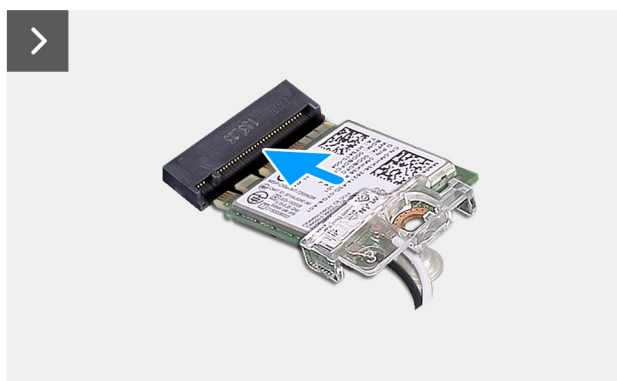
Ilustración 42. Instalación de la tarjeta inalámbrica
