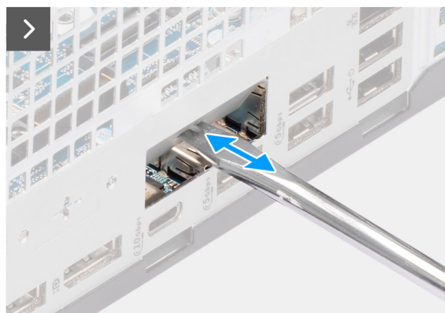
Ilustración 65. Instalación del módulo USB opcional
