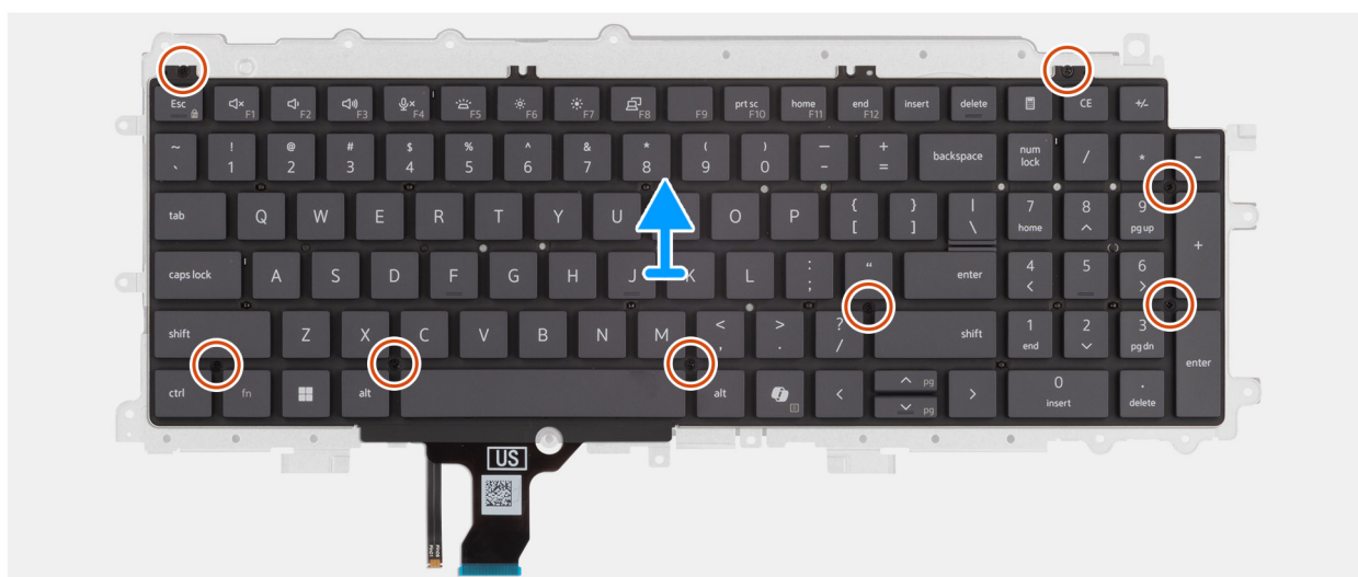
Afbeelding 56. De steunplaat van het toetsenbord verwijderen
