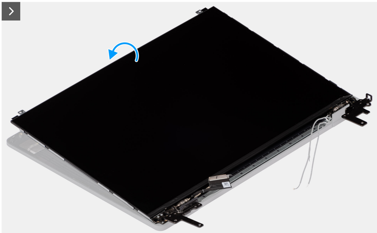
Afbeelding 80. De scharnieren van de beeldschermpaneel eenheid installeren
