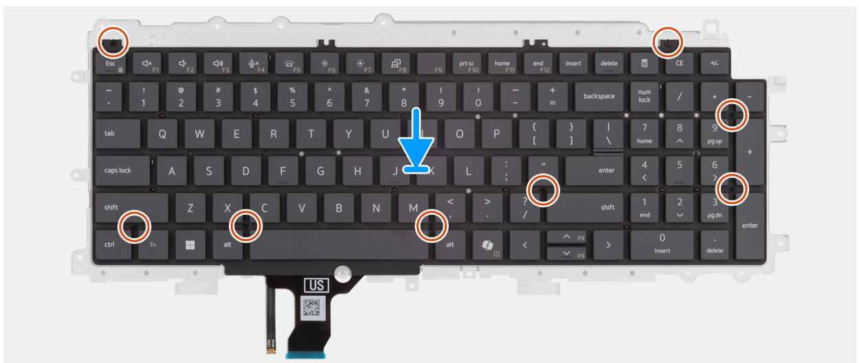
Afbeelding 59. De steunplaat van het toetsenbord installeren
