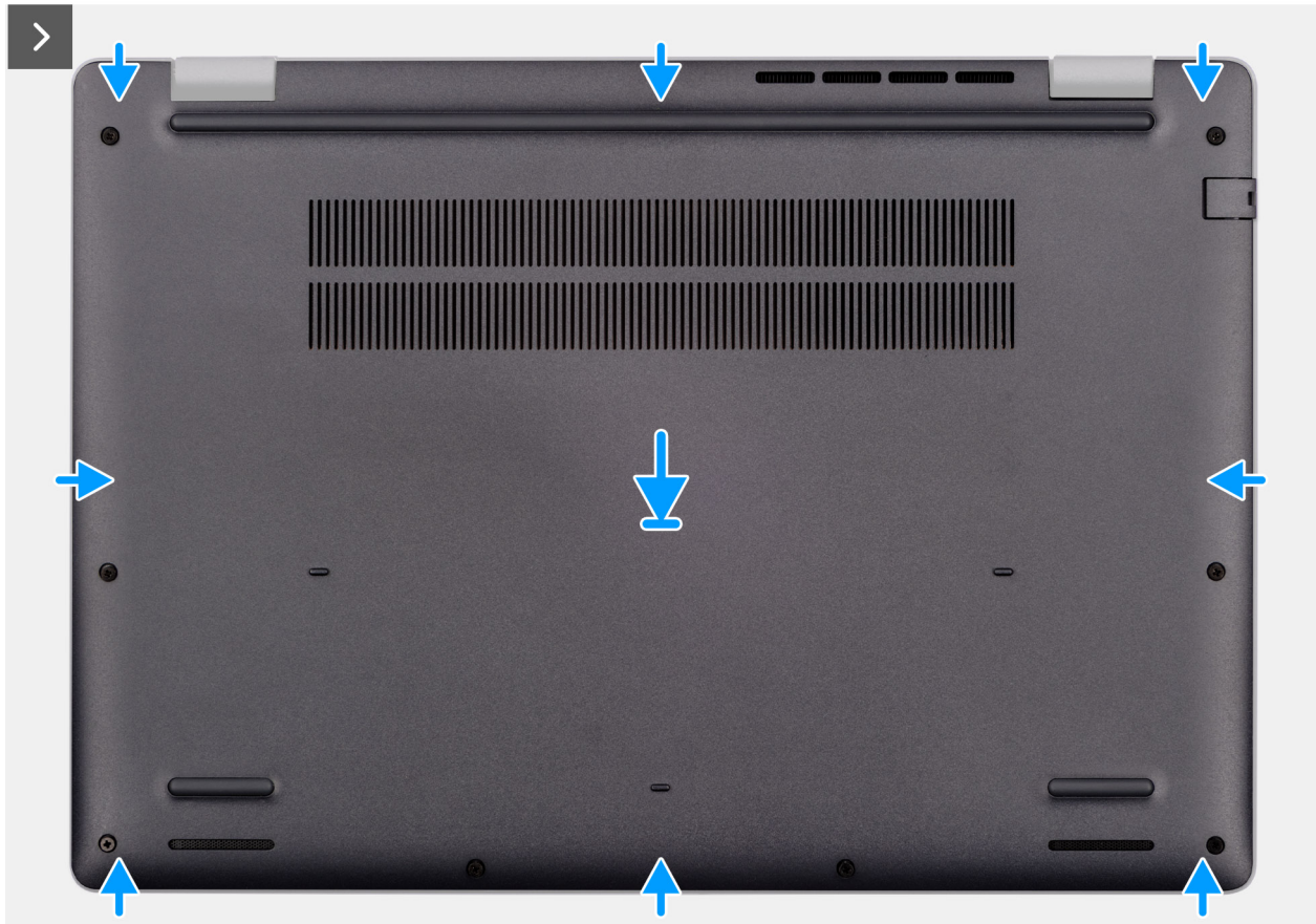
Afbeelding 15. De onderplaat installeren
