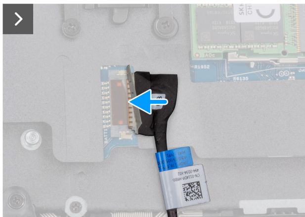
Afbeelding 18. De batterij installeren
