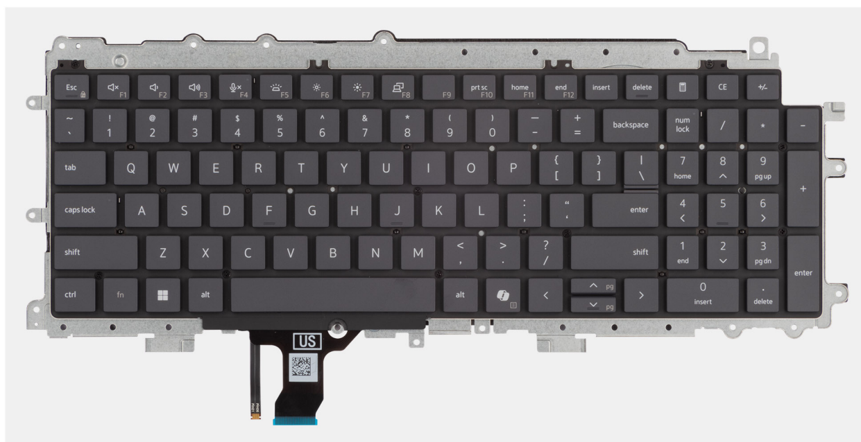
Afbeelding 52. Het toetsenbord verwijderen
