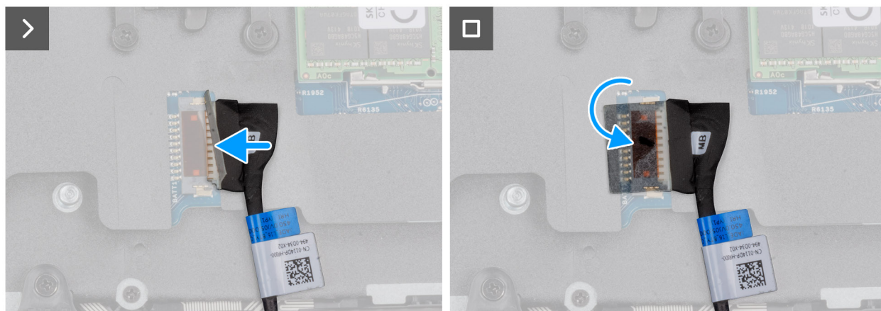
Afbeelding 14. De batterijkabel aansluiten
