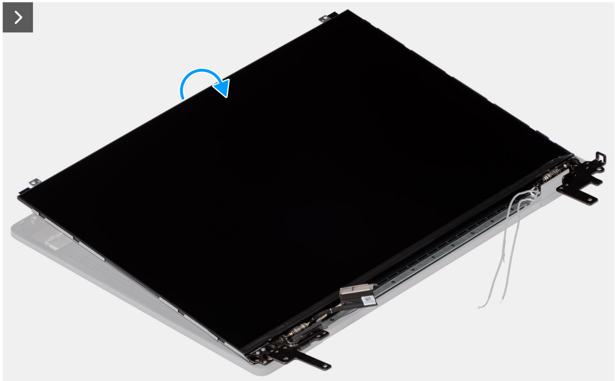
Afbeelding 75. De beeldschermpaneel eenheid verwijderen
